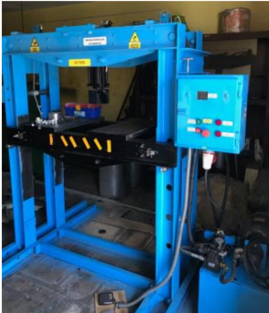
Figura 4.19 Prensa hidráulica implementada.
