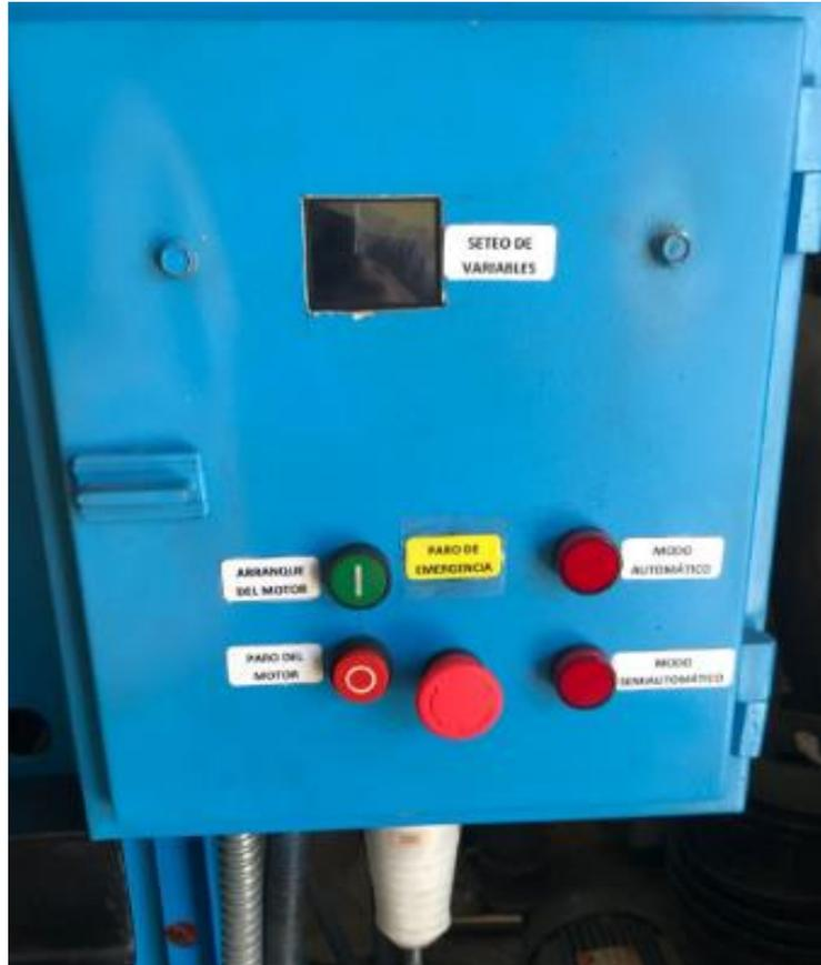
Figura 4.11 Panel de control implementado vista frontal.
