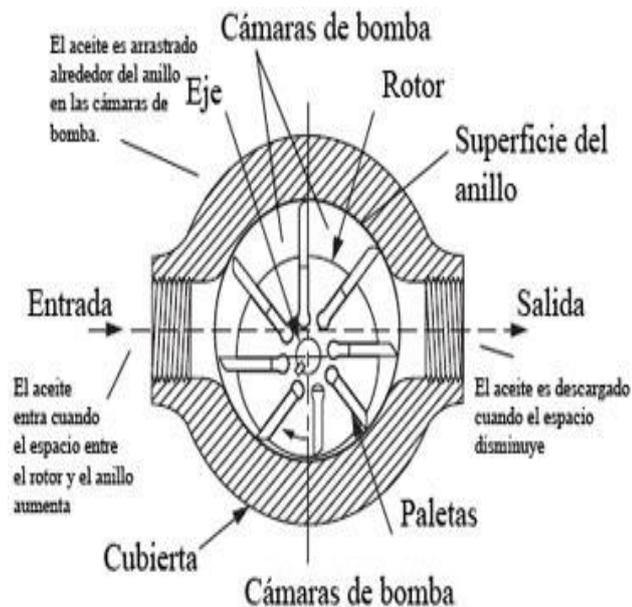
Figura 1.5 Representación de una bomba de paletas y sus partes [5].
