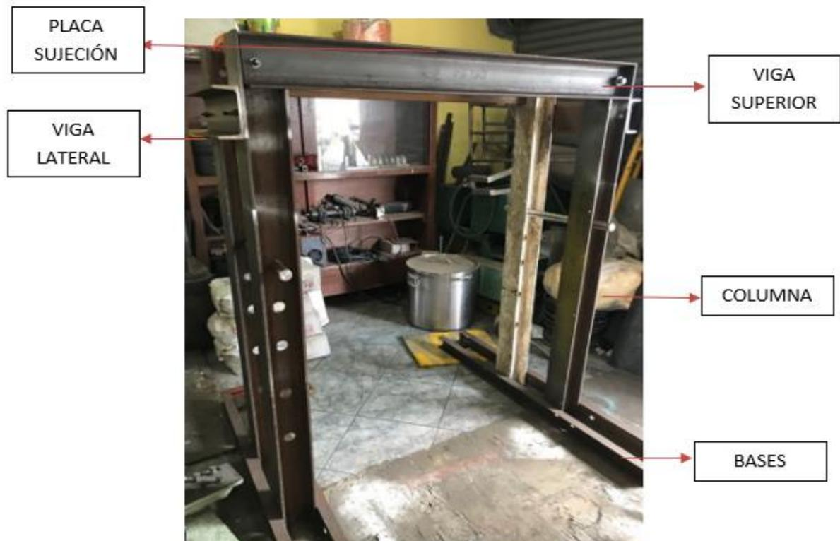
Figura 4.4 Chasis de la máquina construido.
