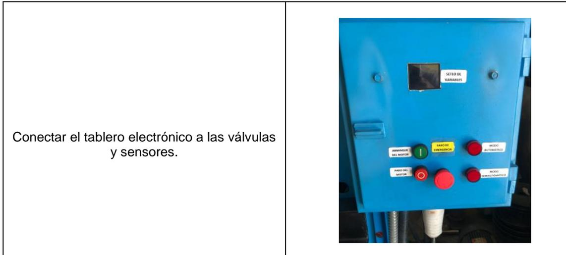
En la Figura 4.19 se muestra la máquina implementada, en el Anexo D se muestra el proceso de construcción para la máquina.
