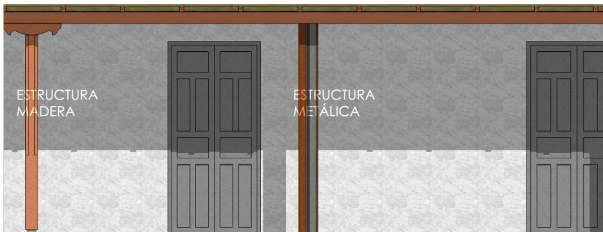
IMAGEN 71. Variación de estructura en portal
