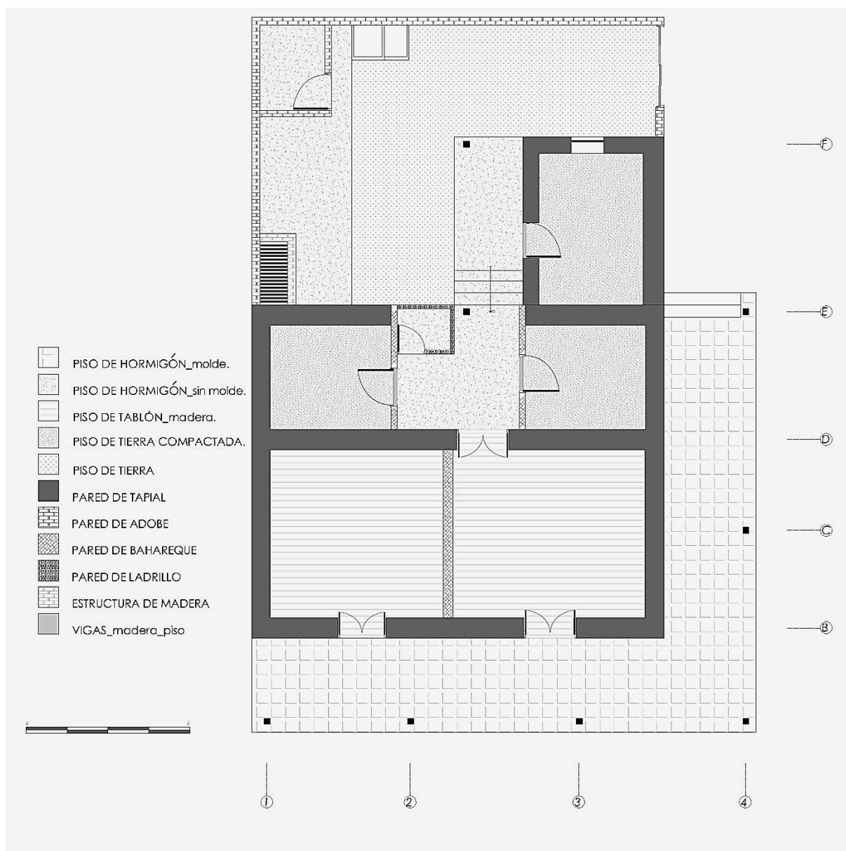
IMAGEN 28. Planta arquitectónica, vivienda tradicional 004
