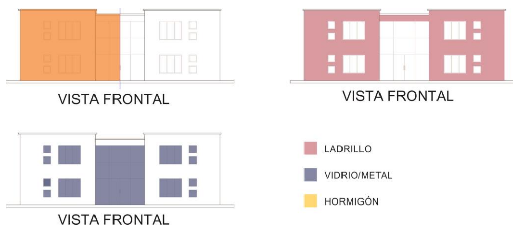
Fig. 89: Análisis de materiales y tipología del bloque n° 3 del Conservatorio de Música “S.B.C”
