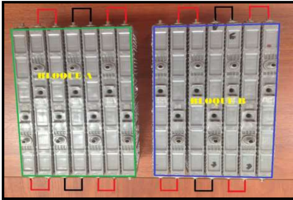
Fig. 25 Representación de conexión en serie de los bloques.
