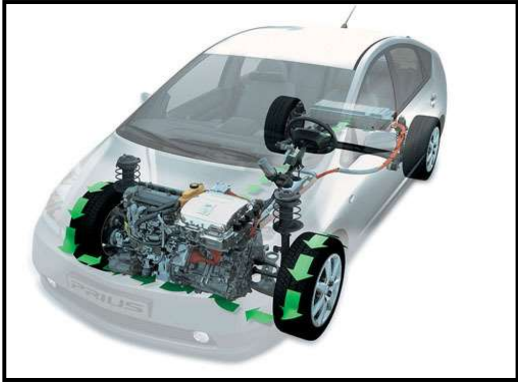
Fig.3 Regeneración de energía en el frenado.
