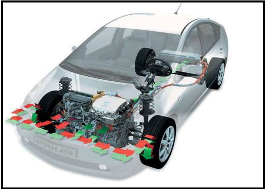
Fig.2 Representación de transmisión del vehículo híbrido.
