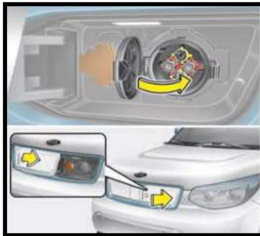
**Figura 18.** Cierre de la tapa de carga rápida
