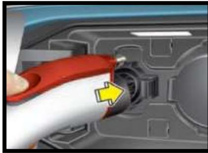
**Figura 7.** Conexión del conector de carga
