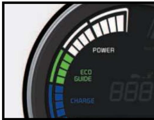
**Figura 22.** Indicador de operación de motor eléctrico
