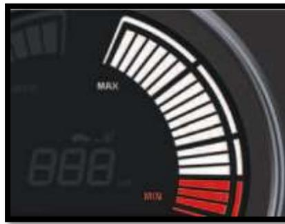
**Figura 42.** Indicador de estado de batería de alto voltaje
