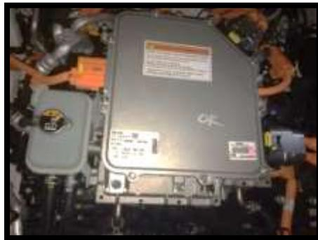
**Figura 24.** Inversor de corriente
