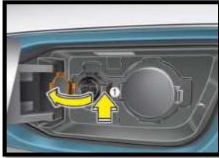
**Figura 6.** Abrir la tapa de la carga normal
