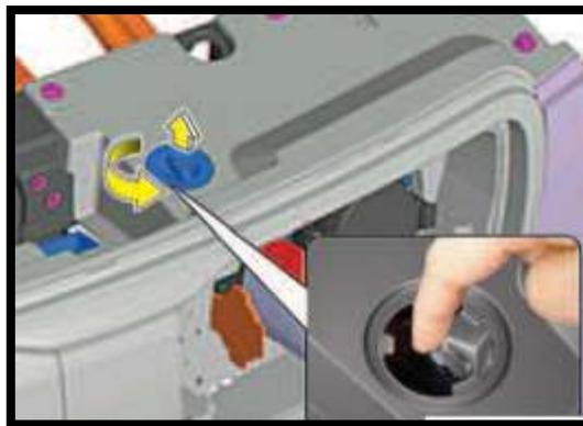
**Figura 11.** Liberación de emergencia del sistema del conector de carga
