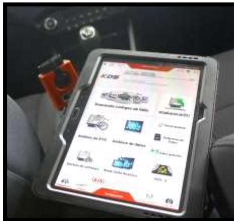
**Figura 55.** Diagnostico electrónico KDS
