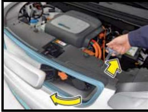
**Figura 10.** Desbloqueo de puerta de carga
