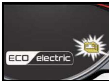
**Figura 43.** Testigo de advertencia de nivel de batería
