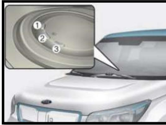
**Figura 12.** Comprobador de estado de carga
