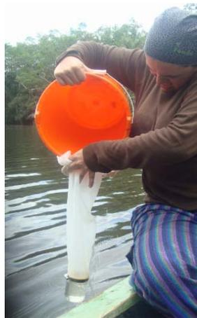
**Figura 7.** Proceso de filtración de las muestras colectadas con la botella Van Dorn a través de una red de fitoplancton.
