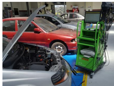
Figura 4: FSA BOSCH conectado al vehículo
