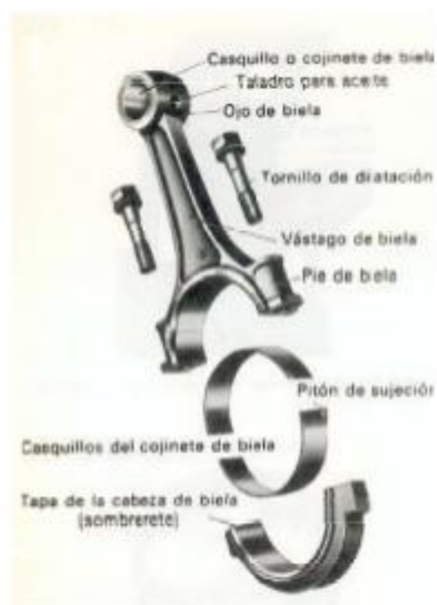
Figura 3.5 Componentes de la biela [Gerschler, 1985]
