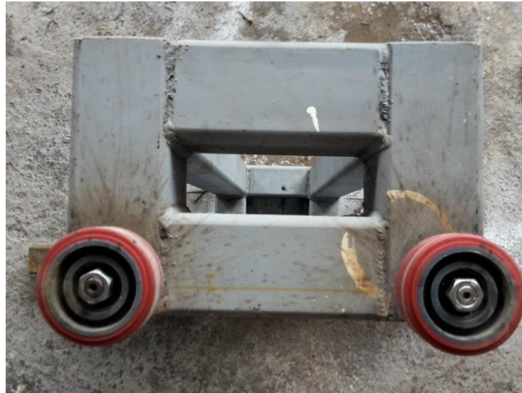
Figura 4.14. Ruedas de poliuretano en el distribuidor móvil
