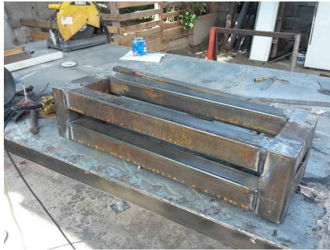
Figura 4.12. Estructura del distribuidor móvil
