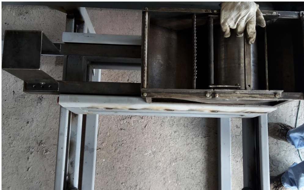
Figura 4.25. Vista aérea del carro de avance radial, contenedor de resina y homogeneizador de fibras
