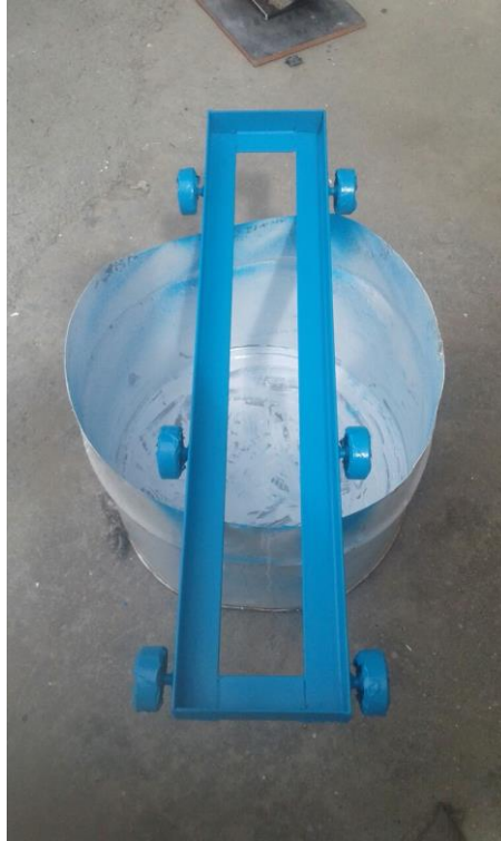
Figura 4.26. Pintura del carro de avance radial
