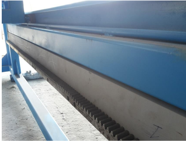
Figura 4.16. Ubicación de la cremallera del eje distribuidor
