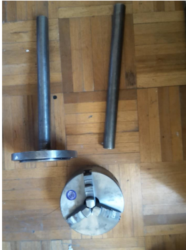
Figura 4.8. Ejes del sistema de rotación del mandril y mordaza
