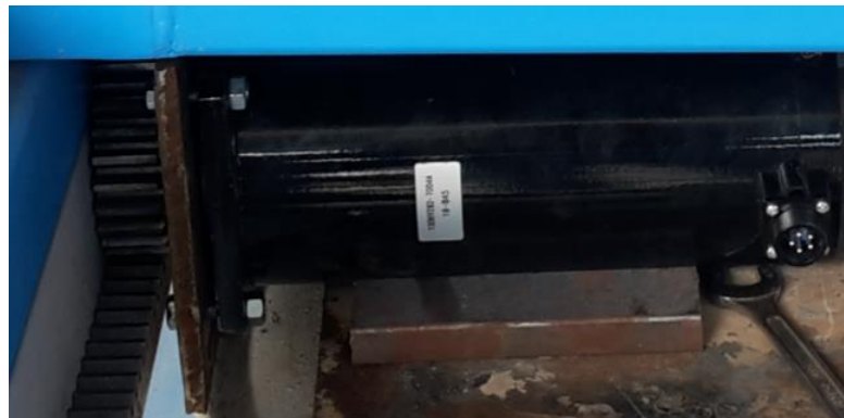
Figura 4.17. Posicionamiento del motor a pasos
