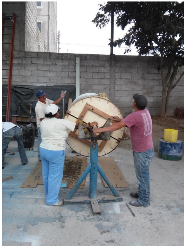
Figura 1.4. Proceso manual de construcción de un tanque de fibra de vidrio
