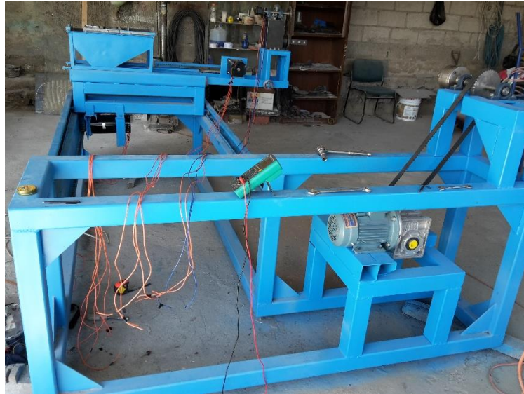
Figura 4.31. Cableado de motores a pasos
