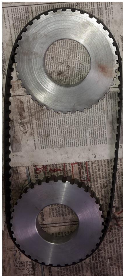
Figura 4.20. Poleas 36L050 y polea 285L050
