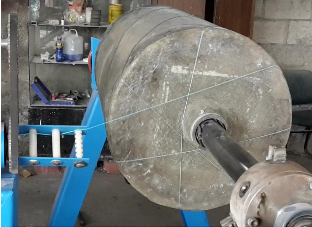
Figura 4.37. Secuencia de bobinado helicoidal, posición 3
