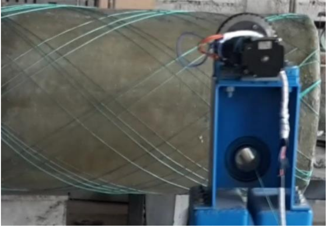
Figura 4.41. Secuencia de bobinado helicoidal, posición 7
