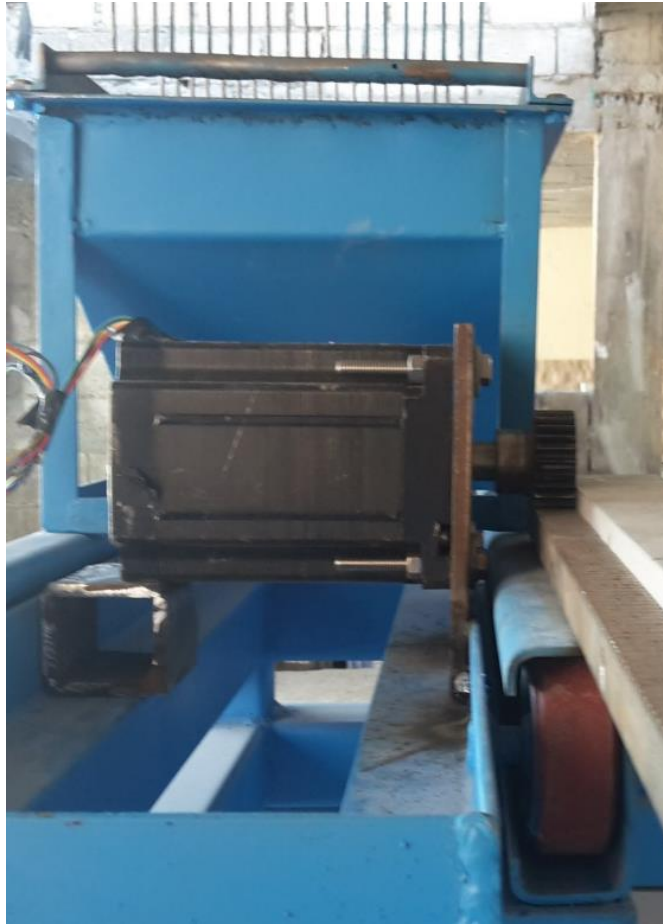
Figura 4.28. Ubicación del motor en el sistema piñón-cremallera
