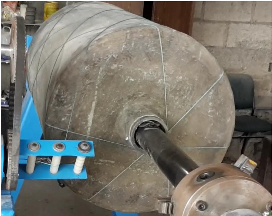
Figura 4.36. Secuencia de bobinado helicoidal, posición 2
