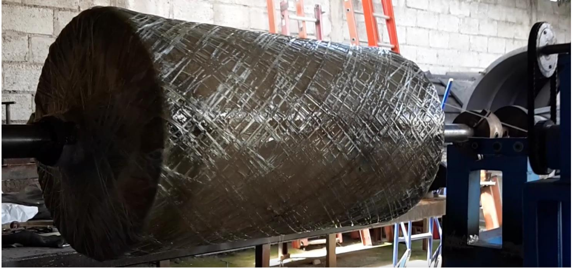
Figura 4.50. Construcción del tanque, 1 hora transcurrida
