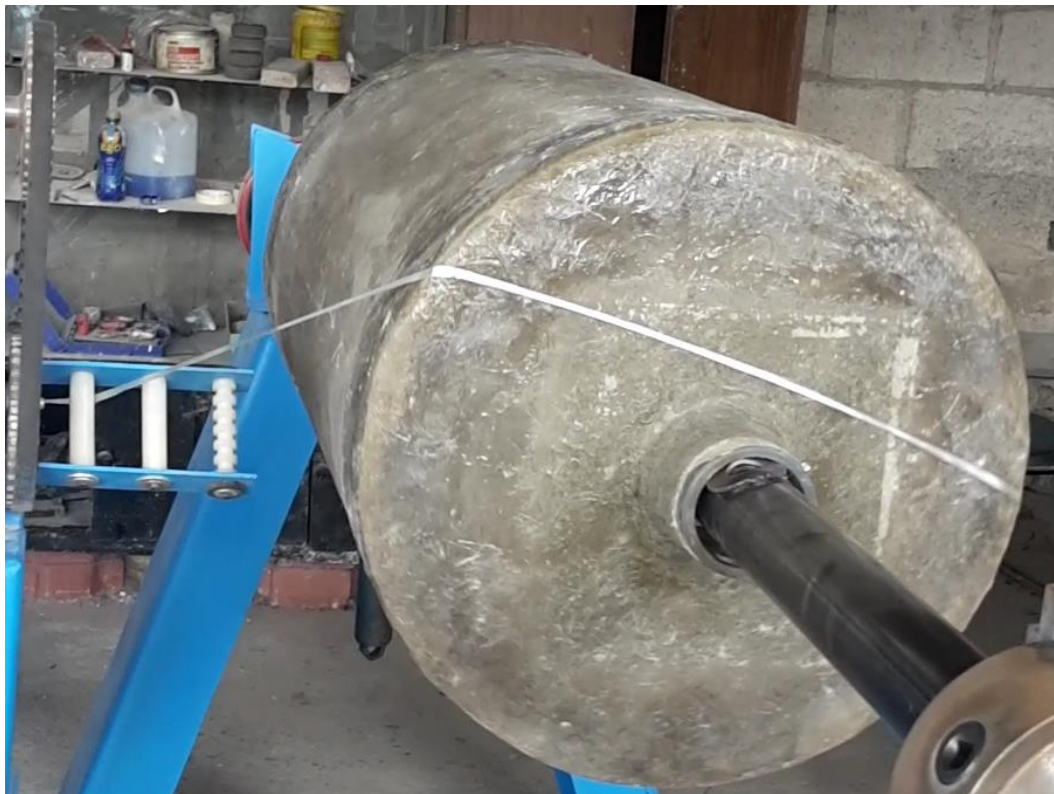
Figura 4.45. Construcción del tanque, etapa inicial
