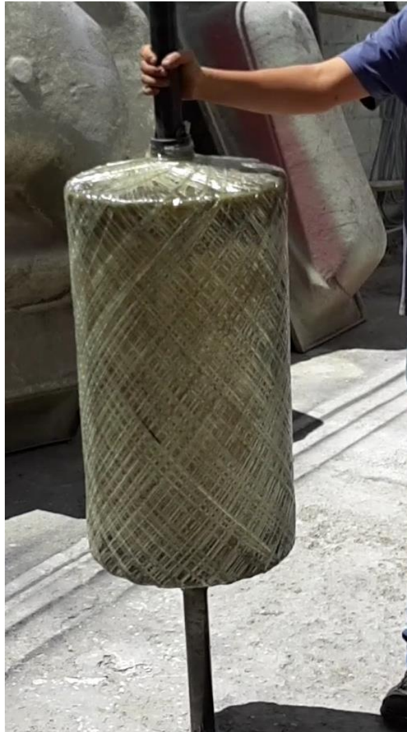
Figura 4. 54. Tanque construido, desmontado de la máquina
