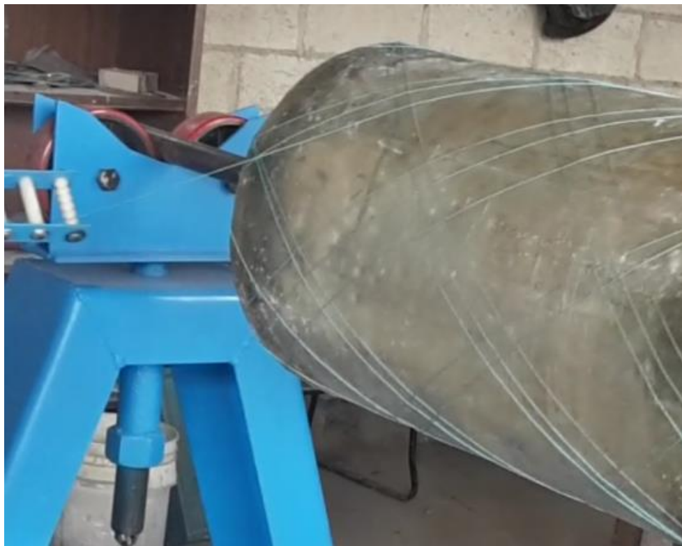
Figura 4.40. Secuencia de bobinado helicoidal, posición 6
