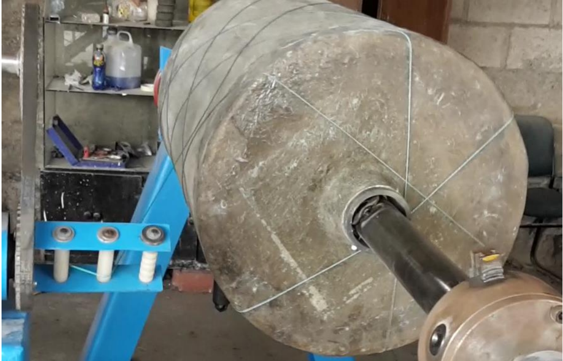
Figura 4.35. Secuencia de bobinado helicoidal, posición 1
