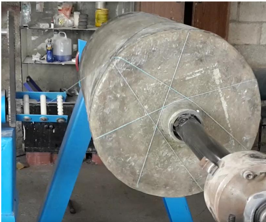
Figura 4.38. Secuencia de bobinado helicoidal, posición 4
