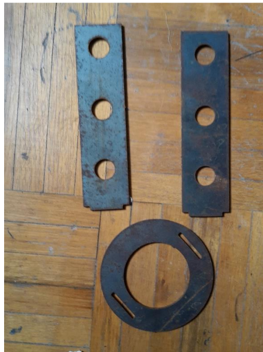
Figura 4.18. Piezas cortadas mediante chorro de agua
