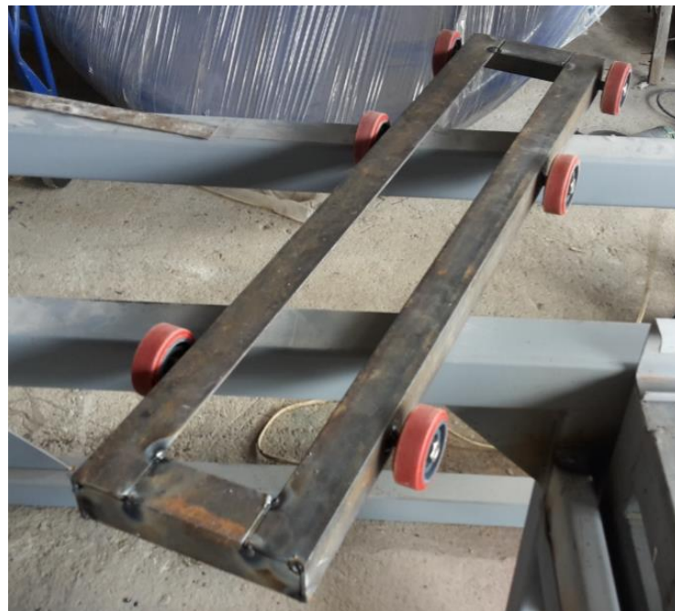
Figura 4.23. Carro de avance radial
