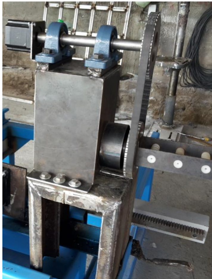
Figura 4.22. Ubicación del homogeneizador de fibras en la estructura
