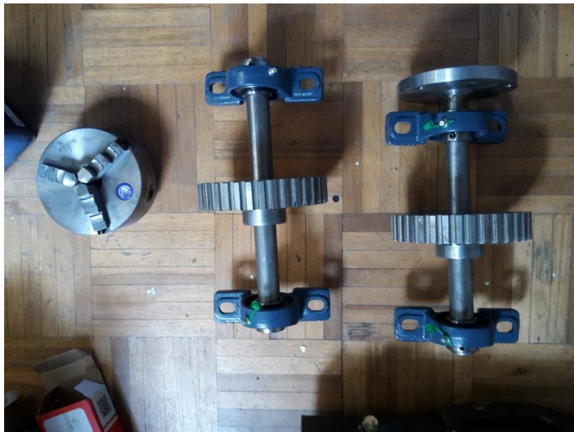
Figura 4.9. Ubicación de poleas y chumaceras en los ejes
