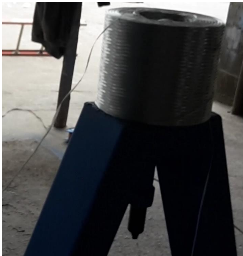
Figura 4.47. Carrete de filamentos posicionado durante el bobinado
