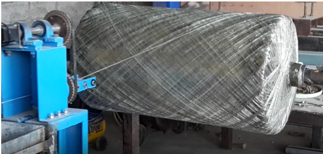
Figura 4.53. Construcción del tanque, tiempo: 4 horas
