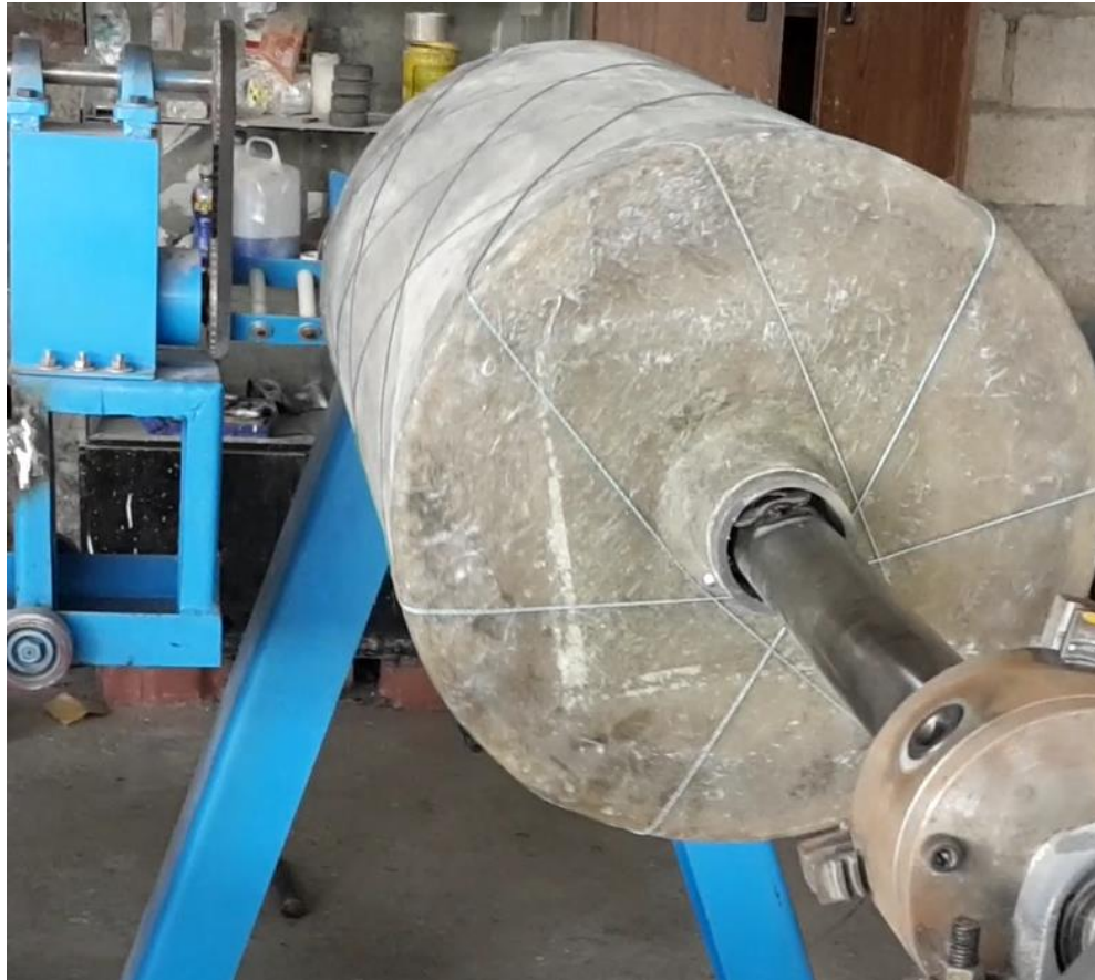
Figura 4.39. Secuencia de bobinado helicoidal, posición 5
