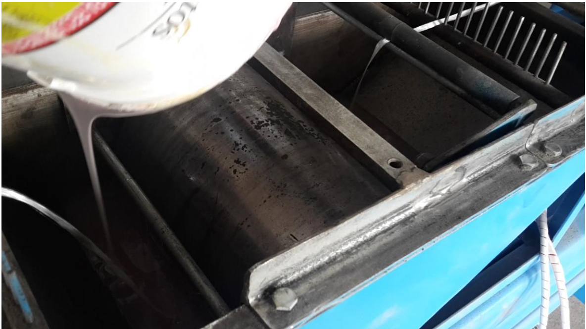
Figura 4.43. Baño de resina en el contenedor
