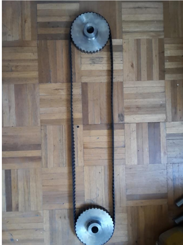
Figura 4.6. Poleas 36H100 con banda 750H100
