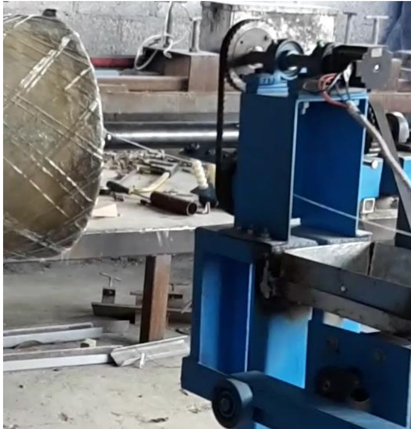
Figura 4.46. Construcción del tanque, patrones de bobinado
