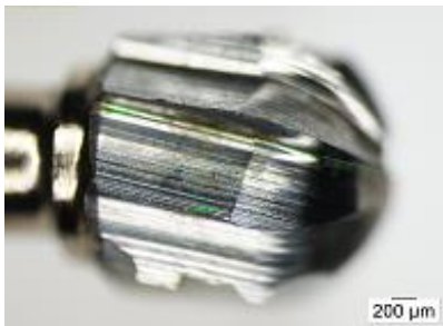
Fracturas producidas al tercer uso. Fotografía 13.
