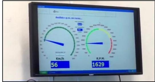
**Figura 3.5** Pantalla del dinamómetro con los valores de velocidad del vehículo y rpm del motor.
