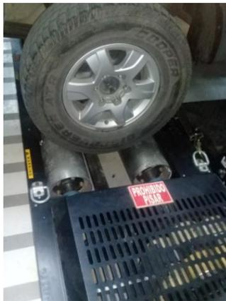
**Figura 3.9** Rodillos del dinamómetro DINO X
