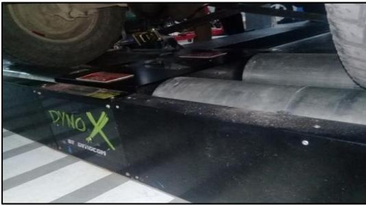
**Figura 3.8** Vehículo embancado en el dinamómetro marca DINO X
