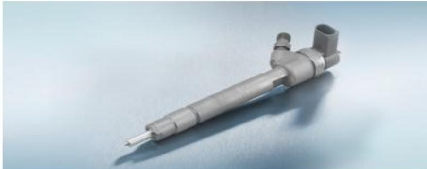
El inyector de un sistema Common Rail consta de una tobera, un actuador para los inyectores piezo o una válvula de solenoide para los inyectores de válvula solenoide, así como de las conexiones hidráulicas y eléctricas para el funcionamiento de la aguja de la tobera.
