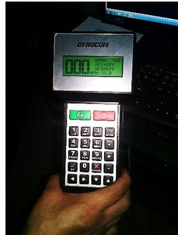
**Figura 3.11** Mando móvil del dinamómetro DYNOCOP
