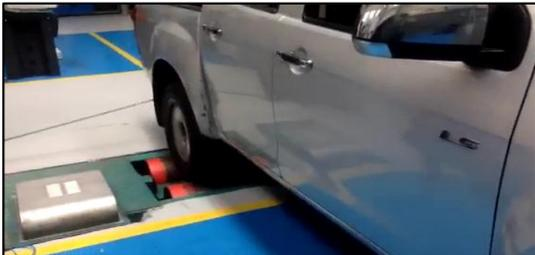
**Figura 3.3** Pruebas del dinamómetro con la camioneta Luv D Max CRDI 3.0
