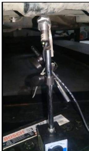
**Figura 3.10** Sensor laser óptico de mediciones de R.P.M. del motor
