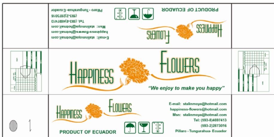
Figura 26. Modelo de caja de cartón tipo jumbo con capacidad para almacenar 600 tallos de mono clavel estándar con destino al mercado anglosajón, dimensiones 120 cm x 30 cm x 30 cm
