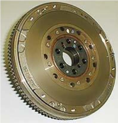
Ilustración 7 volante de inercia usado en diversos turismos de fabricación europea.
