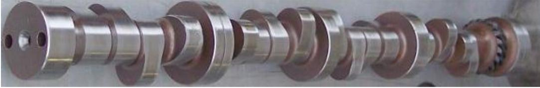
Ilustración 9 árbol de levas de un motor de combustión interna.
