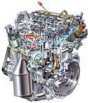
El motor diésel de inyección directa con sus órganos interiores a la vista. Los inyectores del sistema de inyección como rail mantienen la misma configuración que en sistemas de inyección tradicional. (mecanica, 2016)
