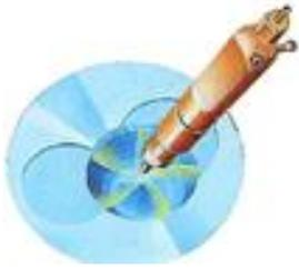
Cuando el pistón está llegando al punto muerto superior (pps) comienza el inyector a introducir el combustible en la cámara de combustión iniciándose la misma de forma casi inmediata. (mecanica, 2016)
