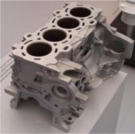
Ilustración 4 bloque de aluminio de un motor de cuatro tiempos
