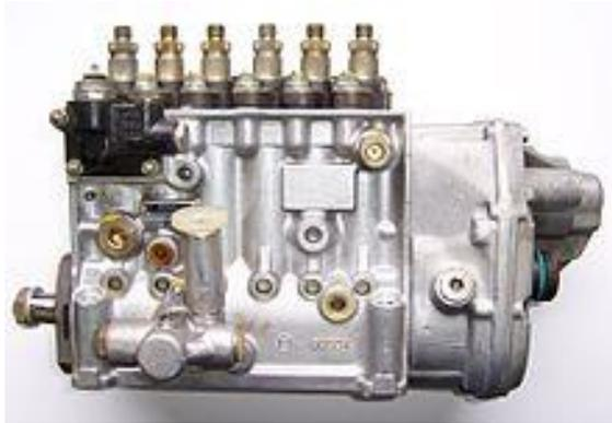
Ilustración 3 bomba inyectora en línea
