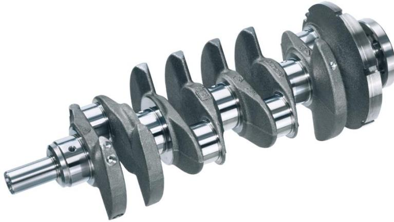
Ilustración 6 cigüeñal de cuatro cilindros y cinco apoyos, con doble contrapeso por biela
