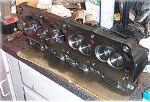
Ilustración 5 culata de un motor Ford
