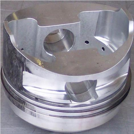
Ilustración 8 foto de un pistón desde su parte inferior. Se observan los segmentos y los orificios que alojan al eje de la biela.
