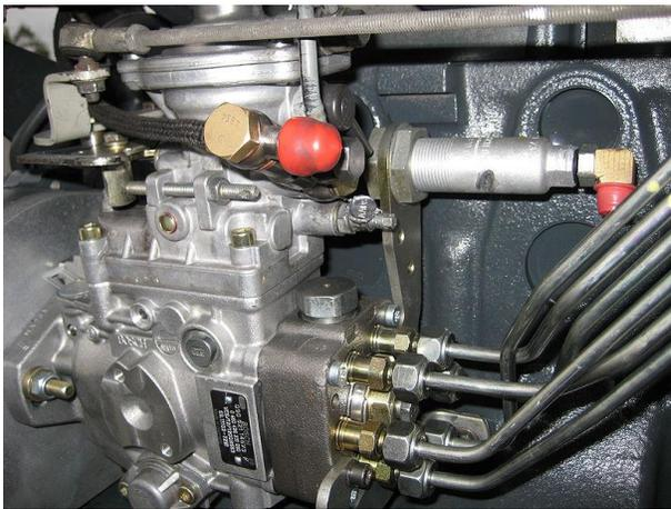
Ilustración 11 bomba rotativa Bosch para motor turbo, se aprecian las tuberías de alta presión
