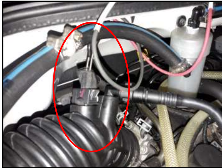
Figura 27. Localización del sensor de temperatura del aire de admisión (IAT). Fuente: Luis Macías Medina.
