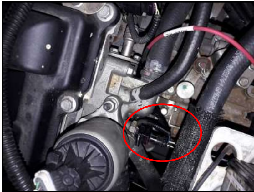
Figura 24. Localización del sensor de temperatura del refrigerante (ECT). Fuente: Luis Macías Medina.
