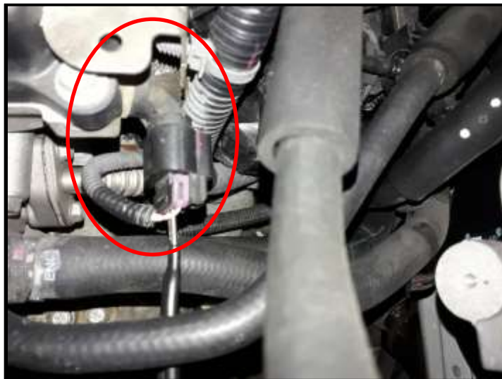
Figura 42. Ubicación del sensor de posición de la barra de levas (CMP). Fuente: Luis Macías Medina.
