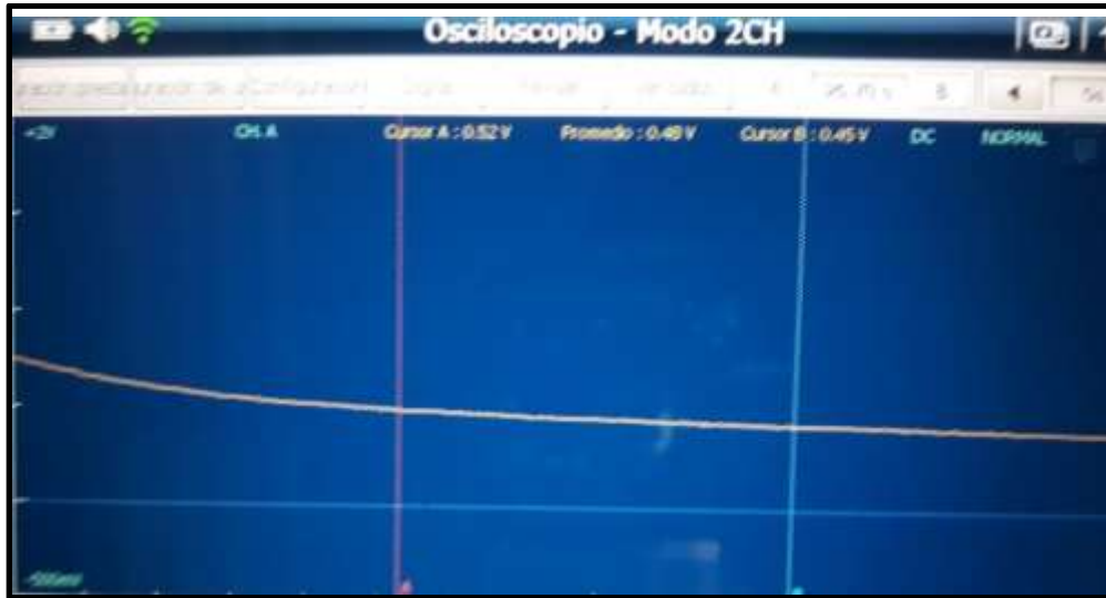
Figura 26. Curva característica del sensor de temperatura del refrigerante (ECT). Fuente: Luis Macías Medina.
