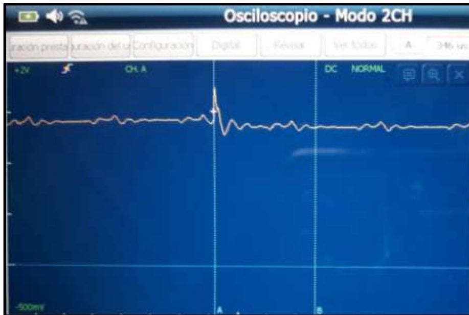
Figura 47. Curva del sensor de posición de detonación (KS). Fuente: Luis Macías Medina.
