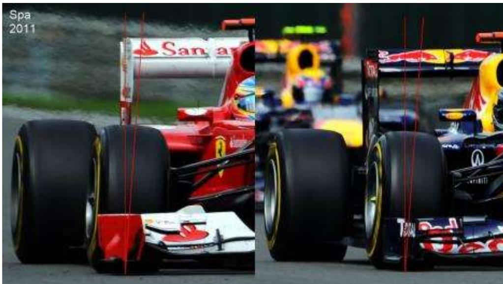
**Figura 34. Ángulo de salida y sus efectos sobre la orientación de las ruedas**
