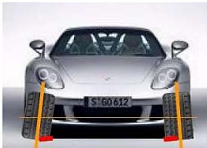
**Figura 19.** Vista real del ángulo positivo de caída
