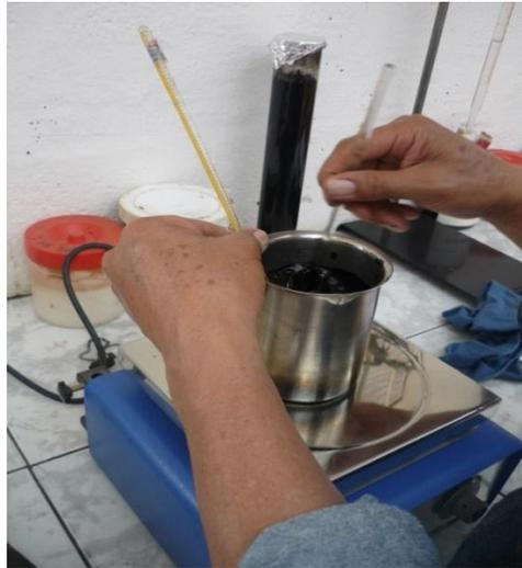
Al obtener la temperatura deseada en la muestra y en el viscosímetro, inmediatamente se vierte la muestra directamente en los contenedores del viscosímetro hasta que el nivel este por encima del borde de desbordamiento.
