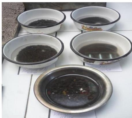
Terminado el periodo de inmersión, drenar totalmente la solución evitando pérdida de material. Una vez drenada la solución, se recomienda lavar la muestra para eliminar residuos de solución, el lavado debe ser con agua potable y con la ayuda de un tamiz de abertura inferior al árido, para evitar pérdidas en su masa. En este proceso de lavado las muestras no deben ser sometidas a impacto o abrasión, para evitar que las partículas tiendan a romperse.
