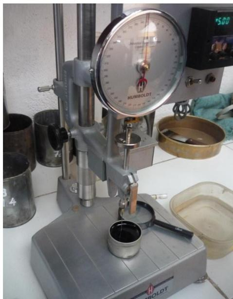
Previo al ensayo se debe encerrar la máquina y programar el tiempo especificado de 5 segundos.
