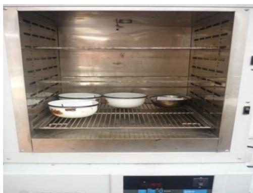
Alcanzada la masa constante, enfriar las muestras a temperatura ambiente y luego volver a sumergirlas en la solución, realizando todo el proceso nuevamente hasta obtener el número de repeticiones requeridas (5 repeticiones).
