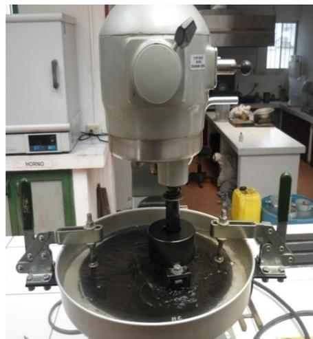
Finalizado el ciclo de abrasión, se retira la muestra y se lava para eliminar los residuos de materiales sueltos. Se coloca nuevamente sobre la base metálica forrada con papel y se la introduce en el horno a 60°C hasta alcanzar peso constante.
