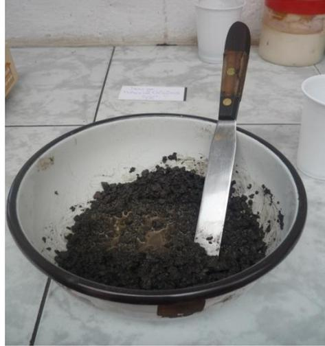
Antes de verter la emulsión en la mezcla, verificar que no tenga presencia natas o burbujas, caso contrario mezclarla con un agitador hasta conseguir una total homogeneidad. Realizado el proceso, colocar el porcentaje de emulsión y mezclar uniformemente de 1 a 3 minutos, hasta obtener un amasado homogéneo sin que la emulsión muestre coloración de ruptura.
