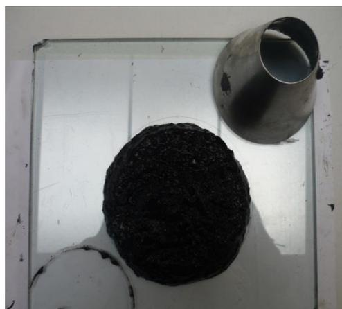
Se mide la fluencia de la mezcla en centímetros alcanzada por la mezcla en cuatro puntos de la escala de círculos de la base graduada, separados entre sí 90 grados. La fluencia recomendable que debe tener la mezcla, se da cuando recorre de 2 a 3 cm respecto al borde inferior del cono.
