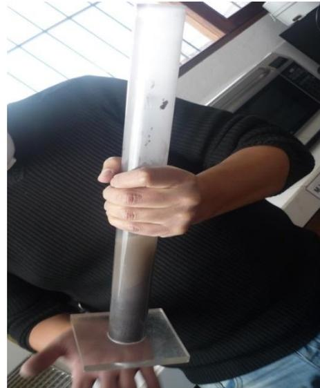
Programar el cronómetro y dejar reposar la mezcla durante  $10 \pm 1$  min., transcurrido el tiempo tapar la probeta con el tapón de caucho y colocarla en la máquina agitadora durante 45 ciclos.
