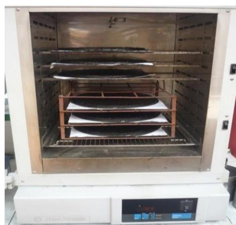
Transcurrido el tiempo de secado, retirar la muestra del horno y dejarla enfriar a temperatura ambiente por 30 minutos y se registra su peso. Seguidamente sumergir la muestra en baño maría a 25°C durante el lapso de 60 minutos.
