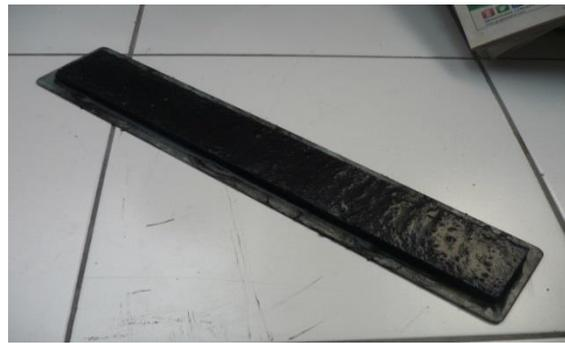
Transcurrido el tiempo de secado, retirar la muestra del horno y dejarla enfriar a temperatura ambiente por 30 minutos. A continuación, con la espátula se limpia los excesos de la briqueta y se registra su peso, luego se la coloca en la máquina centrando sus caras y se fija las arandelas de agarre.
