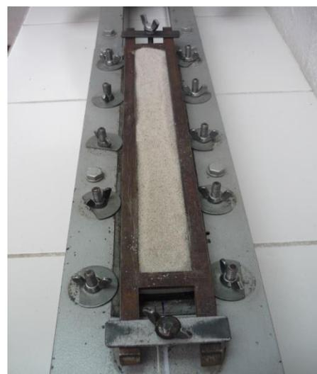
Se coloca nuevamente la rueda sobre la briqueta y se coloca los pesos. Se enciende la máquina y se inicia el proceso de compactación hasta completar 100 ciclos adicionales.
