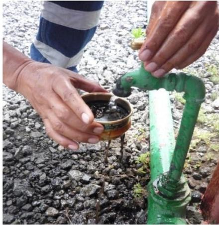
Realizado el lavado, se coloca el recipiente de recolección debajo del tamiz y se seca en el horno a temperatura constante de  $110^{\circ}\text{C} \pm 5^{\circ}\text{C}$ , por el lapso de 2 horas. Finalizado el tiempo de secado, sacar la muestra y dejar enfriar a temperatura ambiente, para posteriormente pesar el tamiz con el residuo retenido seco.
