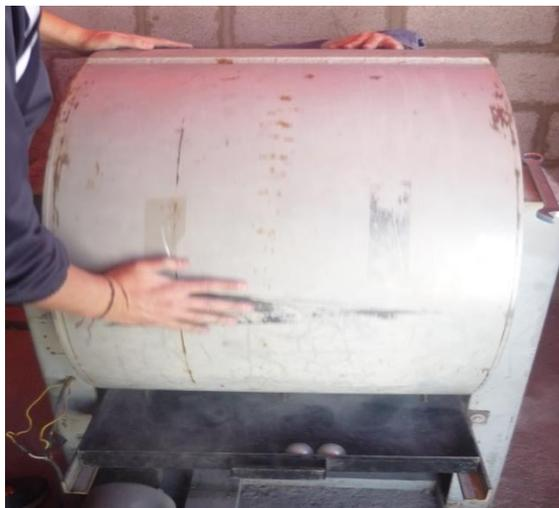
Finalizado el número de revoluciones, se libera la tapa del tambor y se descarga el material ensayado junto con la carga abrasiva, en la bandeja de recolección. Retirar la carga abrasiva de la bandeja y tamizar la muestra ensayada por el tamiz # 12, y registrar el peso retenido.
