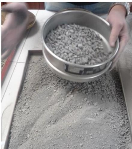
Las muestras obtenidas se deberán lavar y secar en el horno a una temperatura constante de 110°C ± 5°C, hasta peso constante.
