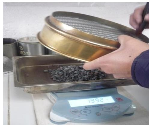
Finalizado el tamizado, se debe colocar en el recipiente material pasante del tamiz No 200, para realizar un análisis comparativo de pesos. El peso total registrado en la balanza debe ser muy similar al peso de la muestra original seca. Si los
