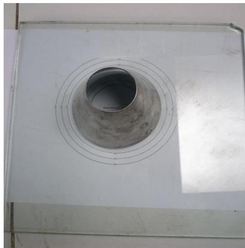
Una vez obtenida la homogeneidad de la mezcla, se vierte suavemente en el interior del cono por su abertura superior con ayuda de la espátula, hasta llenado completo. Mientras se realiza el llenado del cono se debe mantener fija su base y centrada con la hoja graduada.
