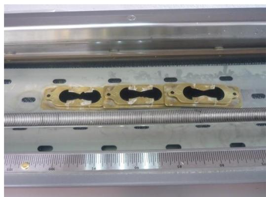
Después, retirar del baño las muestras enrasarlas con el filo de la espátula previamente calentada en el reverbero. Cuidadosamente retirar los moldes intermedios de las briquetas y sumergir las muestras en el Ductilómetro, introduciendo los seguros de la máquina en los orificios de los extremos de las briquetas.
