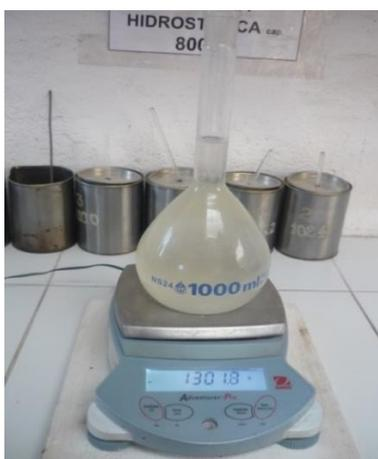
Transcurrido el tiempo de reposo de la solución, agitar nuevamente y comprobar su gravedad específica. Sumergir las muestras en la solución, de forma que el sobrepase 12.5 mm el nivel de la masa de partículas. Mantenerlas sumergidas a  $21^{\circ}\text{C} \pm 1^{\circ}\text{C}$  de temperatura, durante mínimo 16 horas y máximo 18 horas. Se recomienda tapar las muestras para reducir la evaporación y evitar ingreso de agentes extraños.
