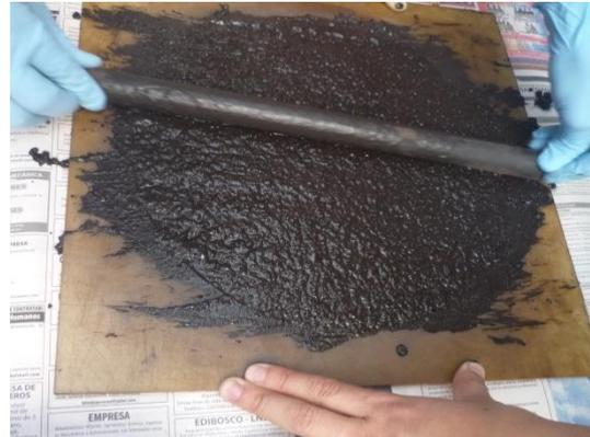
Dejar reposar la muestra por lo menos 5 minutos, luego retirar cuidadosamente el molde realizando suaves movimientos circulares. Una vez retirado el molde, colocar la muestra sobre la base metálica evitando que la mezcla pierda su forma. Se recomienda forrar la base metálica con papel para evitar que la base de caucho se le adhiera. Colocar la muestra en el horno a una temperatura de 60°C y secar hasta peso constante (mínimo 16 horas de secado).
