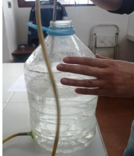
Colocar el sistema de sifón a una altura aproximada de un metro de altura respecto a la probeta y verter (por gravedad) su contenido mediante el tubo irrigador, hasta una altura de  $100 \pm 2.54$  mm de la graduación de la probeta.
