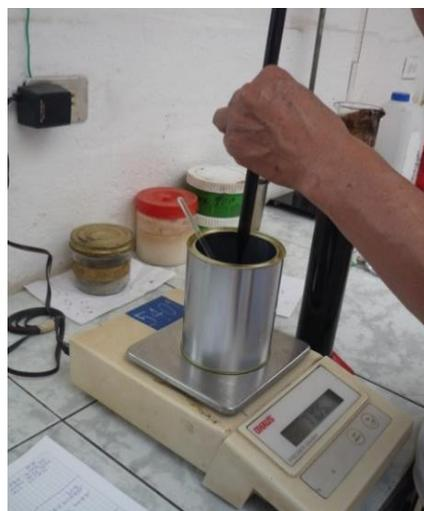
Realizar el mismo proceso para tomar las muestra de la segunda probeta. Obtenidas las cuatro muestras, colocar los recipientes en el horno por el lapso de 2 horas a una temperatura constante de  $163^{\circ}\text{C} \pm 3^{\circ}\text{C}$ .
