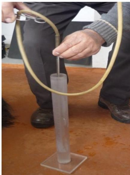
Tomar una medida de agregado pasante del tamiz # 4, colocarla en el recipiente redondo metálico (lleno casi al ras) y con la ayuda de un embudo colocarla dentro de la probeta con el contenido.
