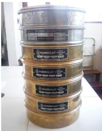
Para el agregado fino se debe preparar muestras de 100 g de cada uno de las fracciones, como se indica en la tabla 3.10.
