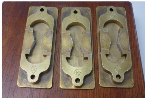
Caliéntese cuidadosamente la muestra de residuo asfáltico, hasta llegar a su estado fluido y verterla dentro de las briquetas hasta rebasar ligeramente el nivel de enrase, evitando la formación de burbujas. Dejarlas enfriar a temperatura ambiente durante 30 minutos. Transcurrido el tiempo de enfriamiento, verificar con el termómetro que la temperatura del baño de agua sea de  $25^{\circ}\text{C} \pm 0.1^{\circ}\text{C}$  y sumergir las briquetas por un periodo de 30 minutos.
