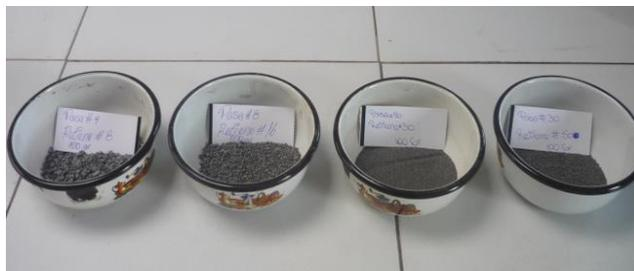
Verter agua en el recipiente plástico, suficiente para sumergir todas las muestras a ensayar. El agua debe tener una temperatura constante entre 25° a 30°c, por lo que se recomienda preparar la solución de sulfato de magnesio con ayuda del baño maría.
