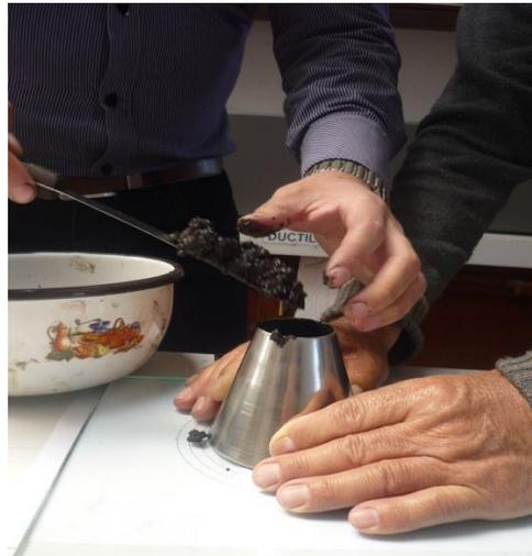
Finalizado el llena y enrasado los excesos, rápidamente levantar el cono con un movimiento vertical, lo que ocasionara el que la mezcla fluya libremente sobre la base graduada.
