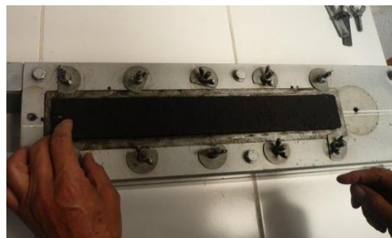
Se coloca la rueda sobre la briqueta y se verifica que el recorrido de la rueda sea por el centro de la muestra. Después, se humedece la rueda con agua y se carga la caja de pesos hasta la carga de 125 libras.
