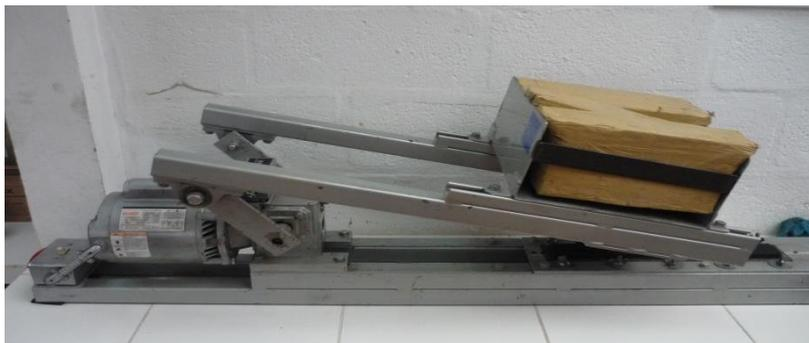
Se retira las briqueta para registra su peso y se la vuelve a colocar en la máquina fijándola en su posición inicial. Se coloca el molde para arena sobre la briqueta con el caucho espumoso hacia ella, se centra la abertura molde con la señal del recorrido realizado por la rueda y se fija evitando que la espuma se deforme.
