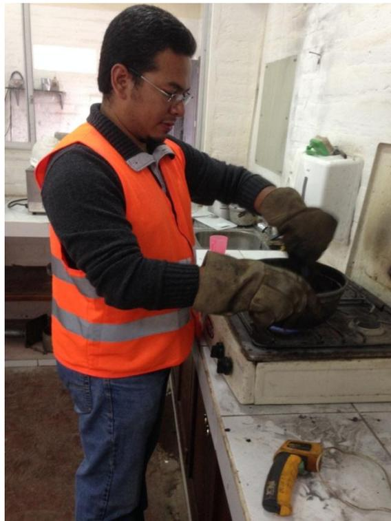
*Fotografía 3.9: Agregados a temperatura constante para elaboración Briquetas*
