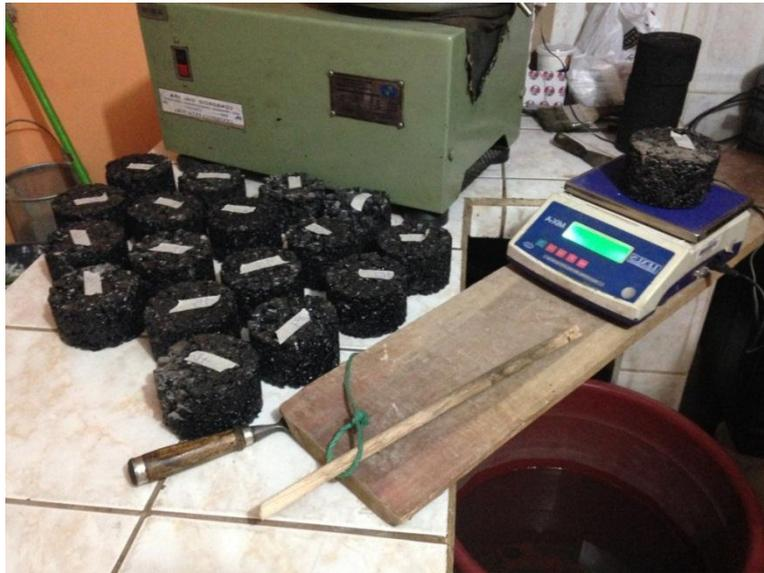
*Fotografía 3.12: Peso de Briquetas con diferentes contenidos de asfalto*
