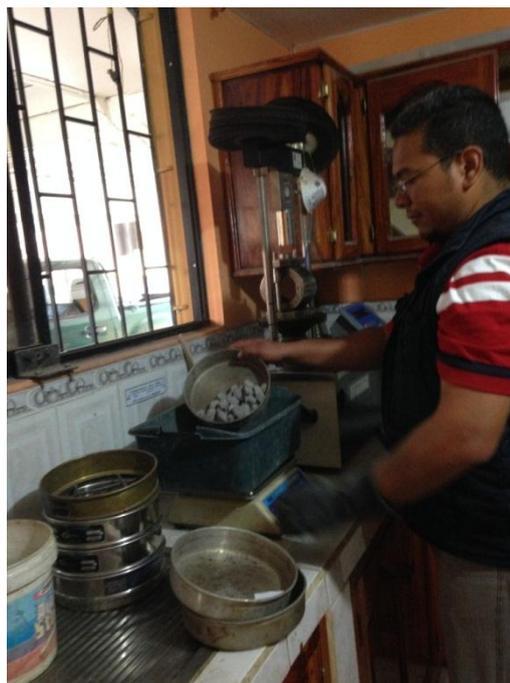
*Fotografía 3.6: Peso de muestra sumergida*
