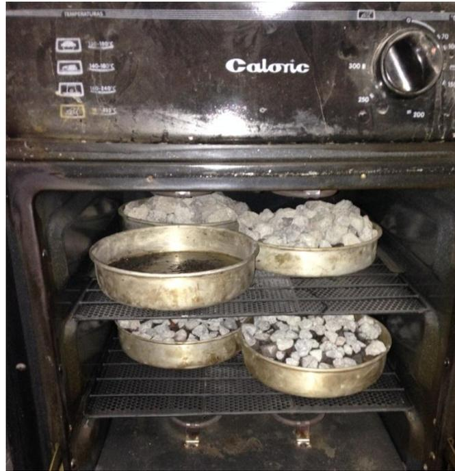
*Fotografía 3.3: Agregados secados en horno*
