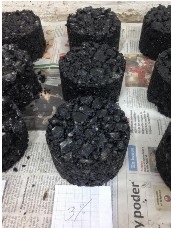
Fotografía 3.11: Briquetas elaboradas al 3% de contenido de asfalto
