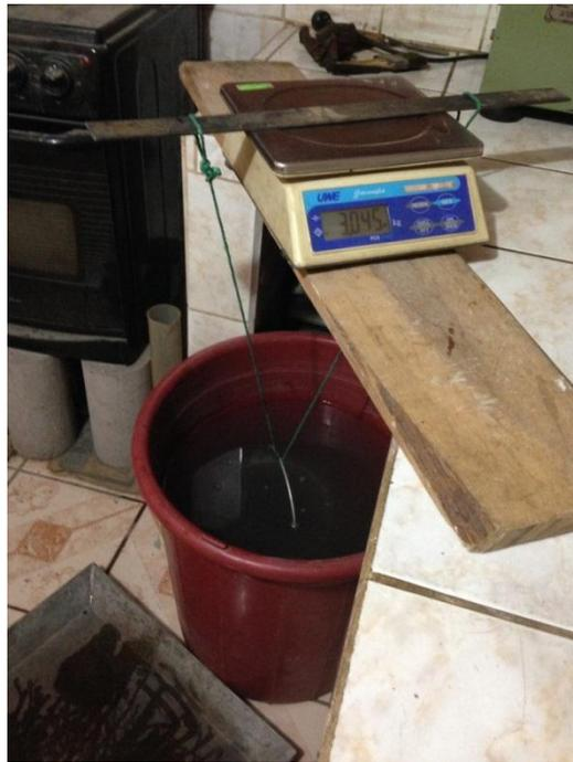
*Fotografía 3.5: Equipo utilizado para Gravedades Especificas*
