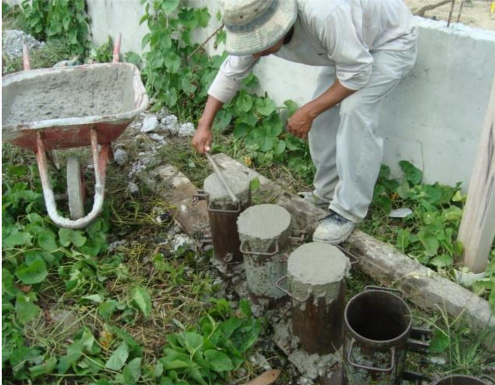
**Ilustración 47. Toma de Muestras de Hormigón**
