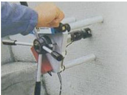
Este ensayo es superior al de Esclerometría por el mayor volumen de hormigón en contacto y la mayor profundidad involucrada en esta determinación.
