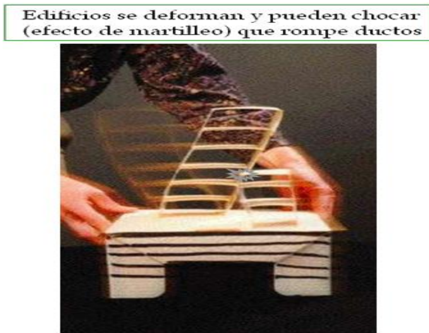
Figura 52- Efecto del choque entre edificios
