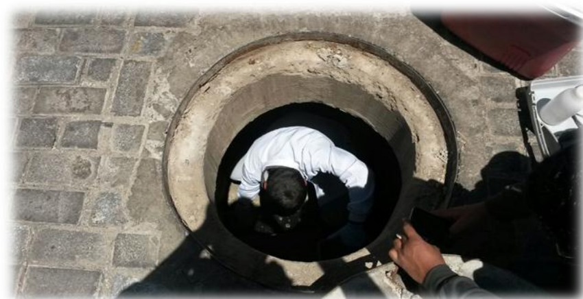
Fotografia 3. Toma de muestra en el interior del pozo de revisión
