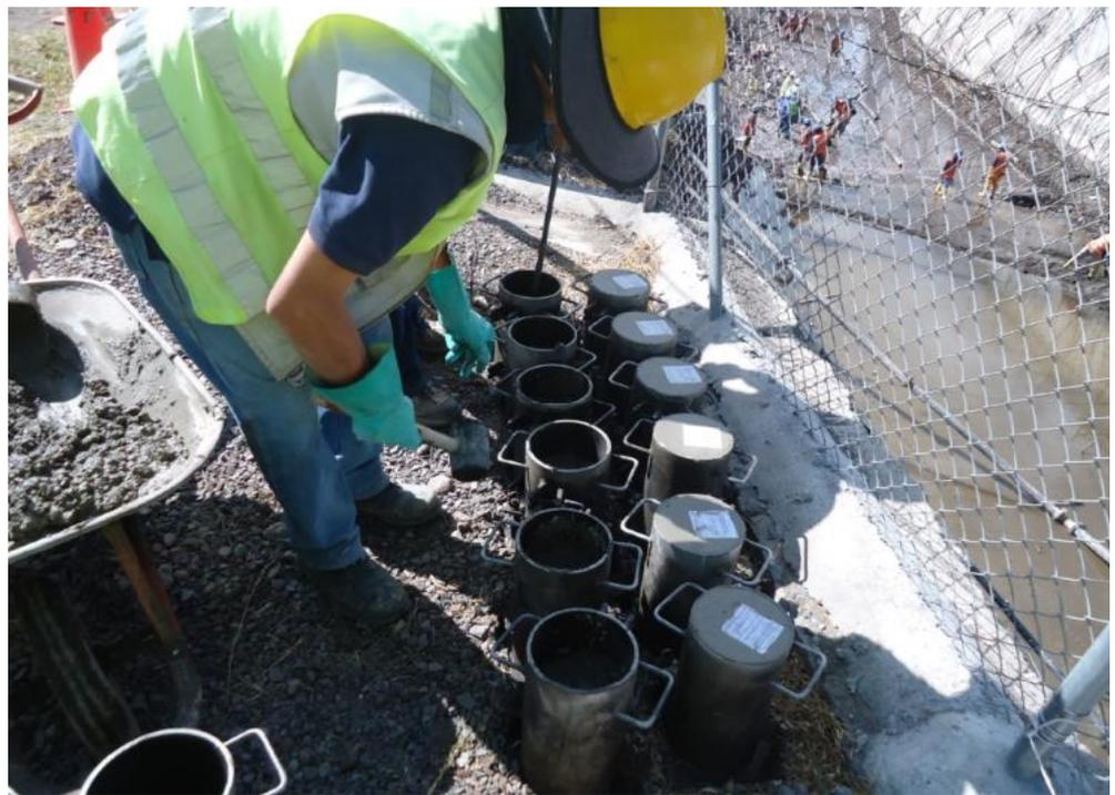
**Figura 46.** Tomando las muestras para el ensayo a compresión II
