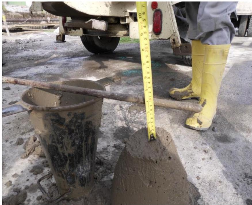
**Figura 48.** Ensayo de asentamiento
