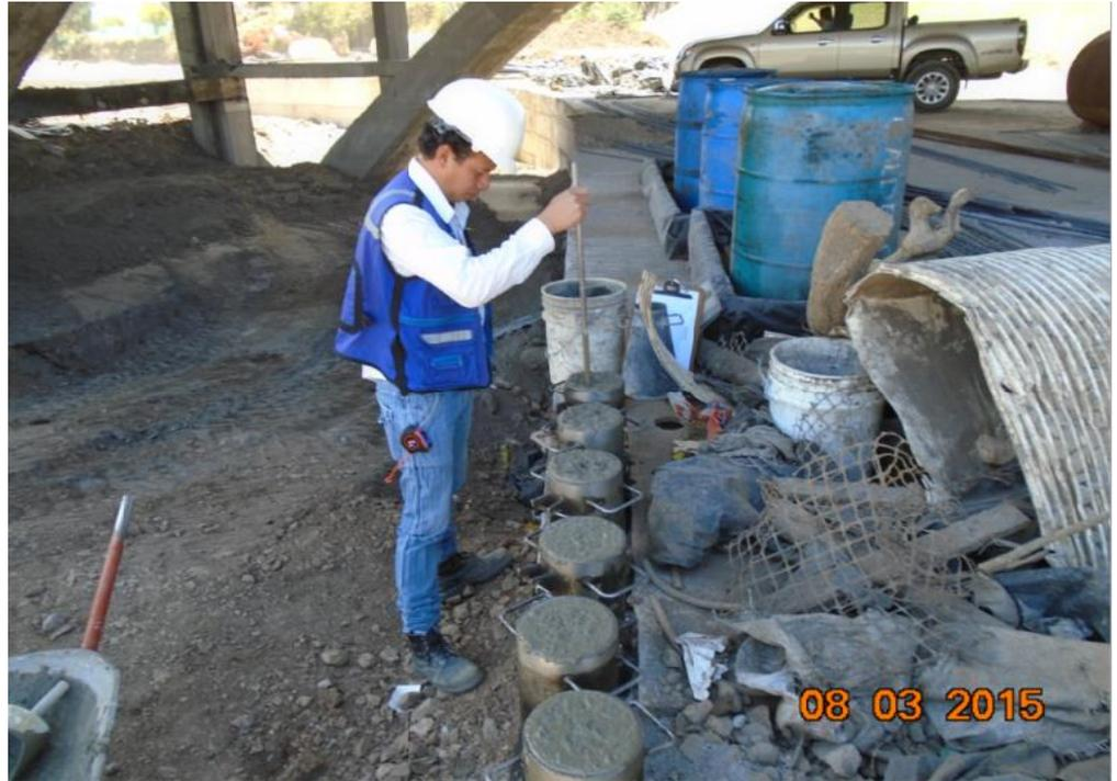
**Figura45.** Tomando las muestras para el ensayo a compresión I
