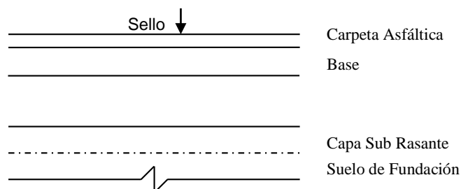
Ilustración 12 Estructura del Pavimento Flexible
