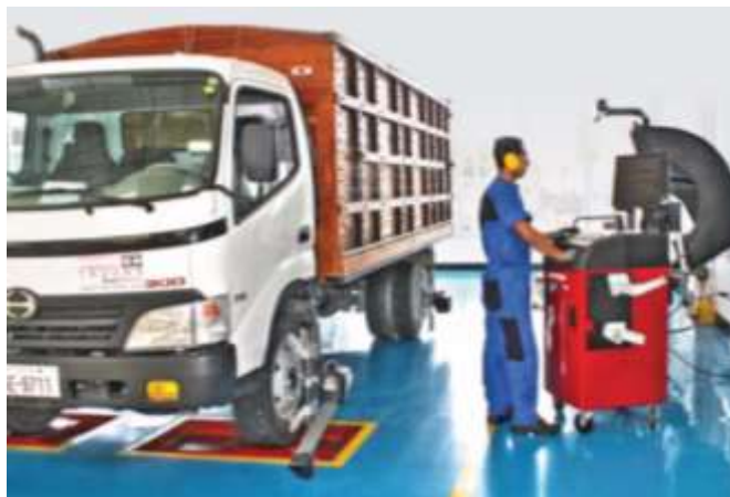
Figura 13. Enllantaje y alineación de pesado.
