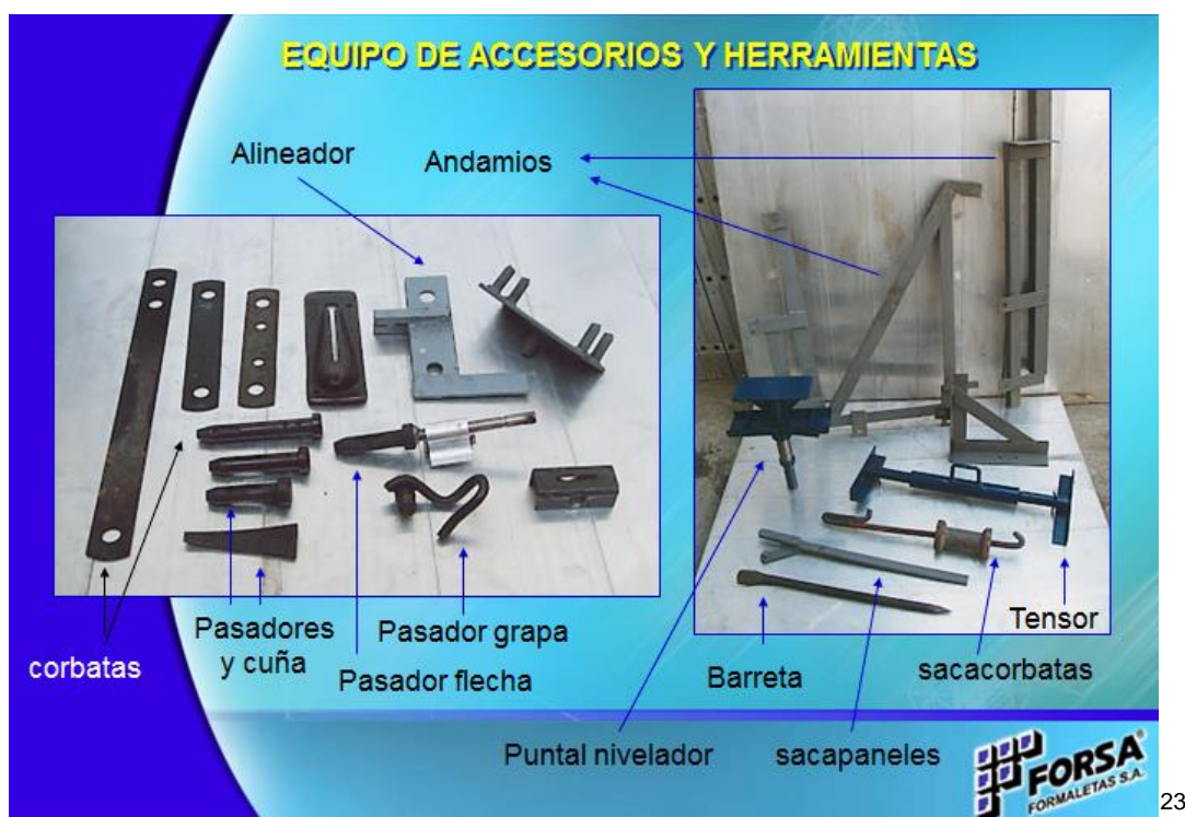
Foto 2.2.1f: Equipo de accesorios y herramientas del sistema de encofrado Forsa.
