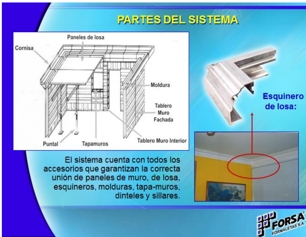
Foto 2.2.1f: Partes del sistema de encofrado metálico Forsa.
