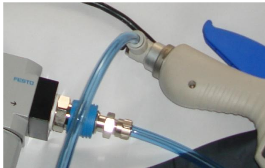
Fig. 4.5, Unión entre el sistema de filtrado y la pistola de aplicación por medio de manguera y acoples rápidos.
