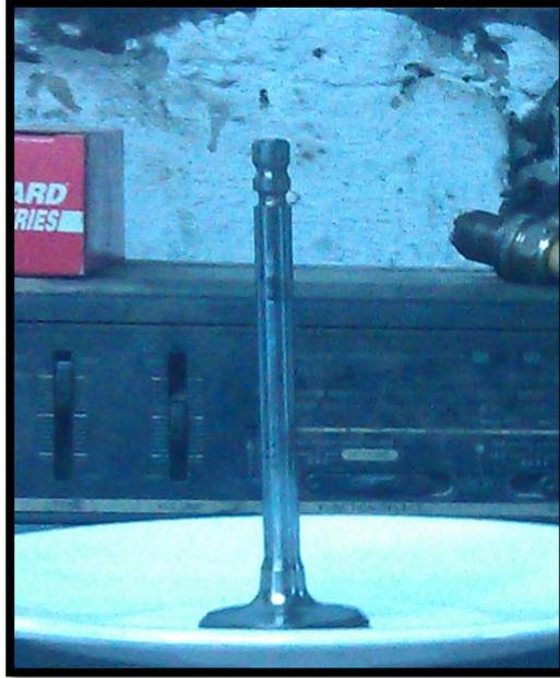
**Figura 3. 8 Válvula para motor Mini Austin**
