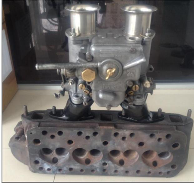
**Figura 3. 32 Doble carburador para Mini Austin**
