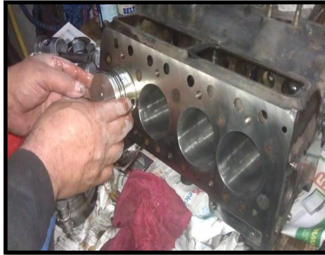
**Figura 3. 4 Bloque cepillado y cilindros rectificados**
