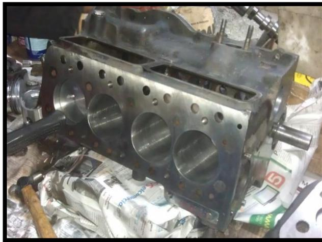
**Figura 3. 2 Motor Mini Austin rectificado**
