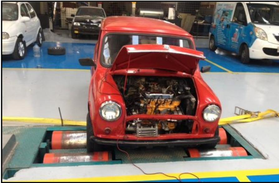
**Figura 3. 39 Pruebas en el dinamómetro para mini Austin**
