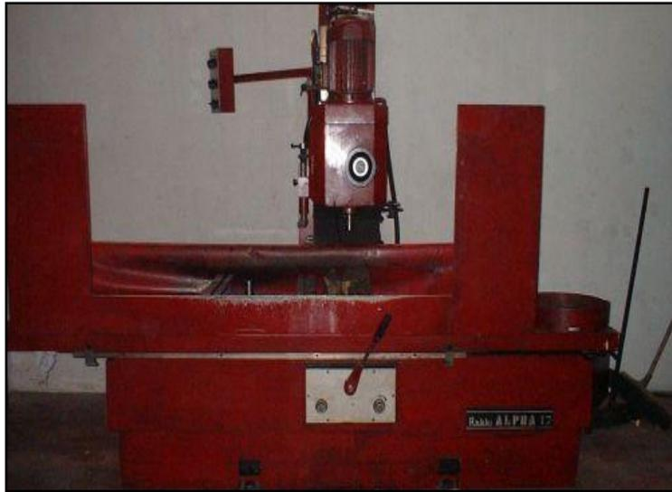
**Figura 3. 5 Rectificadora de superficies planas**
