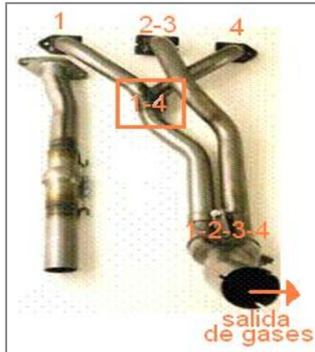
**Figura 3. 29. Header creado para motor modificado**
