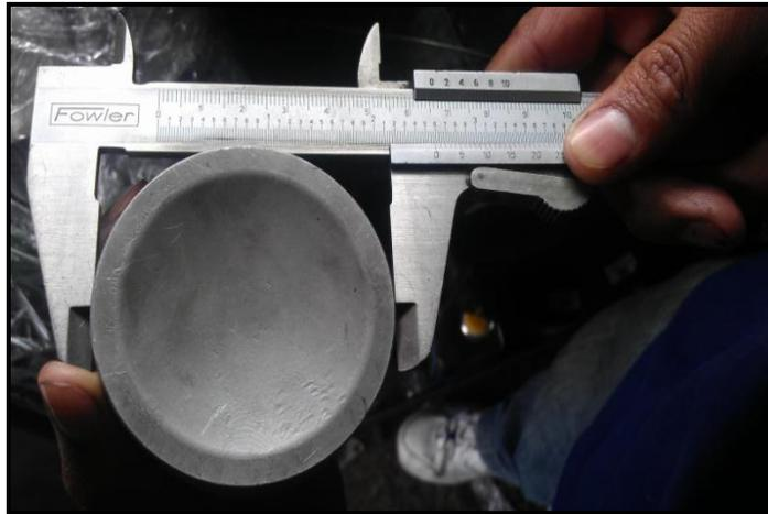
**Figura 2. 4 Piston estandar del motor de Mini Austin**
