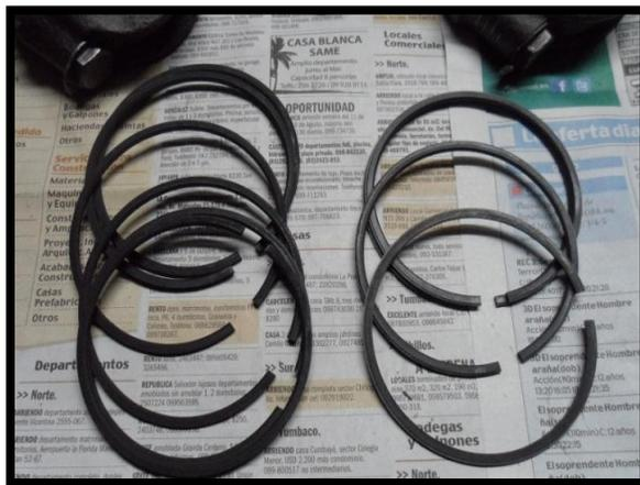
**Figura 2. 5 Anillos para pistones de motor Mini Austin**
