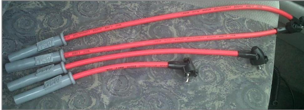
**Figura 3. 37 Cables MSD de alto voltaje para motor de mini Austin**
