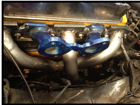
**Figura 3. 31 Header para el motor repotenciado de Mini Austin**
