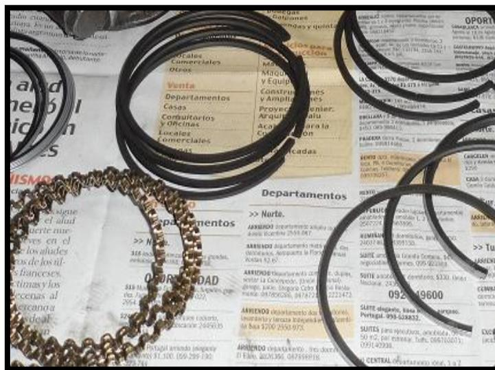
**Figura 3. 22 Segmentos para pistones de motor Mini Austin**
