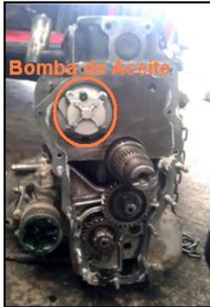
**Figura 2. 3 Bomba de aceite del Motor Mini Austin**
