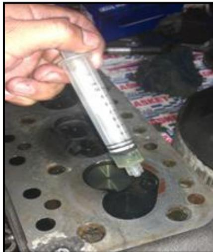
**Figura 2. 7 Medición del volumen de la cámara de combustión**
