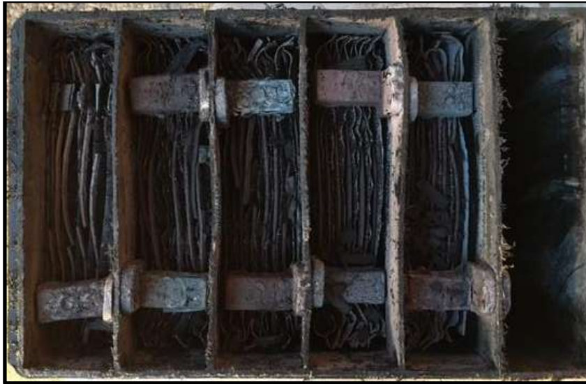
Figura. 7 Bloque de celdas de una batería plomo – ácido
