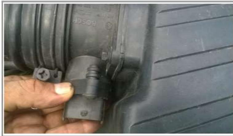
**FIGURA 50.** MAF, Mass air flow- Sensor de temperatura de aire de entrada. Ubicación
