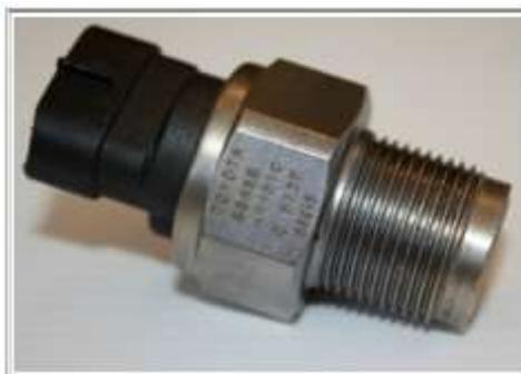
**FIGURA 13.** RPS, sensor de presión del riel común
