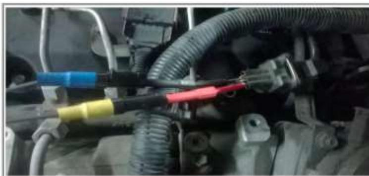
**FIGURA 41.** CMP, Sensor de posición del árbol de levas
