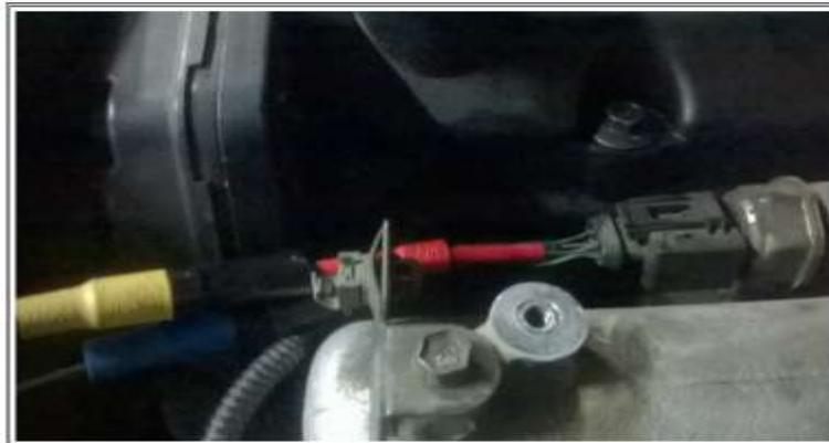
**FIGURA 35.** RPS, desconexión del sensor de presión del riel común
