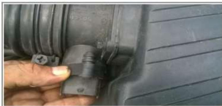
**FIGURA 53.** IAT, Intake air temperature - Sensor de temperatura de aire de entrada. Ubicación
