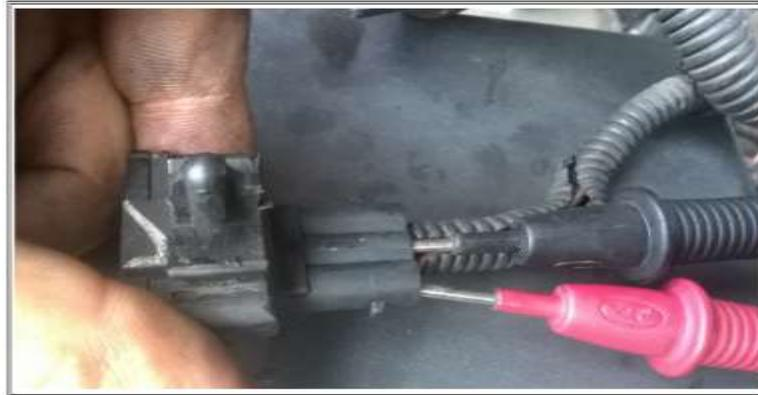
**FIGURA 48.** ECT, Sensor de temperatura del refrigerante
