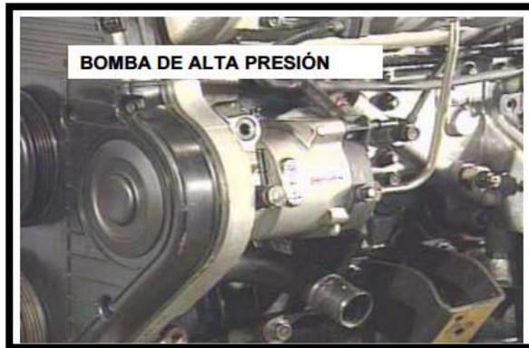
**FIGURA 8.** Descripción de engranaje de distribución de motor y bomba de alta presión de sistema CRDI
