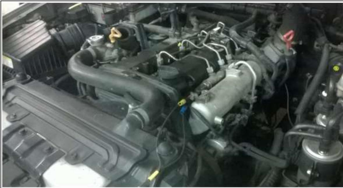
**FIGURA 82.** Motor J3 de Hyundai terracan 2.9 CRDI utilizado en el proyecto
