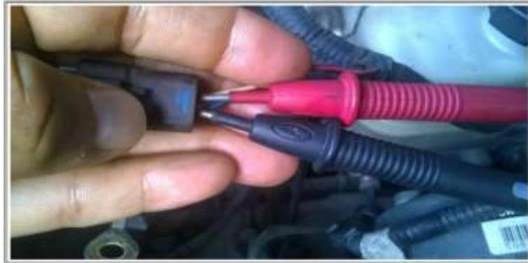
**FIGURA 26.** Medición de líneas de la válvula IMV
