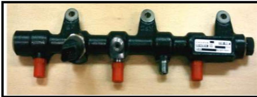
**FIGURA 11.** Detalle de riel común de sistema Common Rail Diesel Injection (CRDi) Delphi
