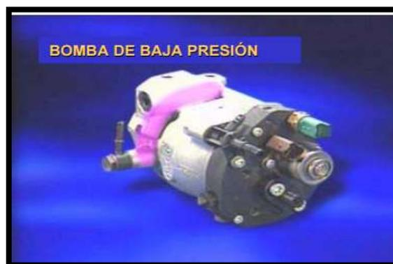
**FIGURA 9.** Descripción de bomba de baja presión sistema CRDI
