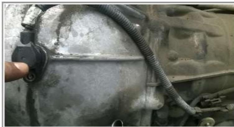
**FIGURA 37.** CKP, Sensor de posición del cigüeñal. Ubicación
