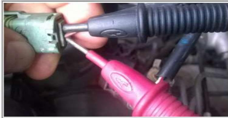
**FIGURA 29.** FTS, medición sensor de temperatura del combustible.
