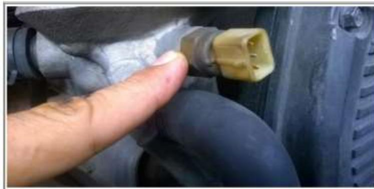
**FIGURA 47.** ECT, Ubicación del sensor de temperatura del refrigerante
