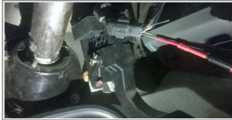
**FIGURA 44.** TPS, medición del sensor de posición del acelerador
