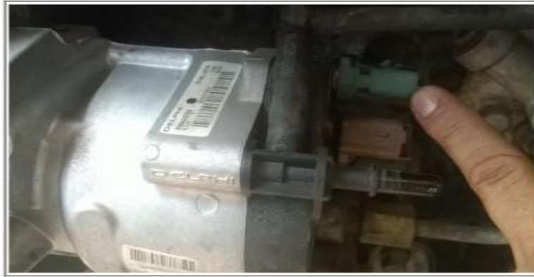
**FIGURA 28.** FTS, Ubicación del sensor de temperatura del combustible.
