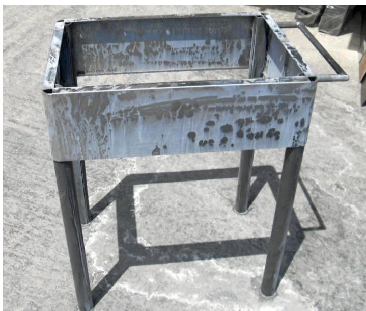
Figura 4.58 Mesa después del Baño de Fosfato
