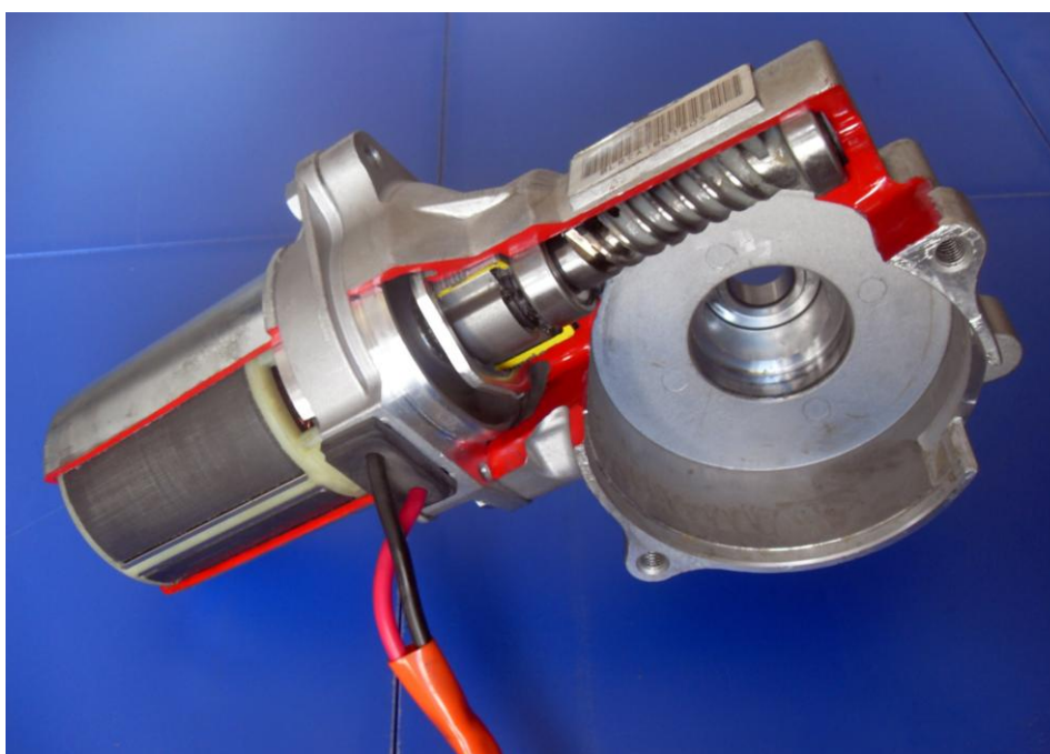
Figura 4.24 Motor Eléctrico del Sistema sin su Eje de Dirección
