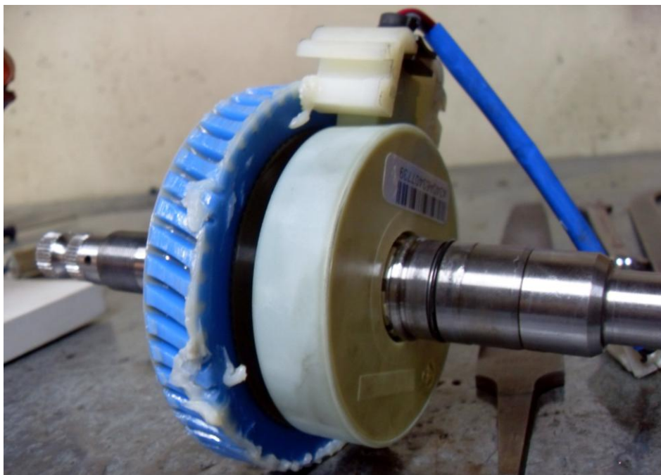
Figura 4.18 Eje de la Dirección montado sobre él la rueda dentada y el Sensor
