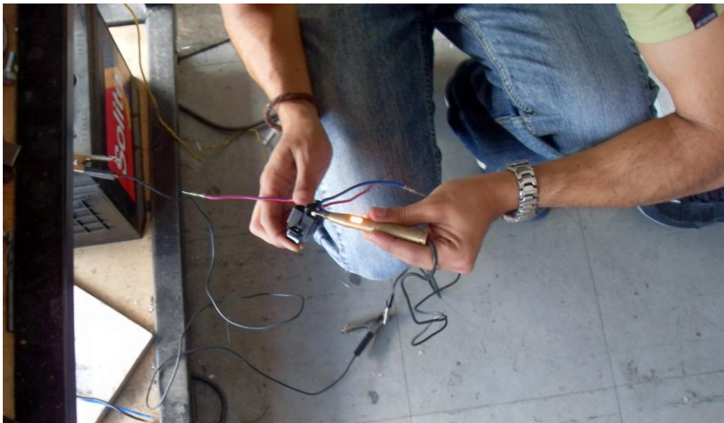
Figura 4.49 Pruebas Eléctricas del Interruptor Inversor con una punta lógica
