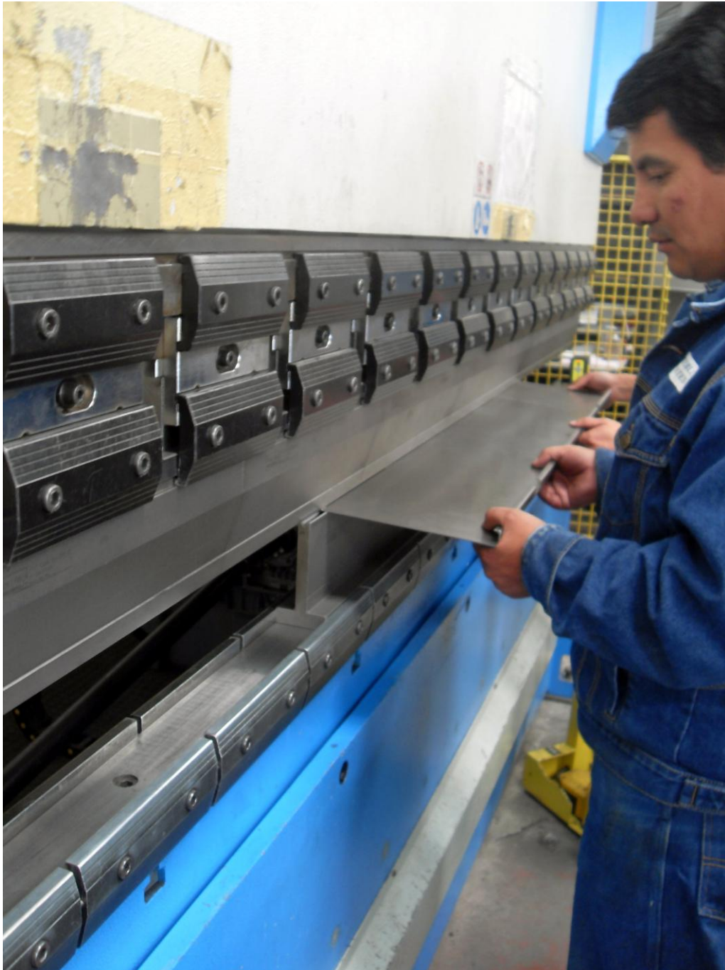
Figura 4.54 Doblado de la plancha en una prensadora
