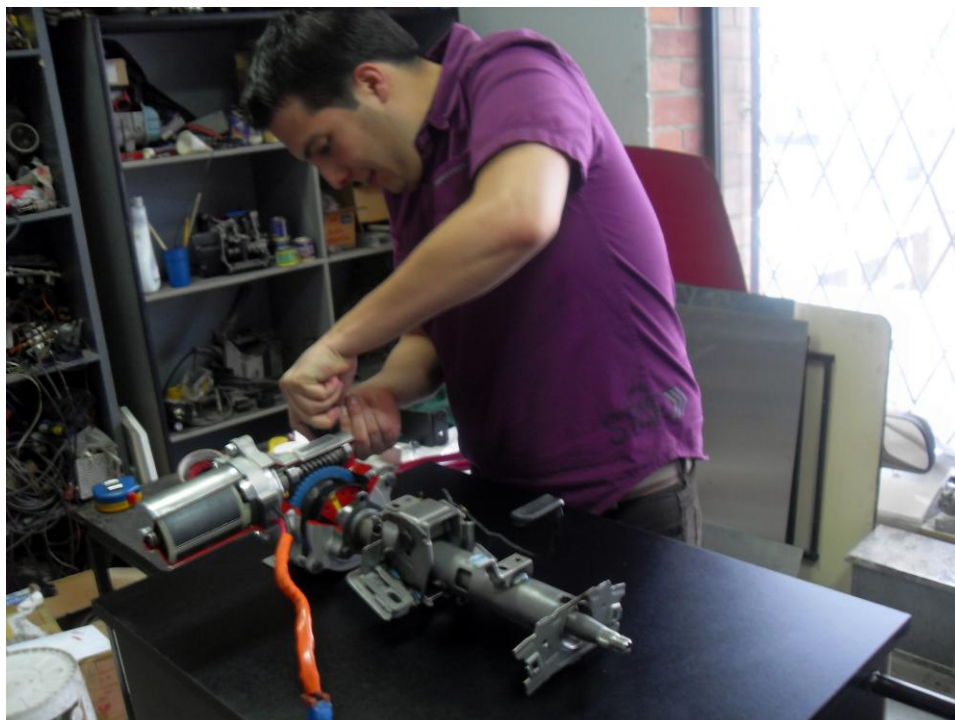
Figura 4.62 Fijación de la Dirección Electroasistida en el tablero
