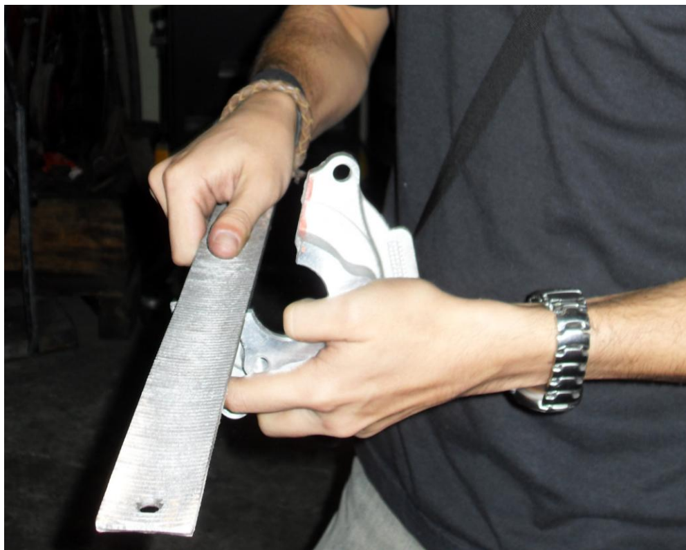
Figura 4.13 Limado de la carcasa
