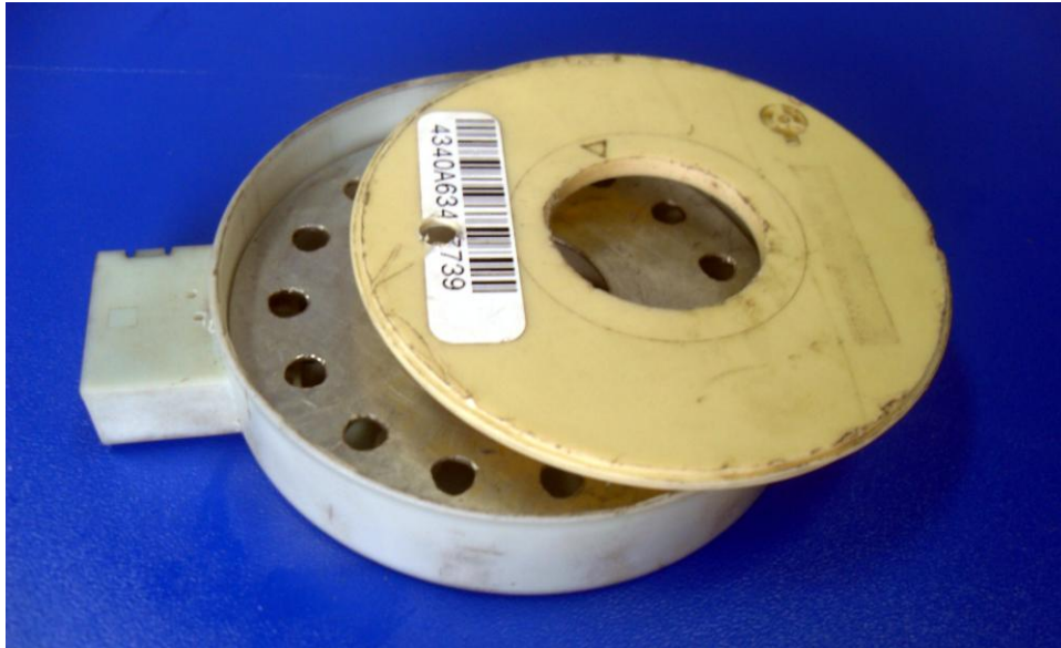
Figura 4.27 Nuevo Sensor con perforaciones con su Placa en el interior
