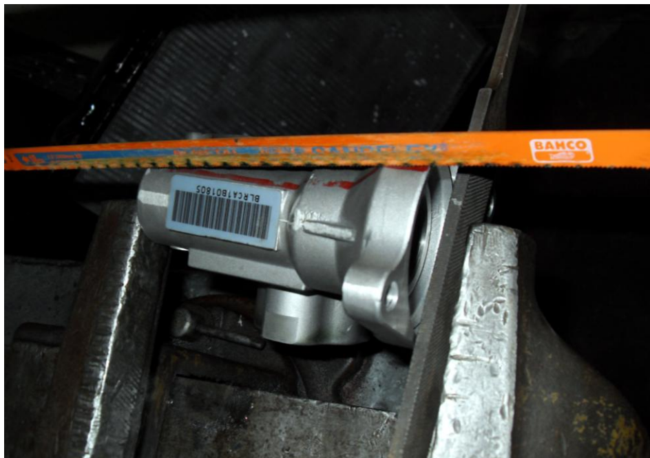
Figura 4.10 Señalización del corte
