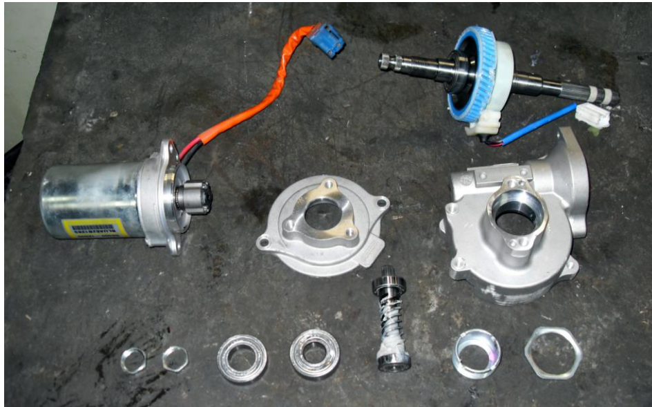
Figura 4.7 Despiece de la Dirección Electroasistida
