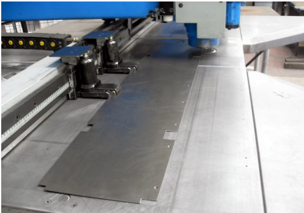
Figura 4.53 Plancha para formar el costado del tablero
