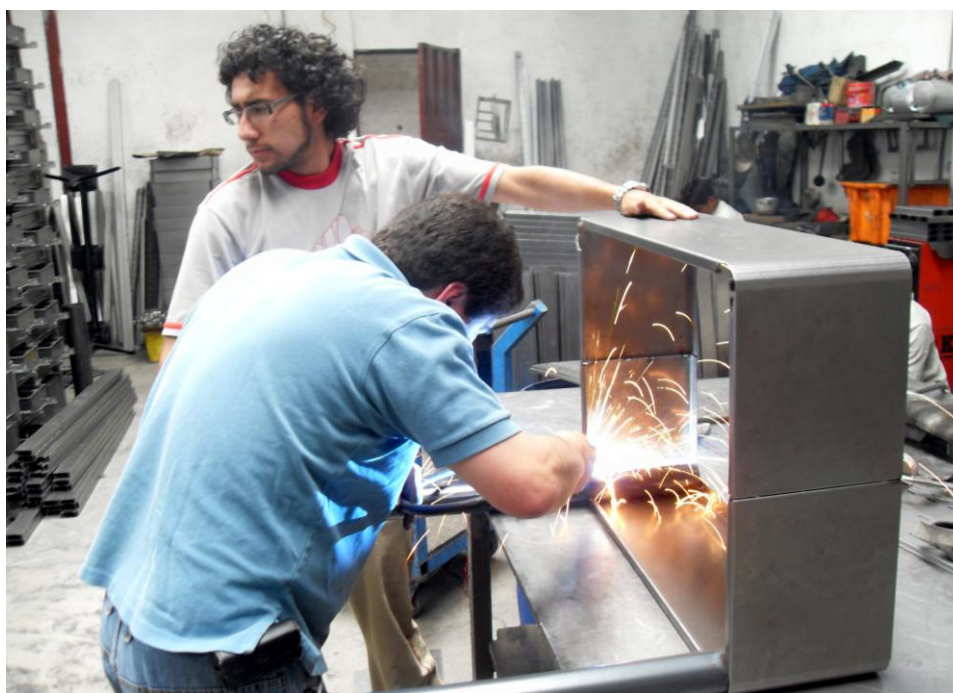
Figura 4.56 Fijación con suelda Mig de las patas de la mesa en la plancha
