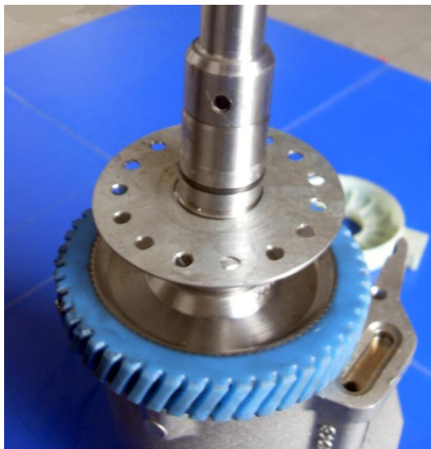
Figura 4.23 Lugar donde va posicionada la Placa del Nuevo Sensor
