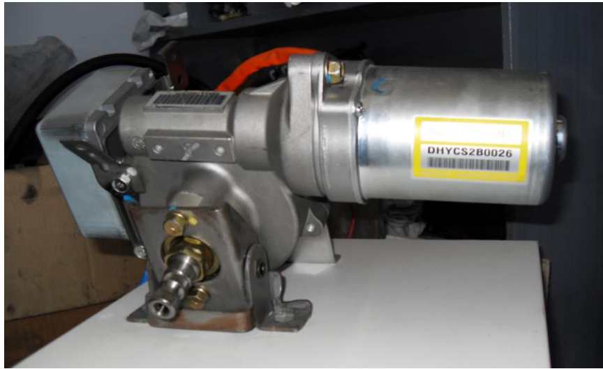
Figura 4.1 Sistema de Dirección Electroasistida
