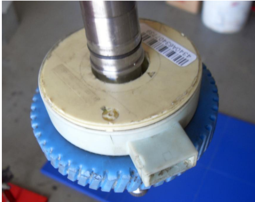
Figura 4.19 Vista Superior de la Sensor de Torque
