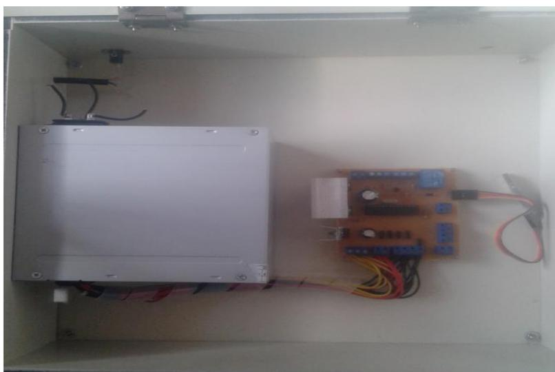
Figura 4.22. Placa y fuente de alimentación colocadas en la caja para el circuito de control
