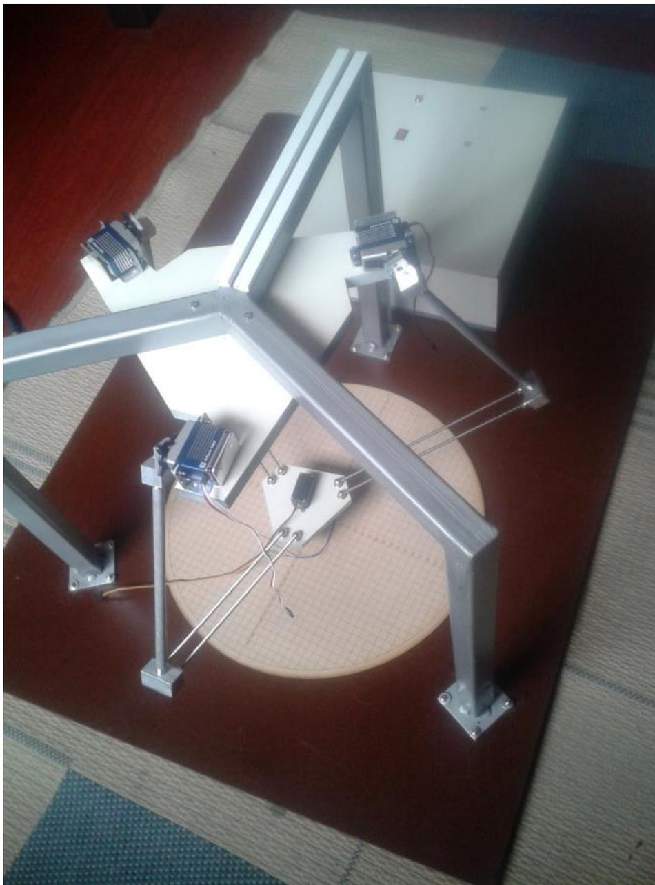
Figura 4.20. Estructura mecánica completa del robot
