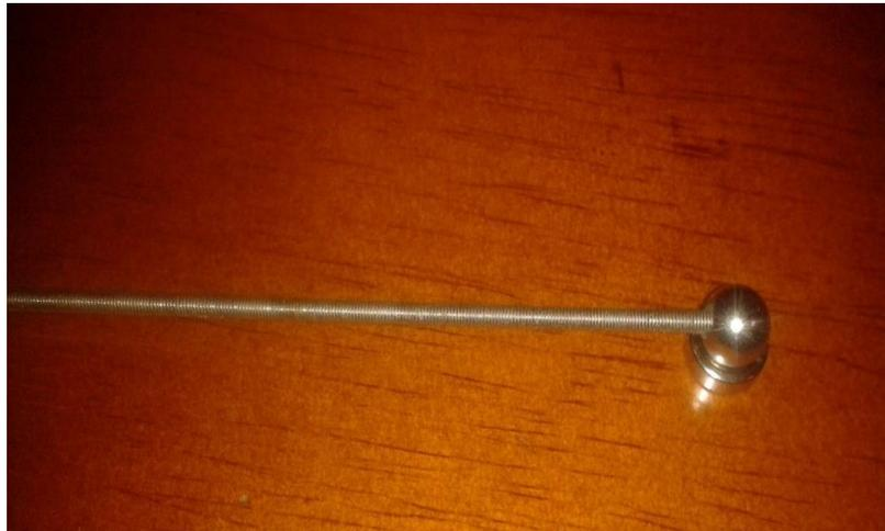
Figura 4.6. Junta de varilla con su juntura rotacional
