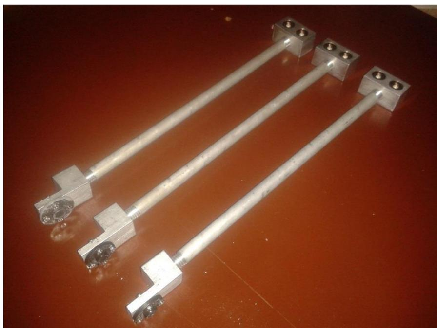
Figura 4.3. Ensamble de la parte superior del brazo del robot
