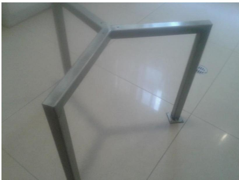
Figura 4.16. Estructura de trípode del robot delta
