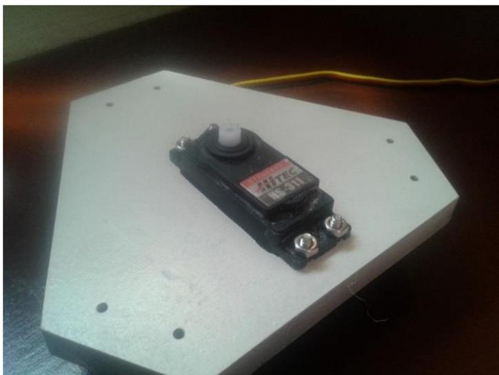
Figura 4.11. Servomotor colocado en la base inferior del robot
