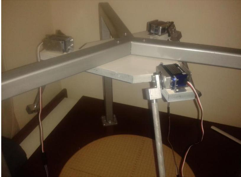
Figura 4.18. Base superior del robot colocada en la estructura
