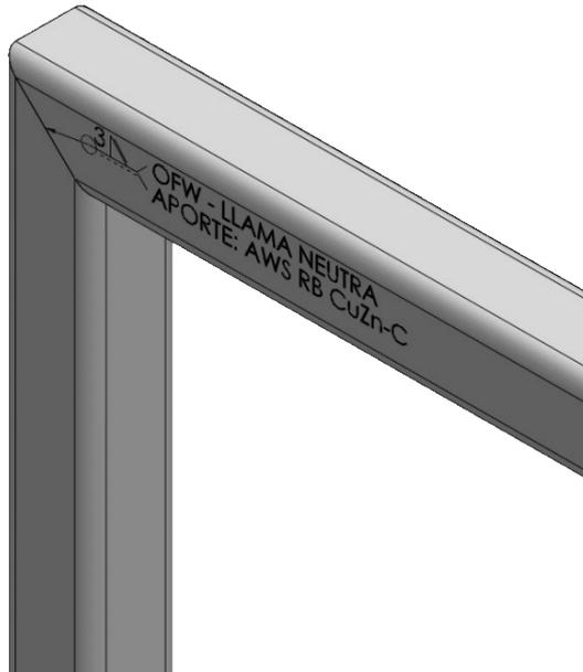
Figura 3.31. Cordón de soldadura en la esquina de la estructura
