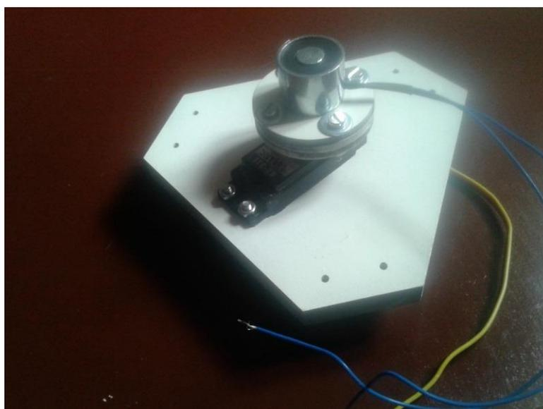
Figura 4.12. Electroimán colocado en la base inferior del robot
