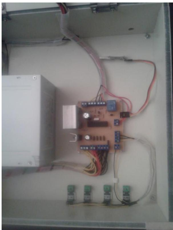
Figura 4.23. Sensores de corriente montados en la caja del circuito de control
