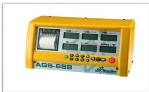
Figura 2: Analizador de Gases Brainbee
