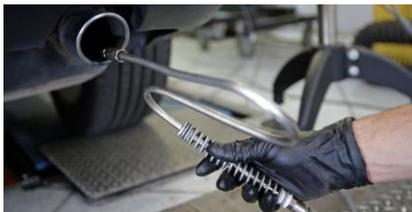
Figura 3: Instalación Sonda en sistema de Escape
