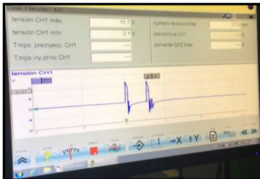
Figura 16. Onda del primer inyector
