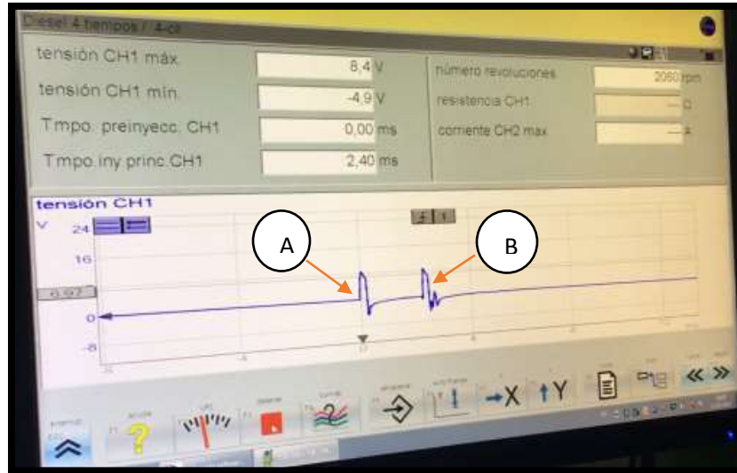
Figura 32. Onda del Tercero inyector, A preinyección, B inyección principal
