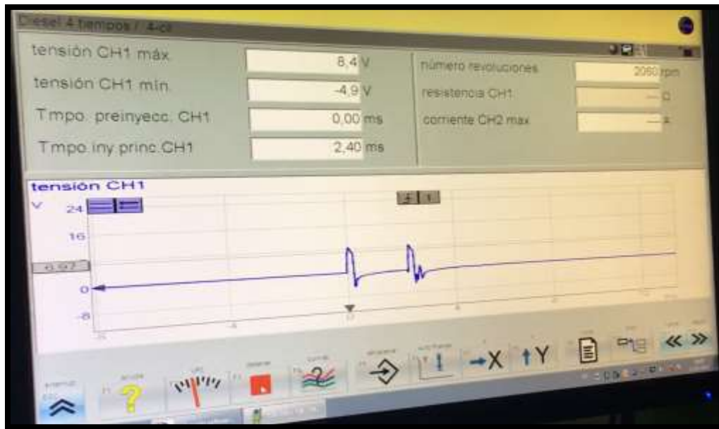
Figura 26. Onda del tercer inyector
