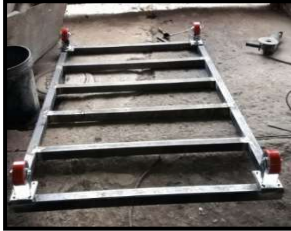
Figura 24: Instalación de ruedas
