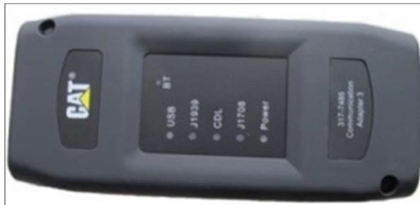
**Figura 65:** Interfaz de Comunicación Caterpillar Adapter III
