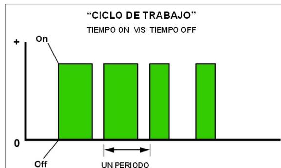
**Figura 33:** Modulación de pulso de ancho
