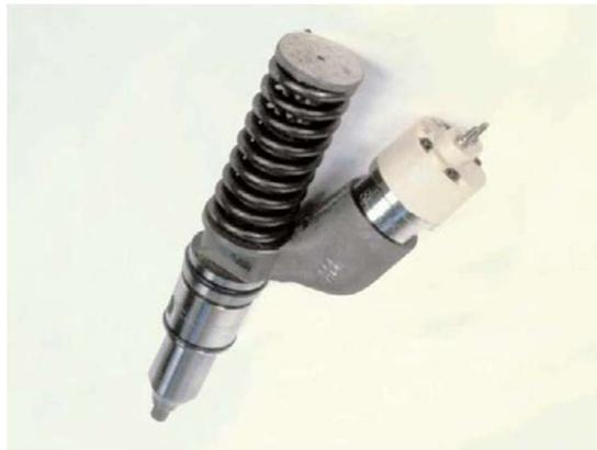
**Figura 51:** Solenoide del inyector de combustible
