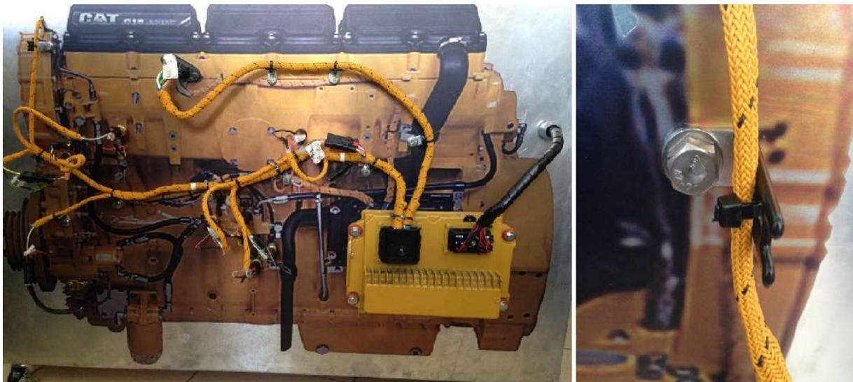
**Figura 138:** Instalación y aseguramiento de harness de motor
