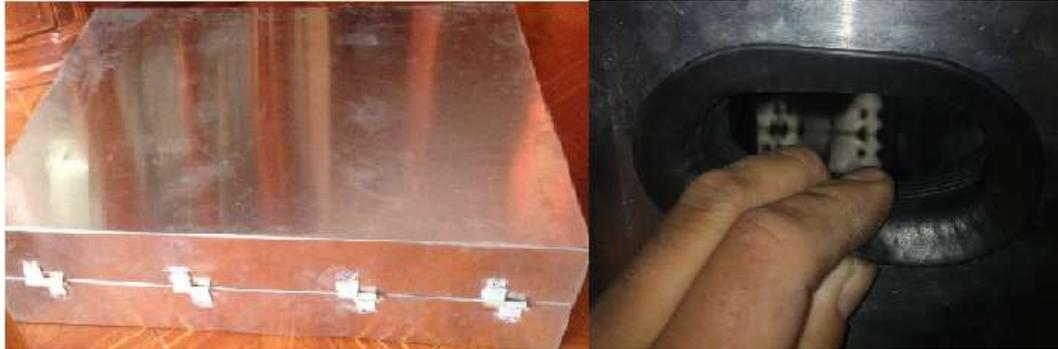
**Figura 104:** Instalación de bisagras y gomas
