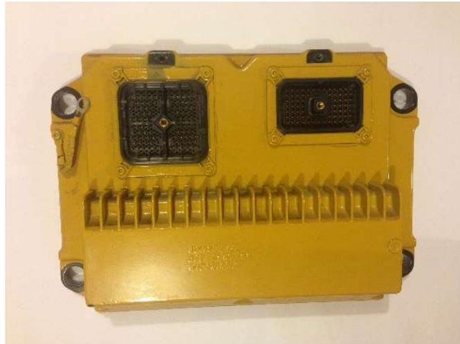
**Figura 126:** Módulo de control electrónico ADEM A4
