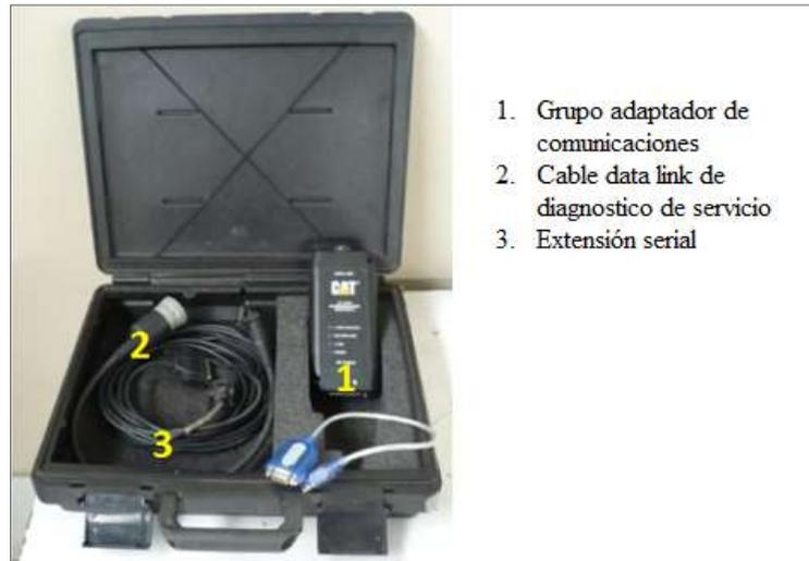
**Figura 68:** Conjunto de Adaptador de Comunicaciones III
