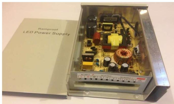
**Figura 90:** Fuente de alimentación Rainproof 24V DC
