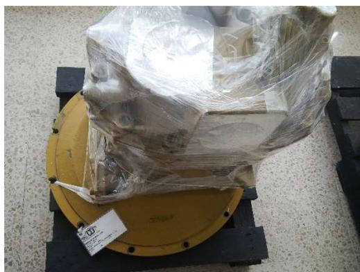
Fotografía 21. Bomba hidráulica de excavadora 330D.
