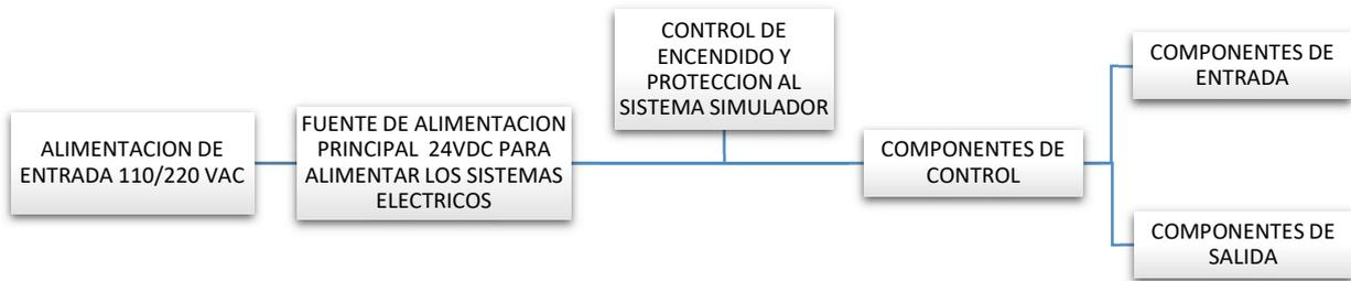
**Figura 89:** Diagrama en bloques de la alimentación y protección de la fuente
