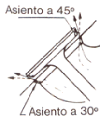
Figura 182. Comparación del paso de la mezcla con los tipos de ángulos del asiento a 45 y 30 grados.
