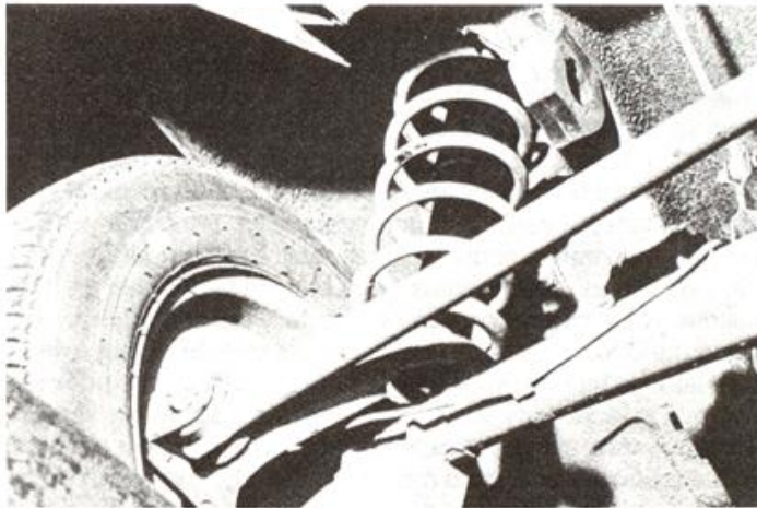
Figura 211. Parte de la suspensión de la rueda trasera de un coche mostrando su muelle helicoidal.
