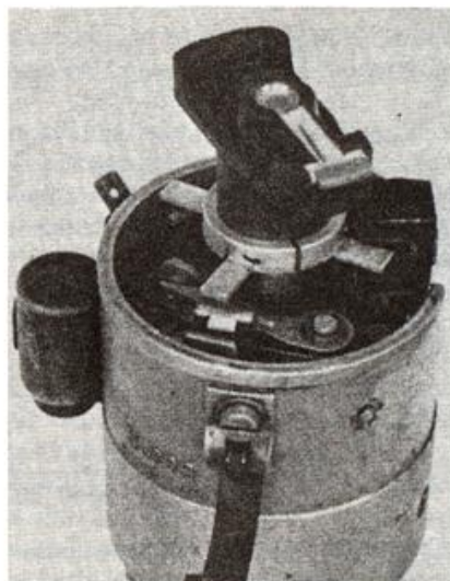
Figura 143. Ahora puede verse ya como se ha colocado la rueda polar, de cuatro polos, que pasan sucesivamente por el captador magnético.
