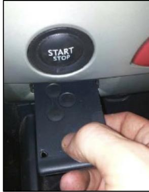
**Figura 2.42.** Inmovilizador Por Tarjeta Transponder.
