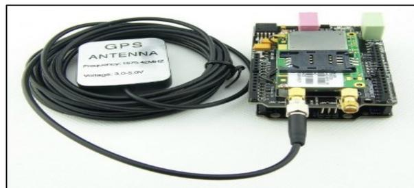
**Figura 2.36.** Módulo SIM908, Antena-Receptor GPS.
