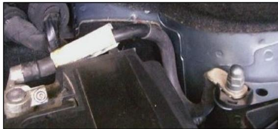
**Figura 2.10.** Conexión Batería-Chasis.
