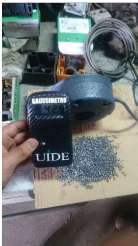
Figura 4.9 Medición de radiación con medio de limadura de acero a 5cm
