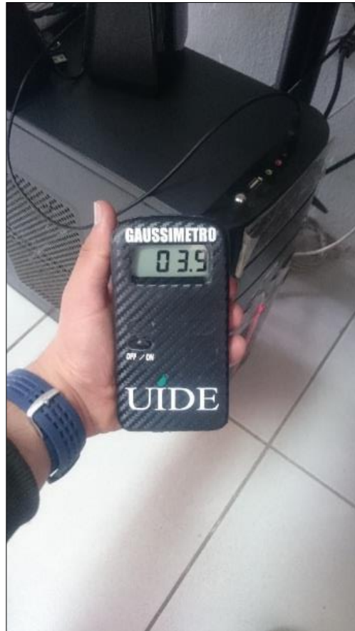
Figura 4.1 Medición de radiación en un computador de escritorio
