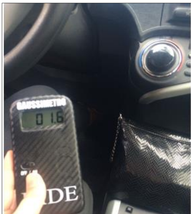
Figura 4.21 Medición en el cuerpo del piloto a una velocidad de 40 km/h
