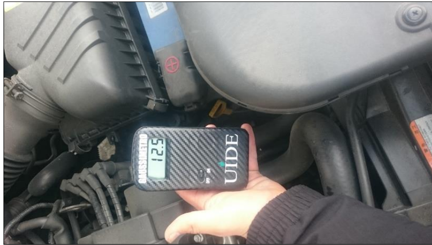
Figura 4.11 Medición en los cables de batería con el vehículo en ralentí
