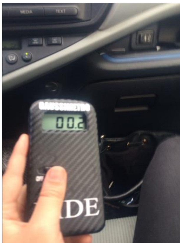
Figura 4.20 Medición en el cuerpo del copiloto a una velocidad de 20km/h.
