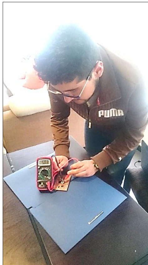
Figura 3.23 Medición del voltaje de alimentación del sensor hall
