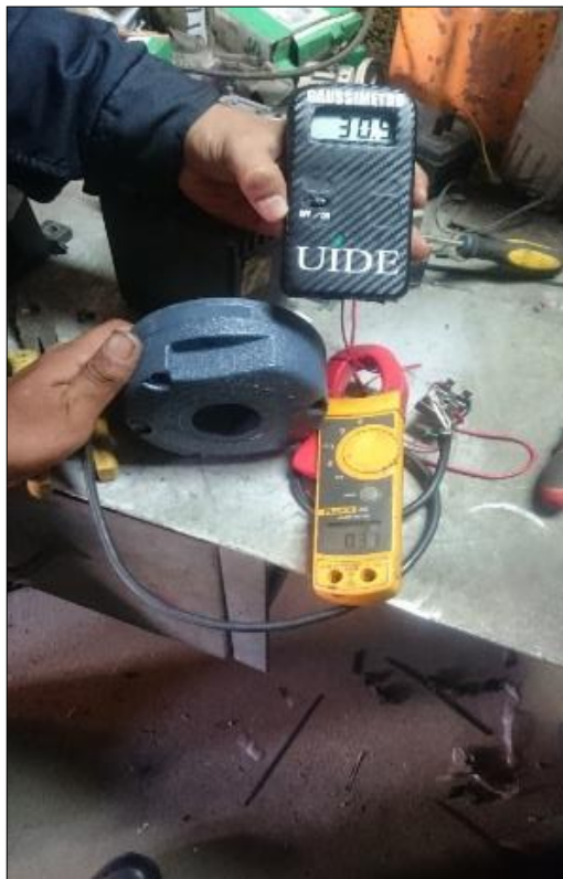
Figura 4.6 Medición de campo en la bobina
