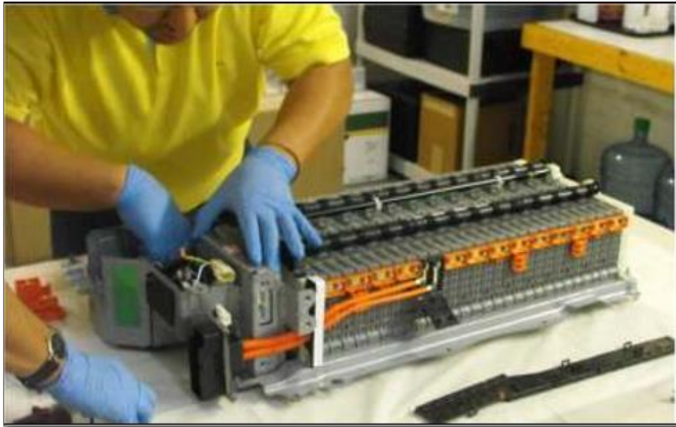
Figura 2.13 Conjunto de Baterías de alta tensión
