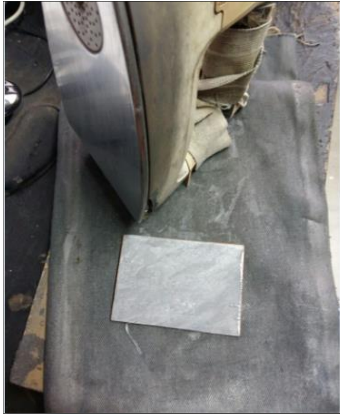
Figura 3.9 Hoja de transferencia puesta en la placa madre
