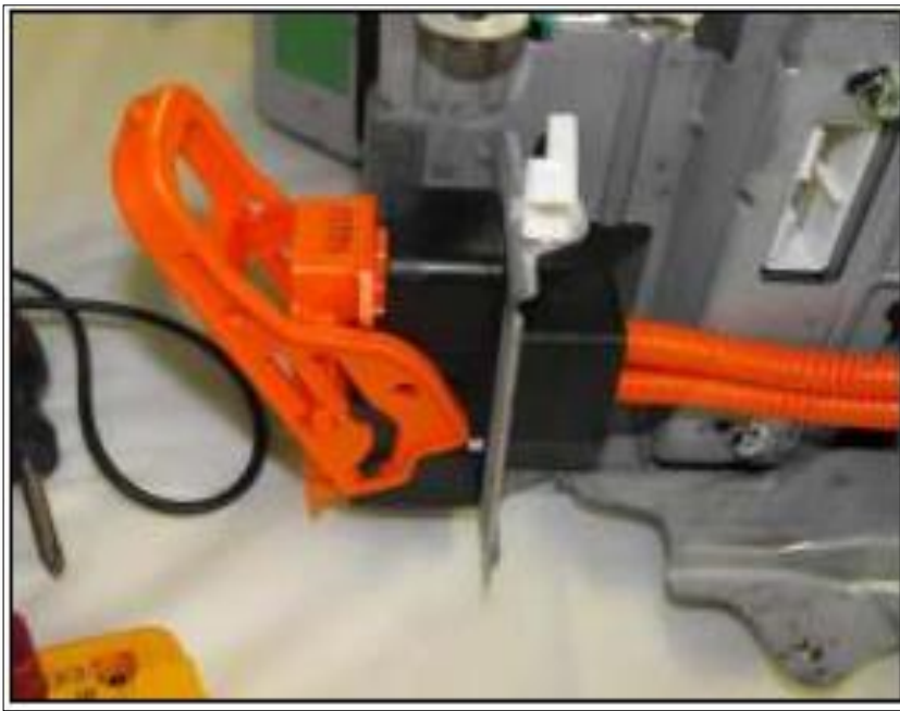
Figura 2.16 Jumper de Seguridad
