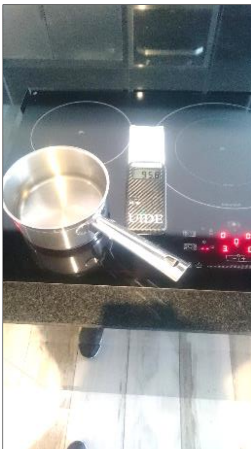
Figura 4.5 Medición de radiación en una cocina de inducción
