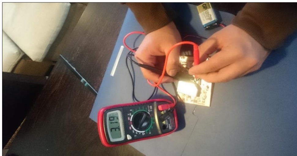
Figura 3.26 Medición de voltaje de salida con mayor campo detectado
