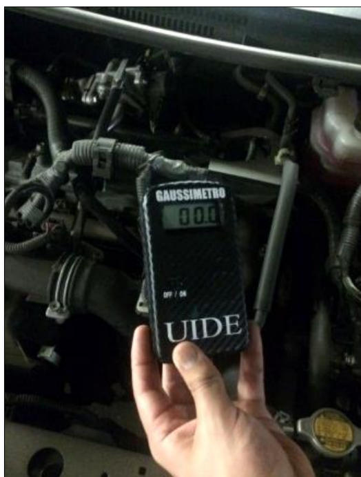
Figura 4.16 Medición en el motor del con el vehículo apagado
