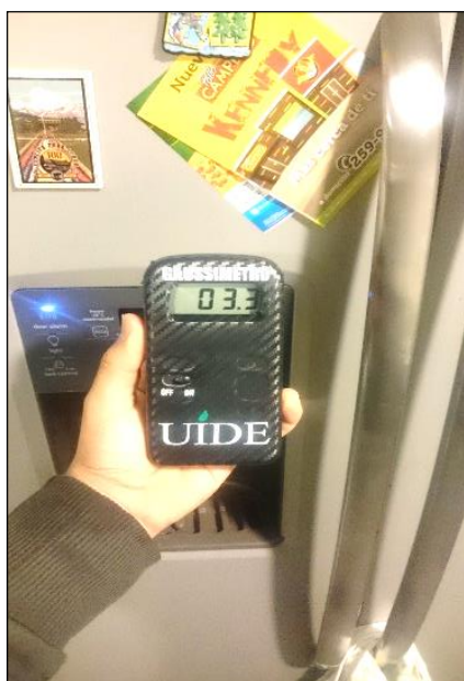
Figura 4.3 Medición de radiación en un refrigerador
