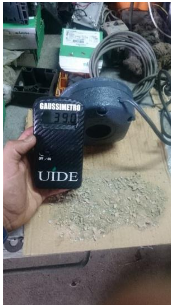
Figura 4.8 Medida de campo con medio de ceniza a distancia de 3cm
