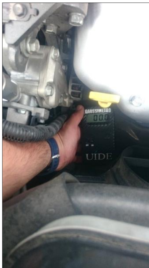
Figura 4.10 Medición en el alternador con el vehículo apagado
