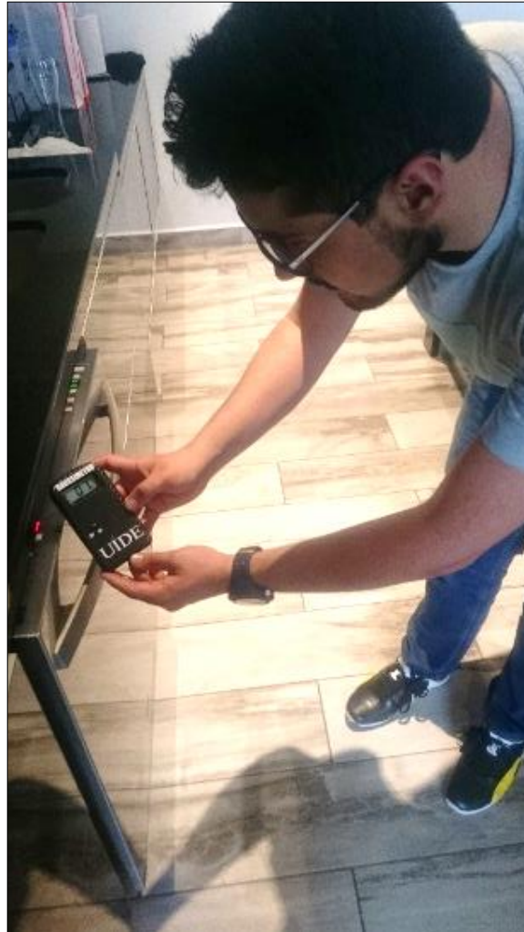
Figura 4.4 Medición de radiación en una lavadora de platos
