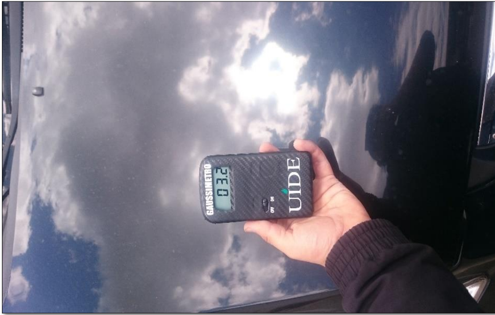
Figura 4.13 Medición de radiación con el capó cerrado
