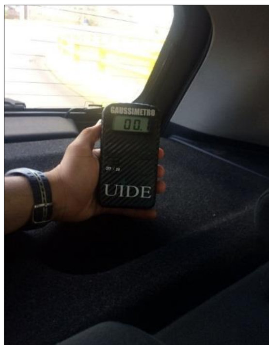
Figura 4.18 Medición en la cabina posterior con el vehículo en ralentí
