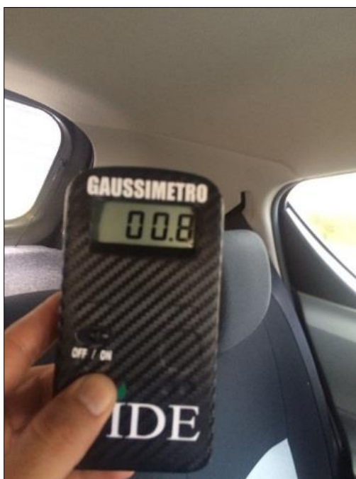
Figura 4.22 Medición en la cabina posterior a 40 km/h
