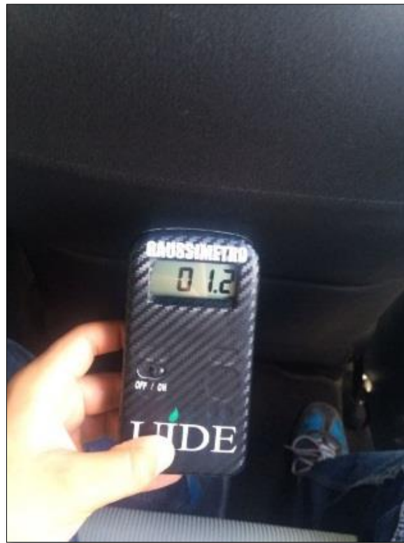
Figura 4.23 Medición en la cabina posterior a una velocidad de 60 km/h
