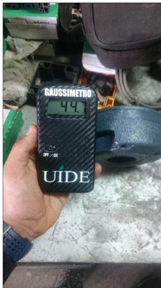
Figura 4.7 Medida de campo en la bobina a una distancia de 3cm
