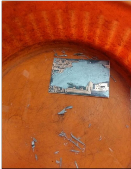
Figura 3.12 Retiro del papel de transferencia de la placa madre
