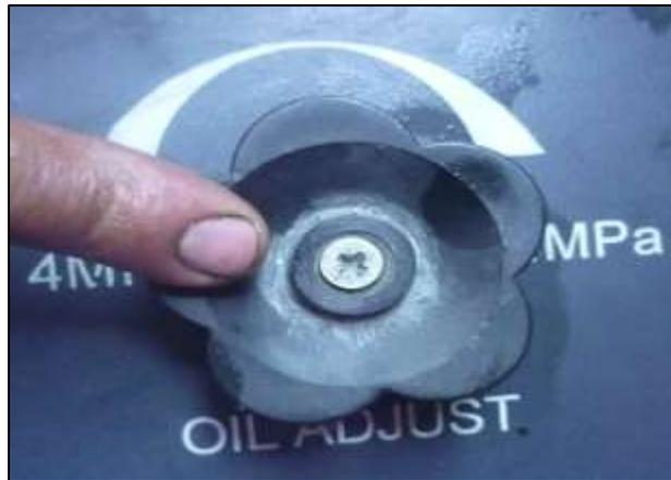
Figura. 56 Válvula ajustable de presión del banco de calibración
