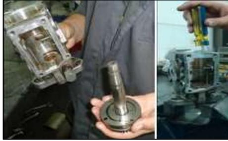
Figura. 39 Montaje de la bomba de alimentación
