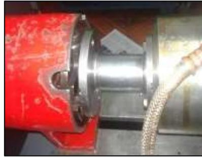
Figura. 22 Acople bomba-motor
