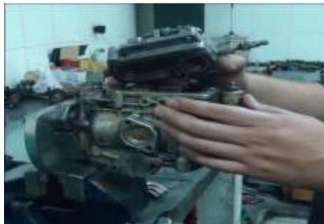
Figura. 32 Desmontaje de la tapa del gobernador
