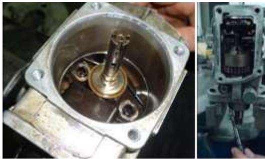
Figura. 45 Montaje de la palanca del gobernador
