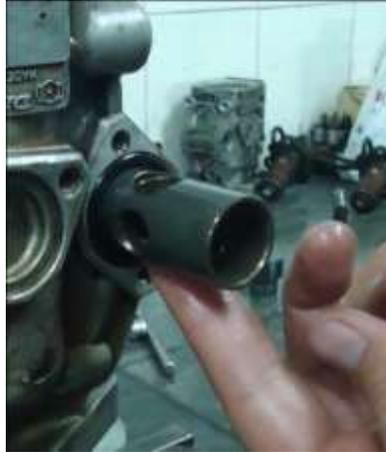
Figura. 42 Montaje del pistón de avance.
