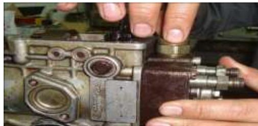
Figura. 48 Montaje del solenoide
