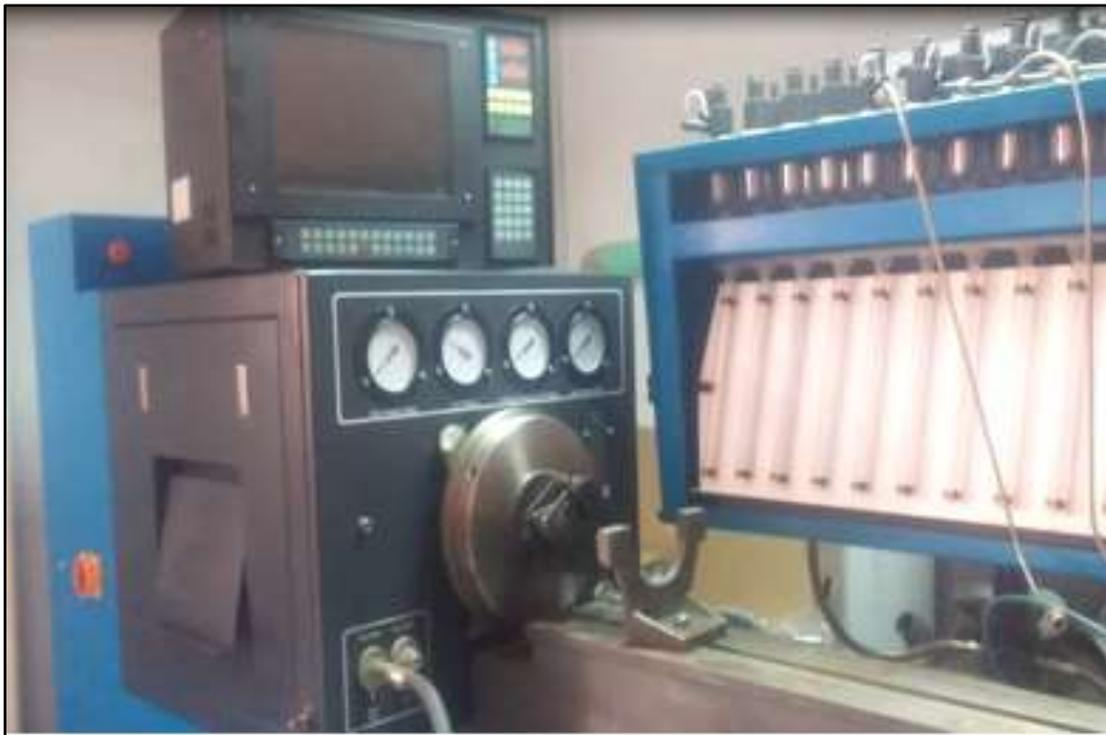
Figura. 19 Banco de calibración COM EMC
