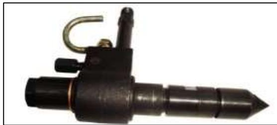
Figura. 25 Inyector de pruebas
