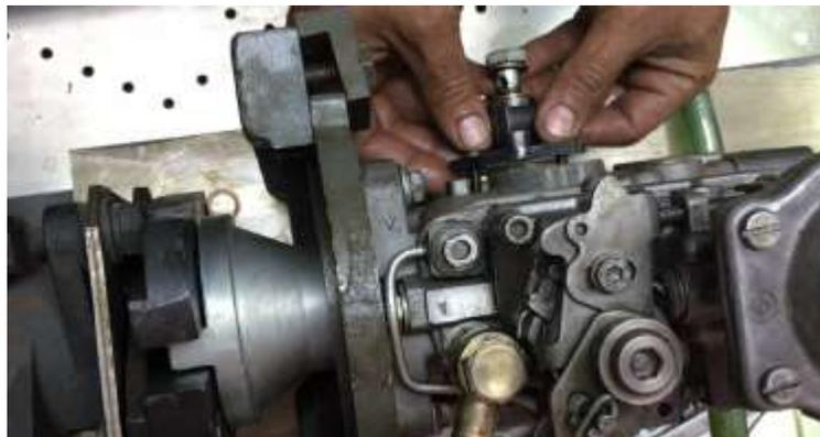
Figura. 53 Instalación del acople para la presión de transferencia.
