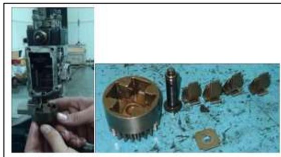
Figura. 33 Desmontaje de la tapa del gobernador
