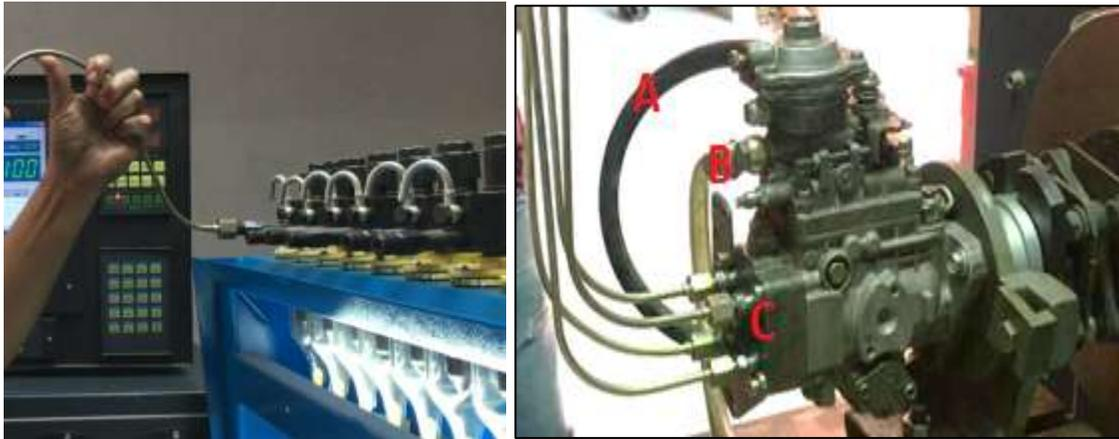
Figura. 52 Instalación de cañerías a los inyectores y colocación de cañerías de entrada y retorno de combustible.
