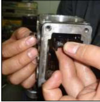
Figura. 44 Montaje de la palanca del gobernador
