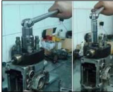
Figura. 34 Desmontaje del tapón y válvulas.
