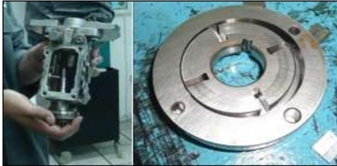
Figura. 38 Desmontaje de la boba de alimentación
