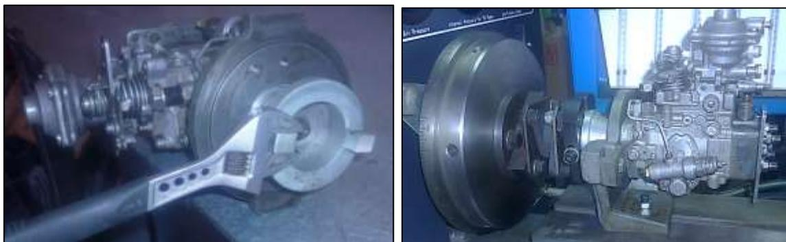
Figura. 51 Colocación de bases y montaje en el banco de pruebas
