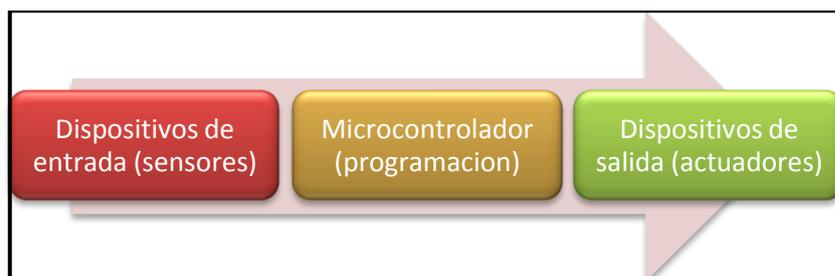
**Figura N° 2. 19** Control mediante microprocesadores.
