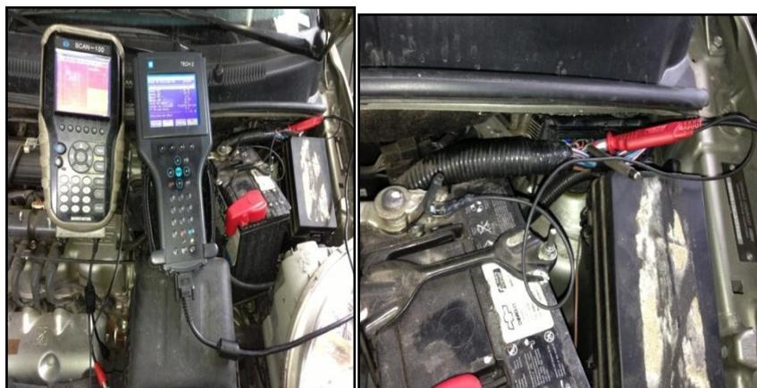
**Figura N° 3. 10** Obtención de la frecuencia del sensor de velocidad
