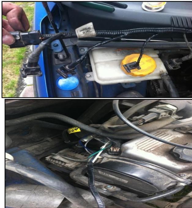
**Figura N° 3. 8** Conexión de cableado con inyectores 2 y 3.
