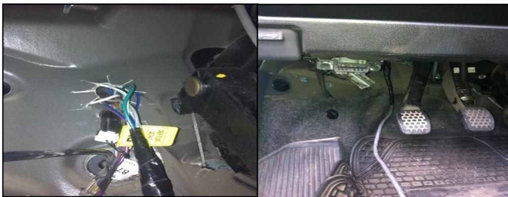
**Figura N° 3. 6** Instalación de cableado del habitáculo del motor hacia el habitáculo de los pasajeros.
