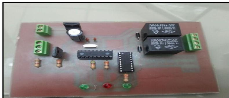
**Figura N° 3. 16** Limitador de Velocidad.
