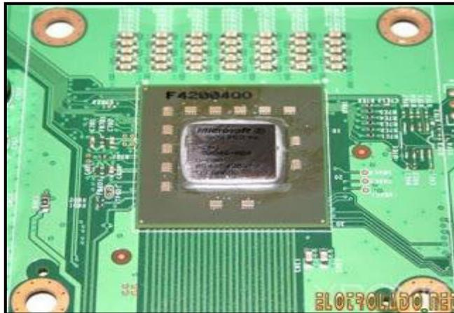
**Figura N° 2. 18** Microprocesador
