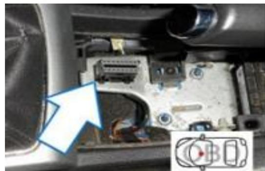
**Figura 1:** Ubicación de conector OBDII
