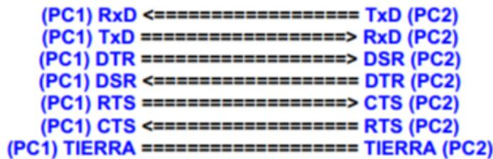
(Figura 2.15 – Líneas de comunicación de un bus de comunicación serial)<sup>[2,20]</sup>
