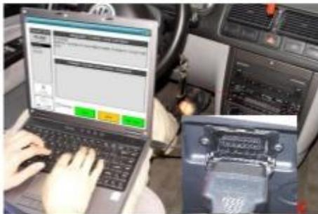
En la figura un escáner interface con PC y DLC
