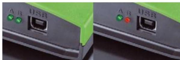
Indicadores luminosos de estado en la carcasa del KTS
