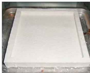
Una vez establecidas las características del proceso, se pasó a la elaboración de moldes en placa de acero de 4mm de espesor, conformando cajonetas de 5x5cm de espacio interior, con sus respectivas tapas y bases, las cuales servirán para la primera elaboración de pruebas obteniendo piezas de 5x5cm y 0.5 cm de espesor.
