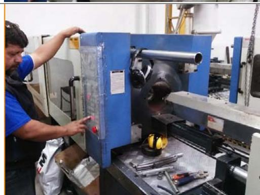
El ingreso de material a la extrusora es constatado a través de la visera de control.
