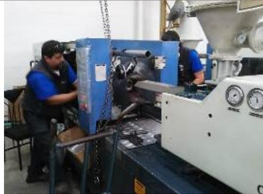
El acople del molde es un proceso arduo y pesado por lo que se necesita de varias personas y de la ayuda de un tecele mecánico que facilite el elevar el molde hasta el espacio requerido. Las uniones se realizan con pernos acerados de media pulgada que aseguran la pieza y dan seguridad al proceso.
