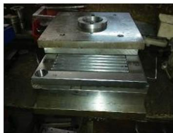
La elaboración de los moldes de placa metálica, se realiza mediante corte por prensa hidráulica y soldadura por arco voltaico, mientras que el molde para producción en serie se fabrica mediante el mecanizado sobre una pieza de acero sólida, utilizando una fresadora computarizada de precisión.
