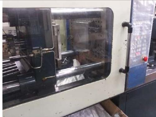
Dentro del proceso se utiliza desmoldaste, para este caso en específico, vaselina en aerosol, con la finalidad de facilitar la extracción de la pieza del molde. Evitando daños al material y acelerando procesos.
