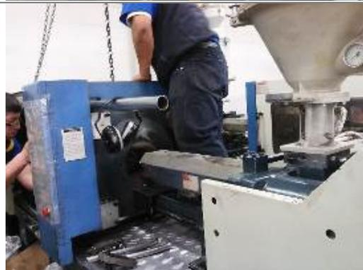
Posteriormente se procede a la introducción de material plástico reciclado y triturado, a la tolva de alimentación en la cual se distribuirá con los aditivos, para posteriormente pasar a la fundición e inyección.
