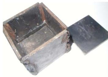
Una vez obtenidas las pruebas preliminares, se realizara los moldes para la realización de ensayos a escala 1:1 dentro de los cuales se presentara dos tipos diferentes de molde según su característica de producción, primeramente un molde dedicado al proceso de ensayo manual elaborado en placa de 4mm que permitirá elaborar piezas de 20x20cm.
