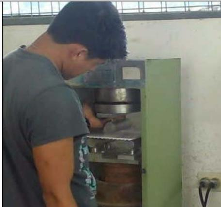
Generar carga de presión sobre la muestra a través del rodillo central para provocar el fallo del material.
