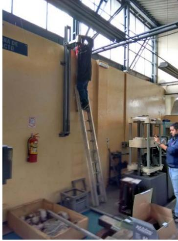
**Figura 3.6:** Soporte para caída de esfera de acero (caída de 4 metros).
