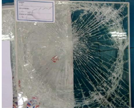
**Figura 3.52:** Impacto con cabeza de maniquí probeta número 4 fabricante Z.
