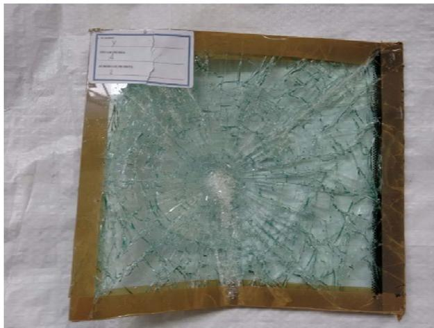
**Figura 3.15:** Impacto con esfera de acero fabricante Y (probeta 2).
