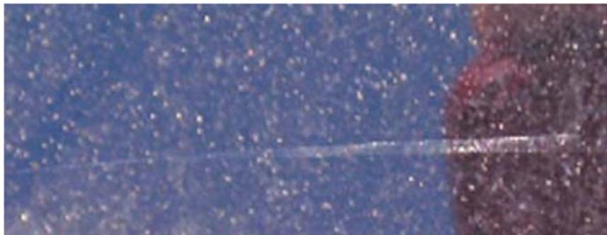
**Figura 1.11:** Desgaste superficial del parabrisas.
