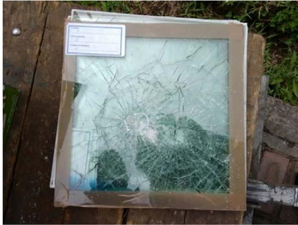
**Figura 3.29:** Probeta número 1 del fabricante Y después de ser impactada.
