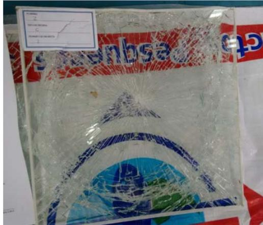
**Figura 3.50:** Impacto con cabeza de maniquí probeta número 2 fabricante Z.
