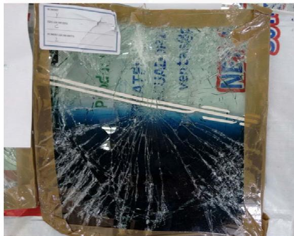
**Figura 3.46:** Impacto con cabeza de maniquí probeta número 2 fabricante Y.
