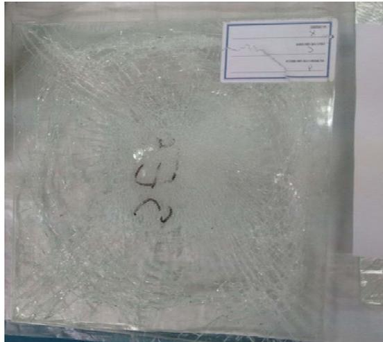
**Figura 3.44:** Impacto con cabeza de maniquí probeta número 4 fabricante X.
