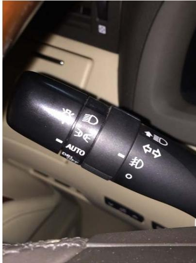
**Figura 1.17:** Posición de accionamiento de luces automáticas Lexus RX 450h.
