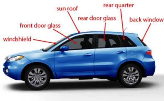
**Figura 1.15:** Tipos de cristales del automóvil.
