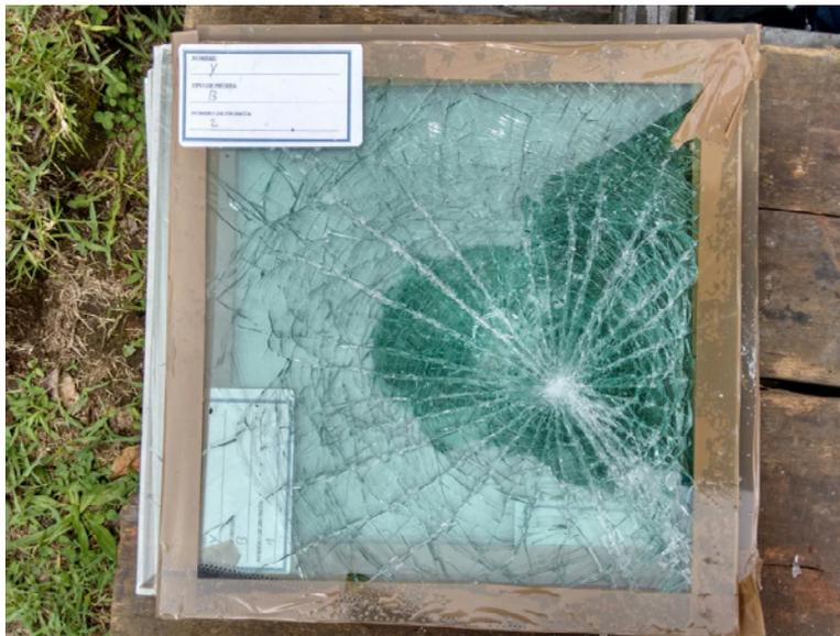
**Figura 3.30:** Probeta número 2 del fabricante Y después de ser impactada.
