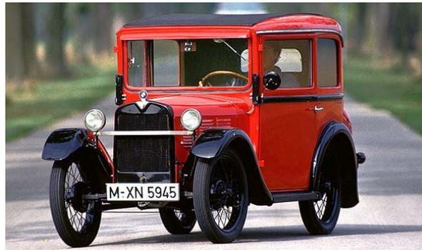
**Figura 1.3:** BMW DIXI 3-15 primer vehículo en contar con un parabrisas templado
