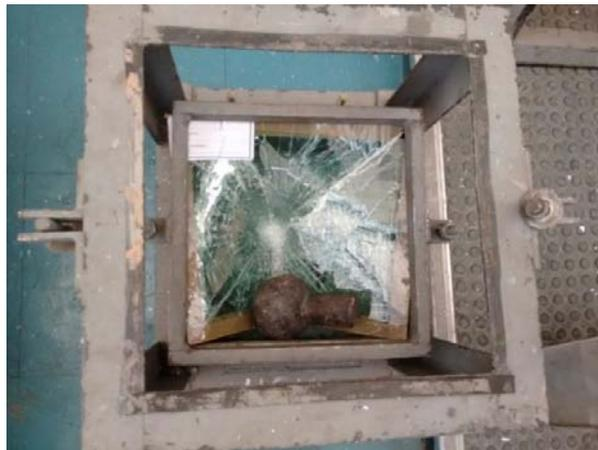
**Figura 3.13:** Ensayo de impacto con esfera de acero (Fabricante Y).
