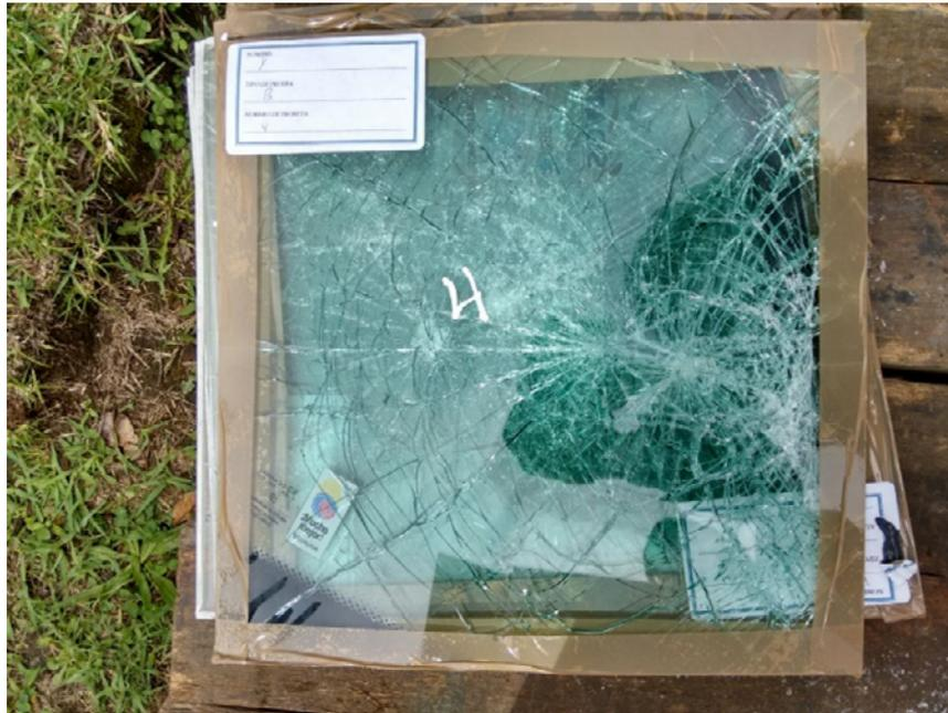
**Figura 3.32:** Probeta número 4 del fabricante Y después de ser impactada.
