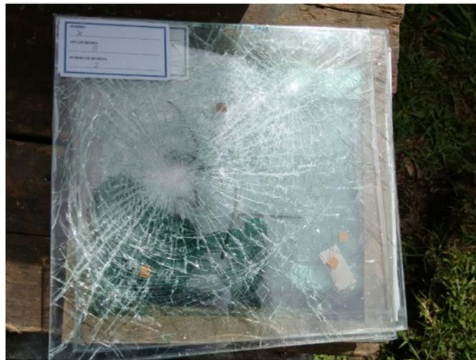
**Figura 3.26:** Probeta número 2 del fabricante X después de ser impactada.
