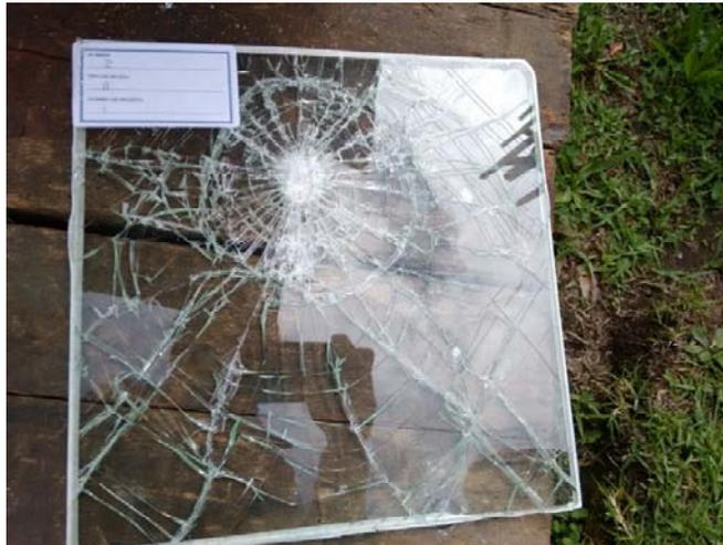
**Figura 3.34:** Probeta número 1 del fabricante Y después de ser impactada.
