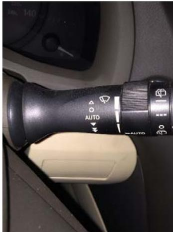
**Figura 1.16:** Posición de accionamiento automático de limpiaparabrisas Lexus RX 450h.
