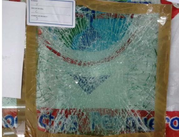
**Figura 3.47:** Impacto con cabeza de maniquí probeta número 3 fabricante Y.
