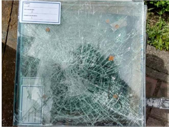
**Figura 3.27:** Probeta número 3 del fabricante X después de ser impactada.
