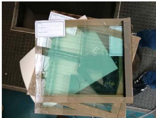
**Figura 3.12:** Probeta lista para ensayo de impacto con esfera (Fabricante Y).
