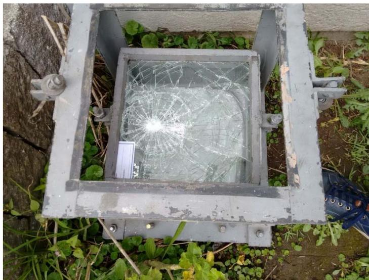
**Figura 3.33:** Probeta impactada por el dardo.
