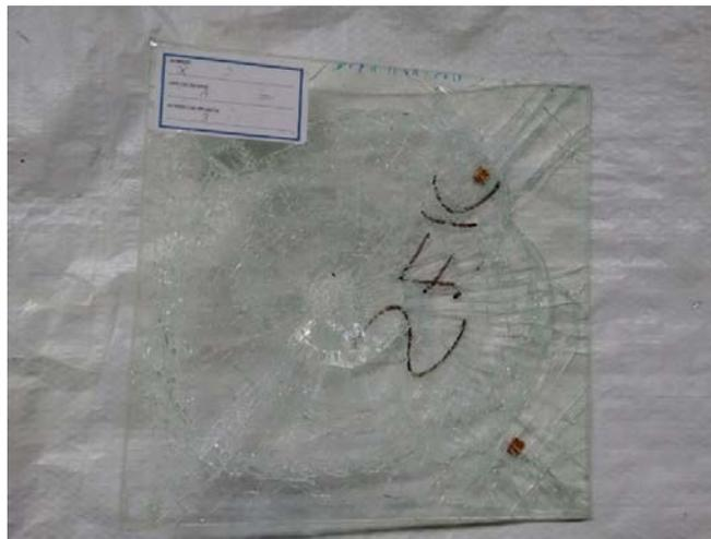
**Figura 3.10:** Probeta número 3 del fabricante X después del impacto.
