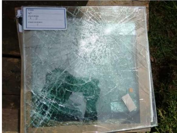
**Figura 3.25:** Probeta número 1 del fabricante X después de ser impactada.
