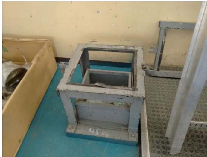
**Figura 3.3:** Soporte para ensayos de impacto.
