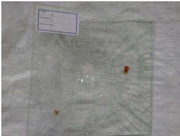
**Figura 3.8:** Probeta número 1 del fabricante X después del impacto.
