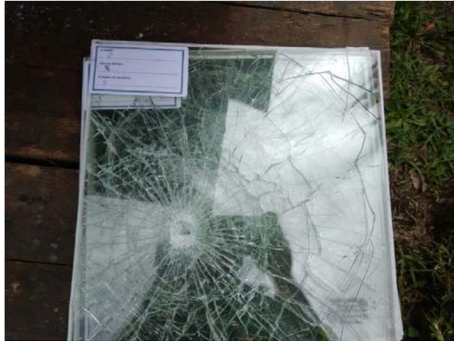
**Figura 3.37:** Probeta número 3 del fabricante Z después de ser impactada.
