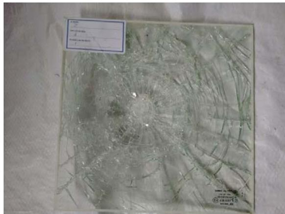
**Figura 3.20:** Probeta número 1 del fabricante Z, después de ser impactada.
