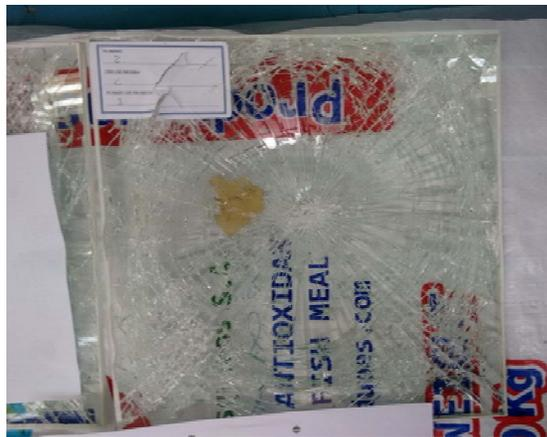
**Figura 3.51:** Impacto con cabeza de maniquí probeta número 3 fabricante Z.
