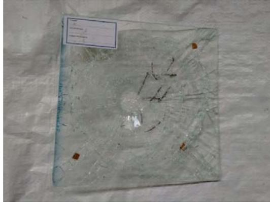
**Figura 3.11:** Probeta número 4 del fabricante X después del impacto.
