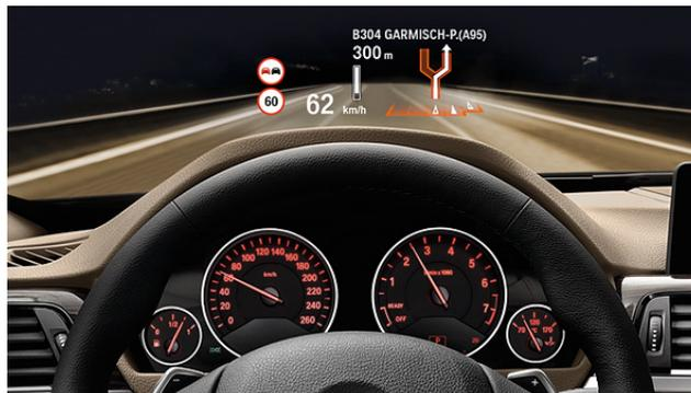
**Figura 1.21:** Visualización de la Head up display.
