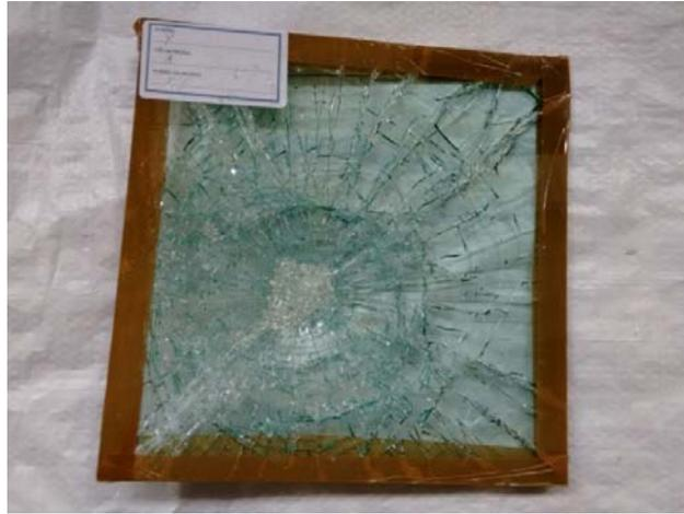
**Figura 3.14:** Impacto con esfera de acero fabricante Y (probeta 1)
