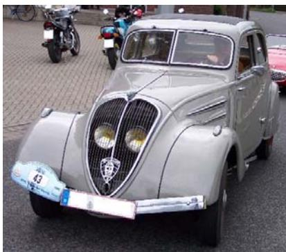
**Figura 1.4:** Peugeot 402 1935; su parabrisas es curvo por el tipo de carrocería.
