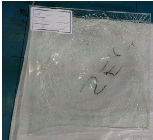
**Figura 3.41:** Impacto con cabeza de maniquí probeta número 1 fabricante X.
