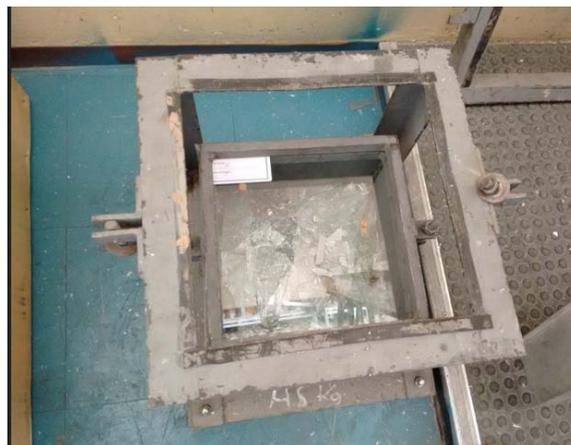
**Figura 3.38:** Soporte para probetas.
