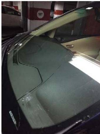
**Figura 1.24:** Daño en el parabrisas, agravado por la temperatura de Quito.
