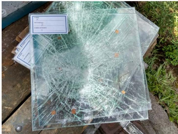
**Figura 3.28:** Probeta número 4 del fabricante X después de ser impactada.
