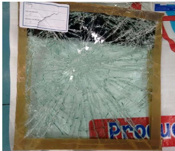
**Figura 3.48:** Impacto con cabeza de maniquí probeta número 4 fabricante Y.
