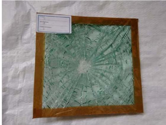
**Figura 3.16:** Impacto con esfera de acero fabricante Y (probeta 3).
