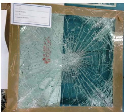
**Figura 3.45:** Impacto con cabeza de maniquí probeta número 1 fabricante Y.
