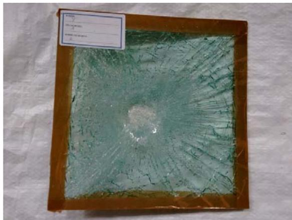
**Figura 3.17:** Impacto con esfera de acero fabricante Y (probeta 4).
