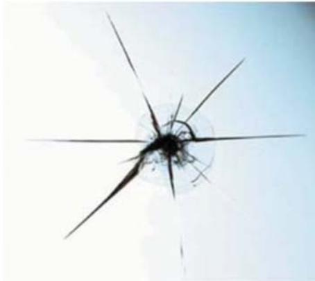
**Figura 1.14:** Rotura con grieta en el parabrisas.
