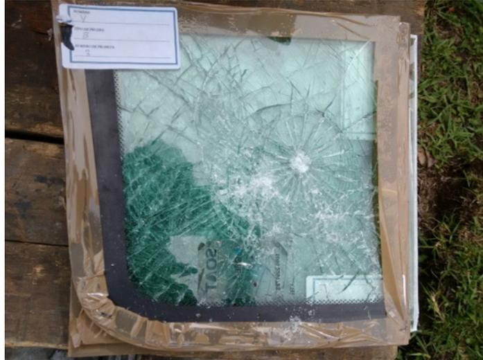
**Figura 3.31:** Probeta número 3 del fabricante Y después de ser impactada.
