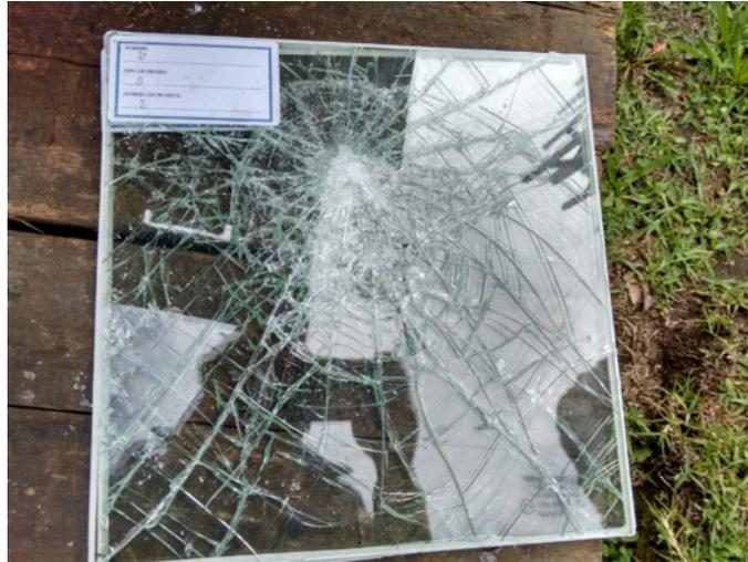
**Figura 3.35:** Probeta número 2 del fabricante Z después de ser impactada.
