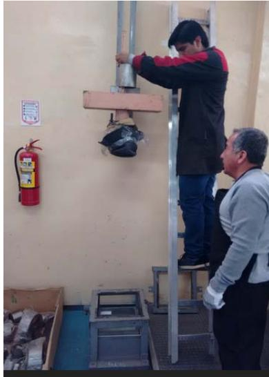
**Figura 3.40:** Regulación de altura para impacto con cabeza de maniquí.
