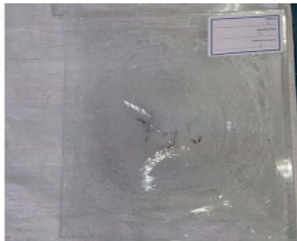
**Figura 3.42:** Impacto con cabeza de maniquí probeta número 2 fabricante X.
