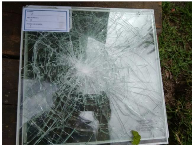
**Figura 3.36:** Probeta número 3 del fabricante Z después de ser impactada.
