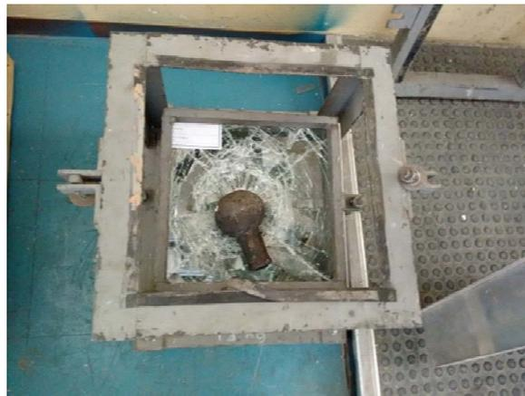
**Figura 3.19:** Impacto con esfera de acero en la probeta del fabricante Z.
