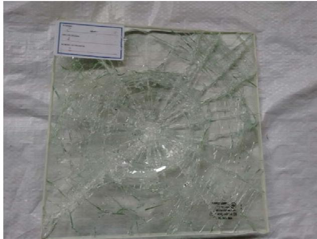
**Figura 3.21:** Probeta número 2 del fabricante Z, después de ser impactada.
