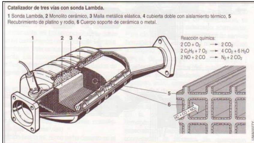
Figura 10. Catalizador de tres vías
