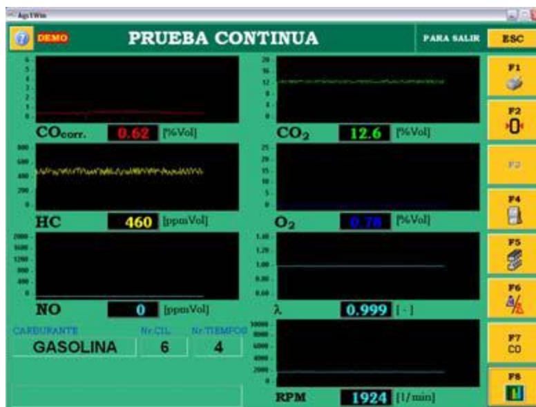
Gráfico 4.13 Analizador de Gases BrainBee AGS-688
