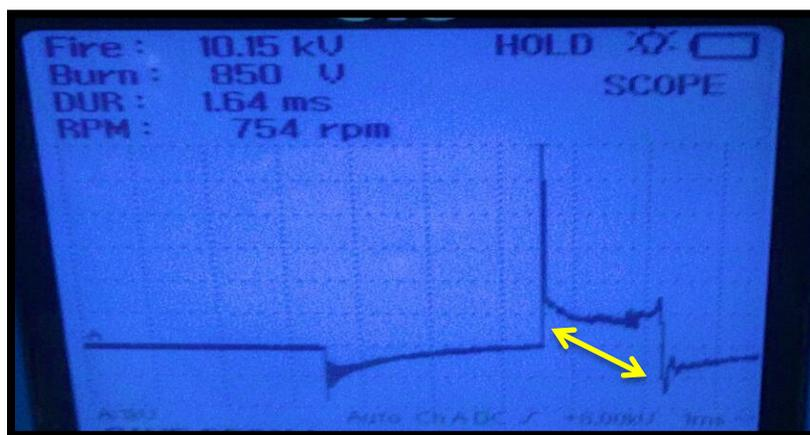
**Figura 44.** Forma de onda con inyector sucio
