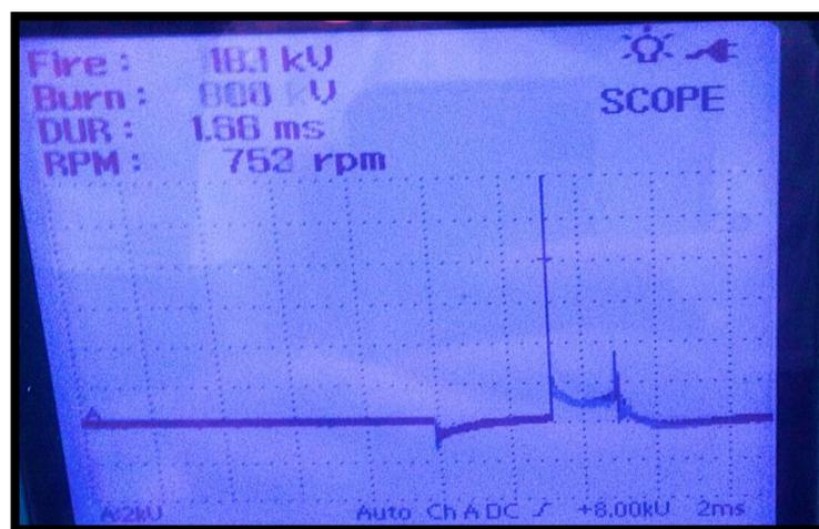
**Figura 43.** Oscilograma con inyector limpió
