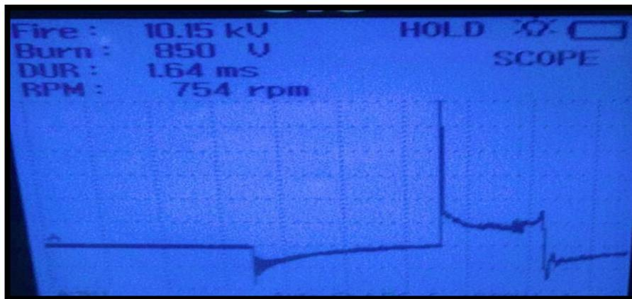
**Figura 38.** Grafica del secundario con los inyectores tapados
