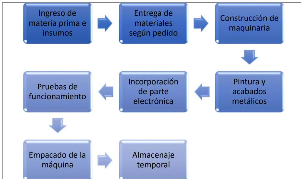
**Figura 57. Proceso de fabricación de maquinaria**
