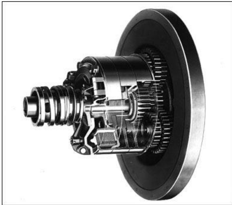
Figura 3. 1 cambio planetario Ford modelo T
