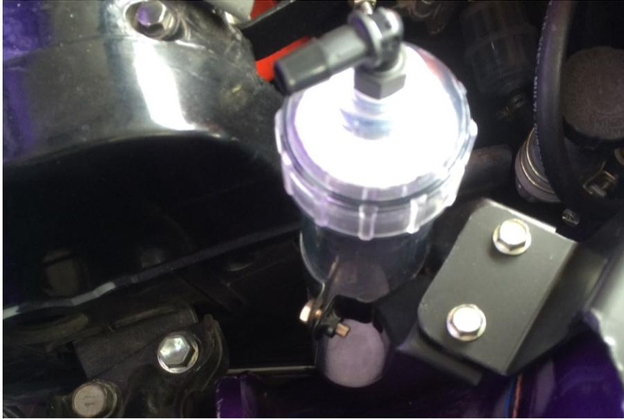
**Figura 4.22** Burbujeador Ensamblado en el Vehículo
