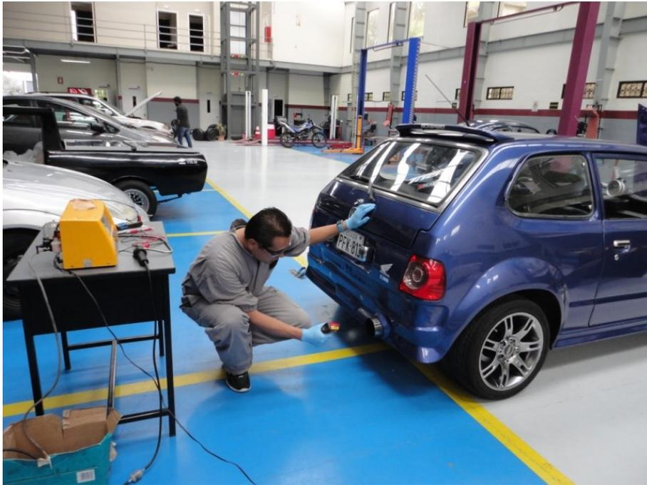
**Figura 5.5** Colocación de analizador en el vehículo
