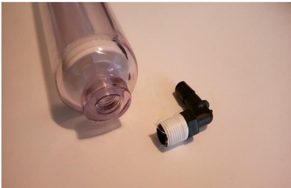
**Figura 4.16** Codo de Sujeción con Teflón
