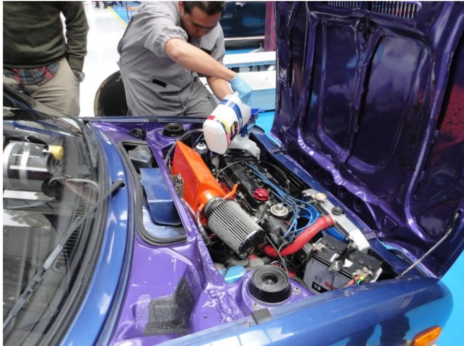
**Figura 4.28** Carga del electrolito en el sistema
