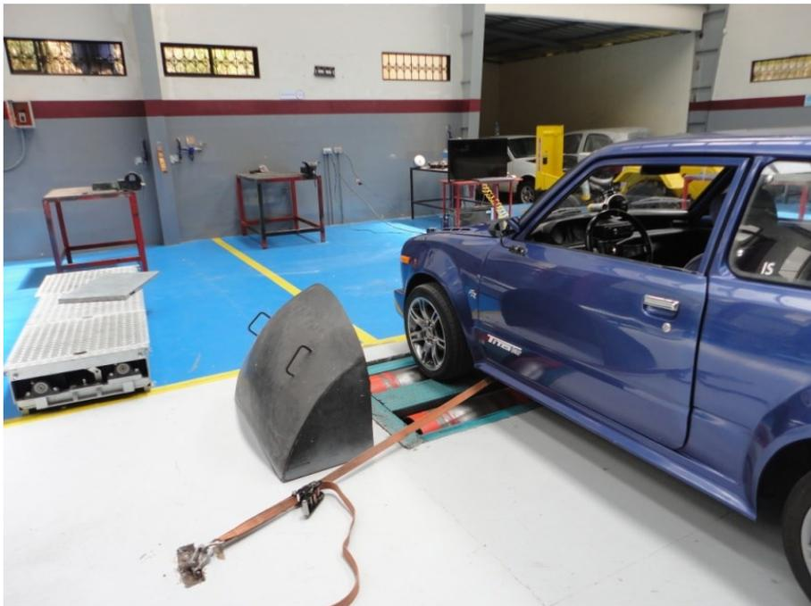
**Figura 5.14** Aseguramiento del lado izquierdo del Vehículo en el Dinamómetro
