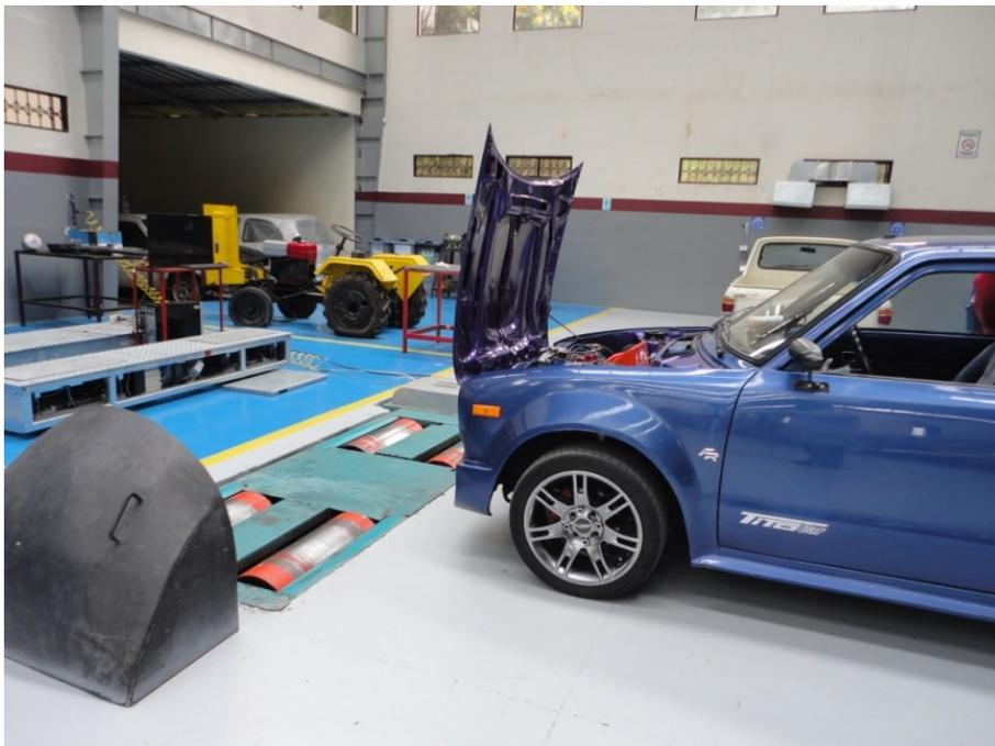
**Figura 5.12** Pre calentamiento del motor antes de la prueba
