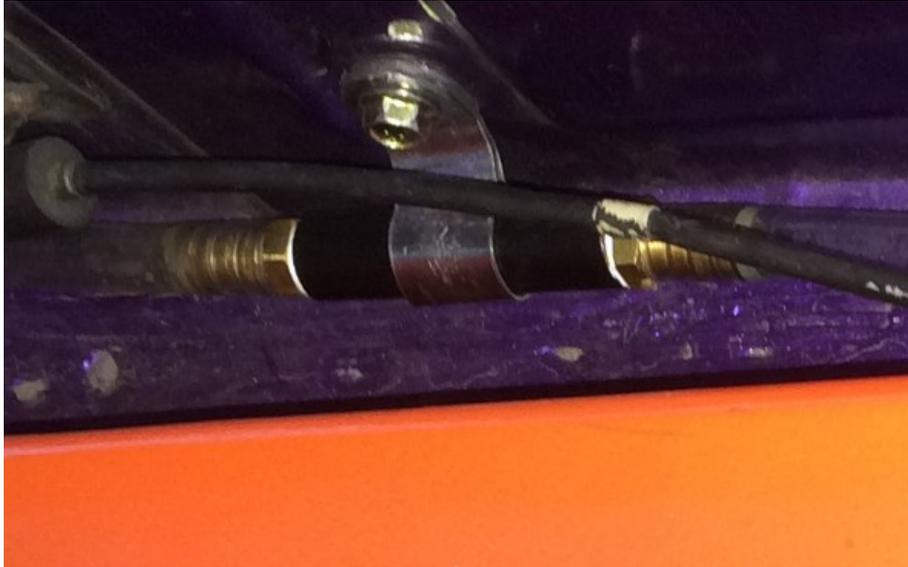
**Figura 4.23** Válvula de Seguridad Ensamblada en el Vehículo
