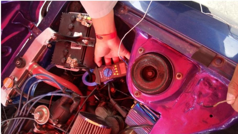
**Figura 5.9** Medición de Corriente en Atacames
