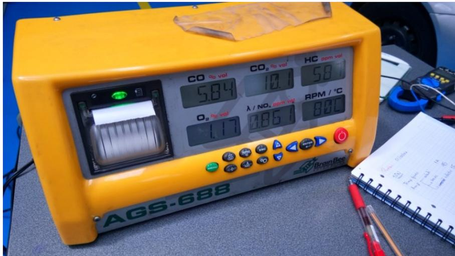
**Figura 5.1** Analizador de Gases (Brain Bee Automotive AGS-688)
