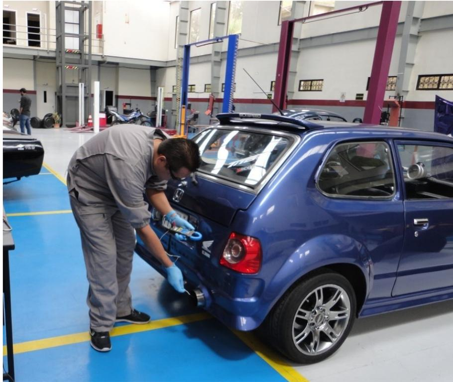
**Figura 5.10** Medición de temperatura de gases de escape en Quito
