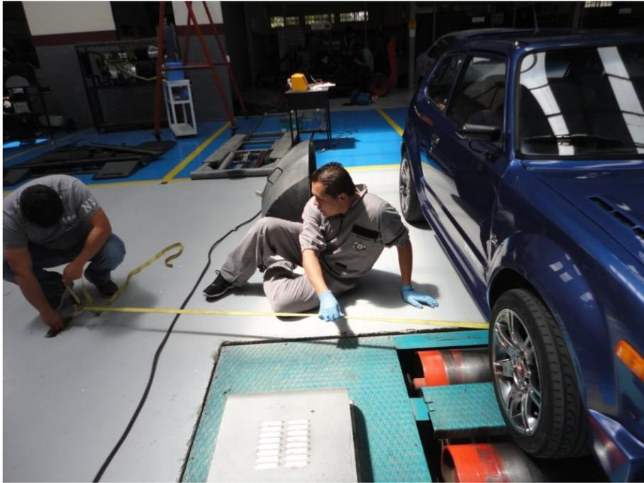
**Figura 5.13** Aseguramiento del lado derecha del Vehículo en el Dinamómetro
