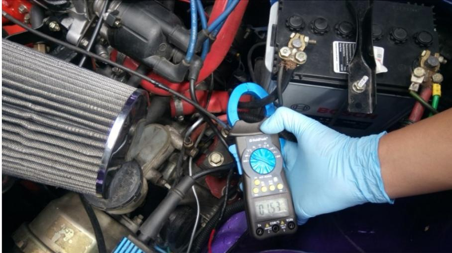
**Figura 5.8** Medición de Corriente en Quito
