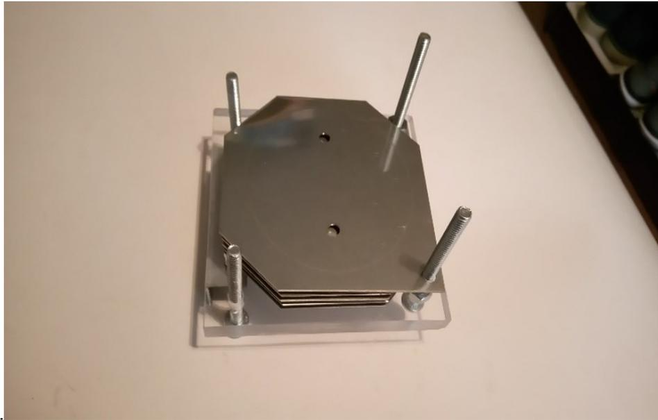
**Figura 4.6** Ensamblaje de las placas neutras
