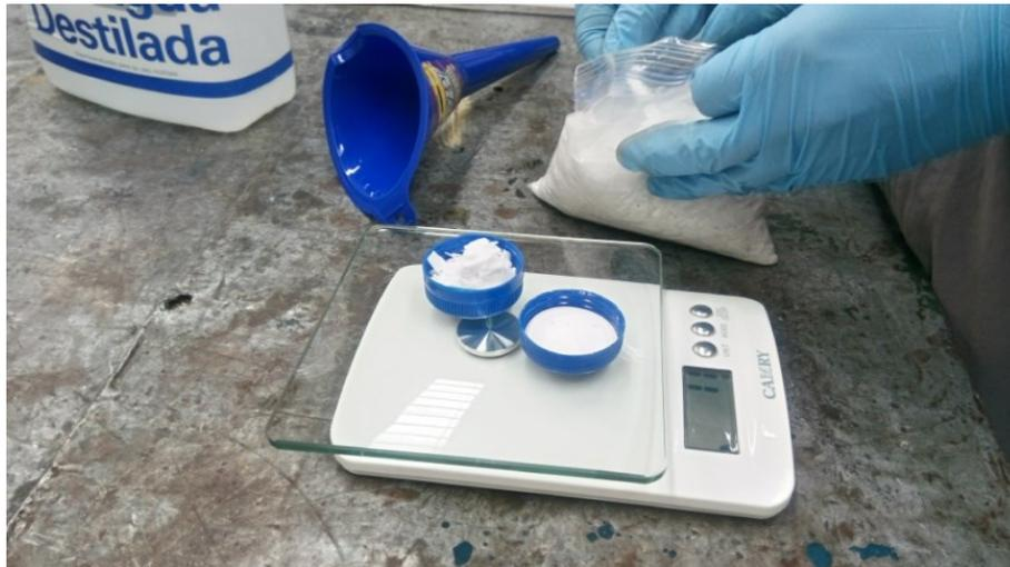
**Figura 4.27** Pesaje del hidróxido de potasio
