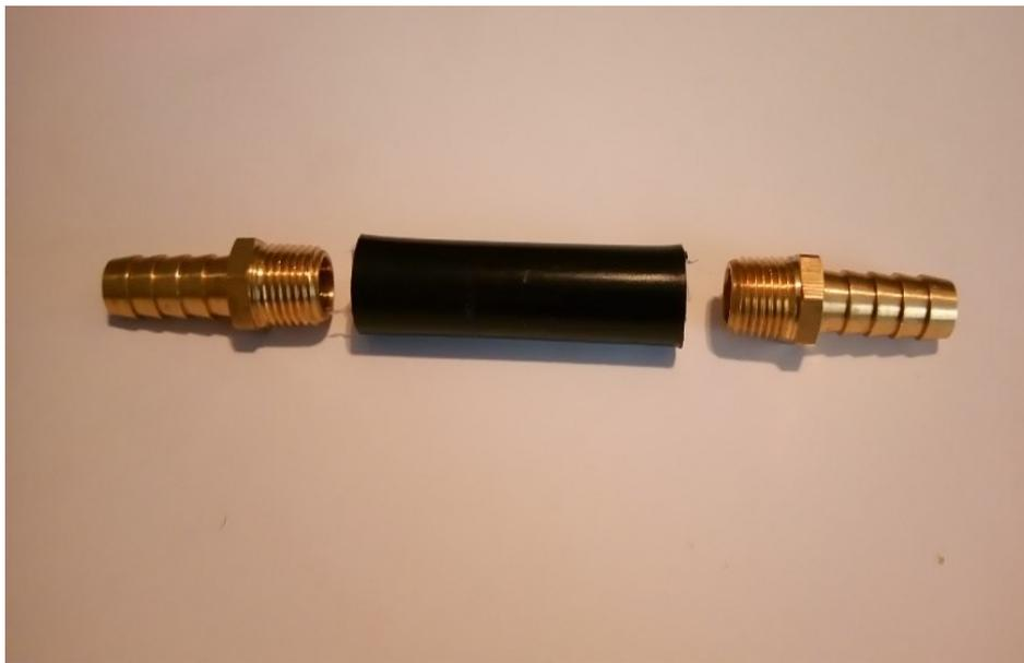
**Figura 4.17** Válvula de Seguridad Desensamblada
