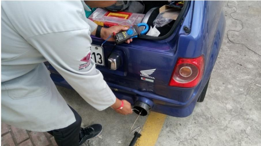
**Figura 5.11** Medición de temperatura de gases de escape en Atacames
