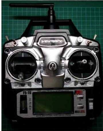
Figura 1.19 Ejemplo de control de seis canales que funciona a una frecuencia de 2.4 GHz
