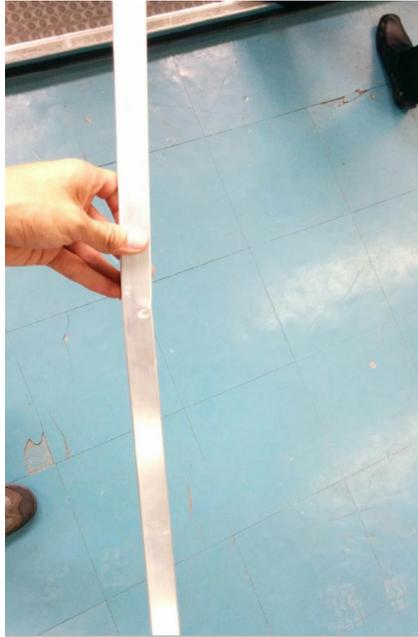
Figura 3.34 Tubo de aluminio deformado después de ensayo de flexión
