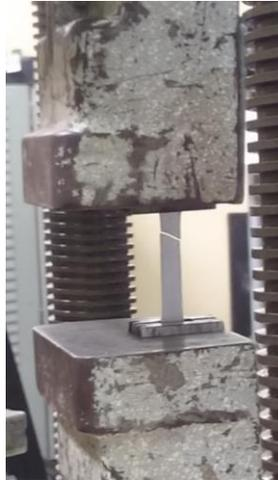
Figura 3.36 Probeta de aluminio rota por ensayo de tracción
