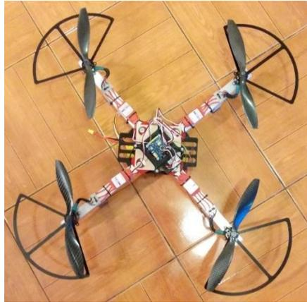
Figura 4.18 Ensamble quadcopter, conexión fuente a ESCs
