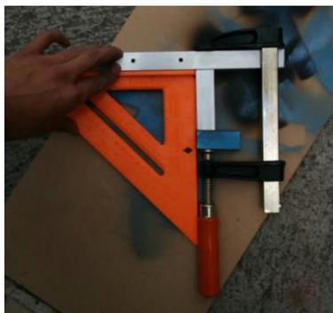
Figura 4.5 Posicionamiento de las piezas cortadas para proceso de suelda
