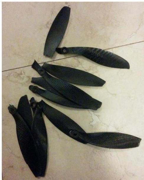
Figura 4.21 Hélices rotas en pruebas de vuelo con diferentes PID
