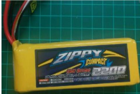
Figura 3.47 Batería Zippy Compact de 2200mAh a 11,1 Voltios
