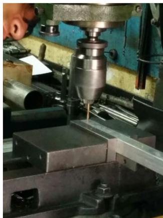
Figura 4.4 Perforación de las piezas de 250mm
