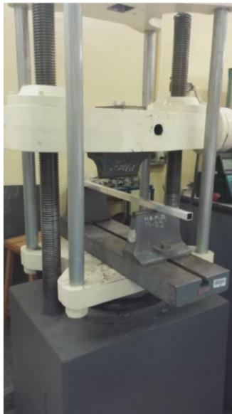
Figura 3.33 Ensayo de flexión, tubo de aluminio
