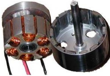
Figura 1.14 Rotor y estator de un motor brushless
