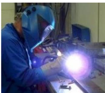
Figura 4.6 Proceso de soldadura TIG en aluminio
