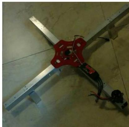
Figura 4.17 ensamblaje de motores y variadores de velocidad ESC, previo al ensamblaje mecánico
