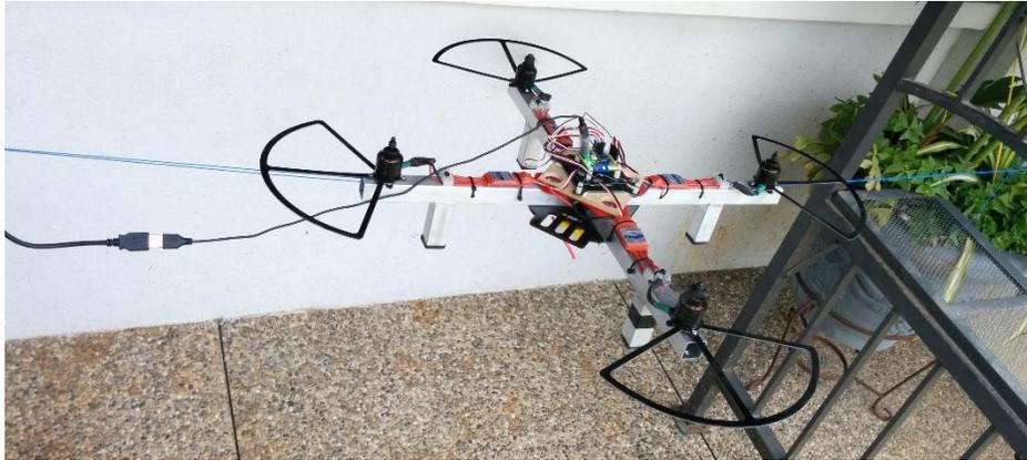
Figura 4.19 Montaje del quadcopter para calibración
