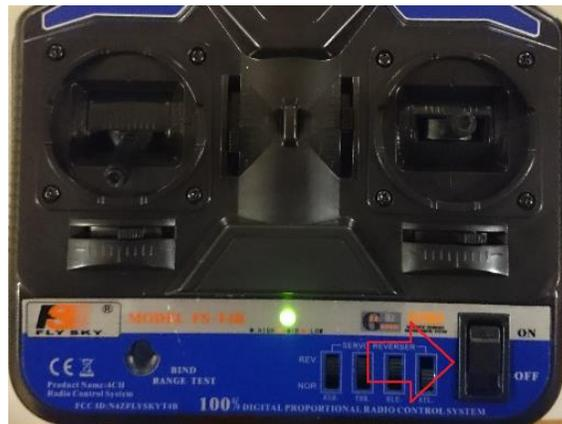
Figura 3.56 Ubicación del switch de encendido en el radio control
