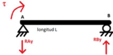
Figura 3.4 Diagrama de fuerzas para el soporte
