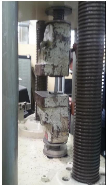
Figura 3.35 Probeta de aluminio, ensayo de tracción
