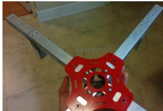
Figura 4.9 Estructura mecánica con solo una unión pernada
