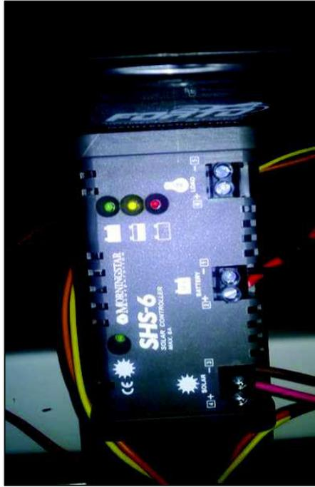
**Figura 6.19 Controlador de carga.**
