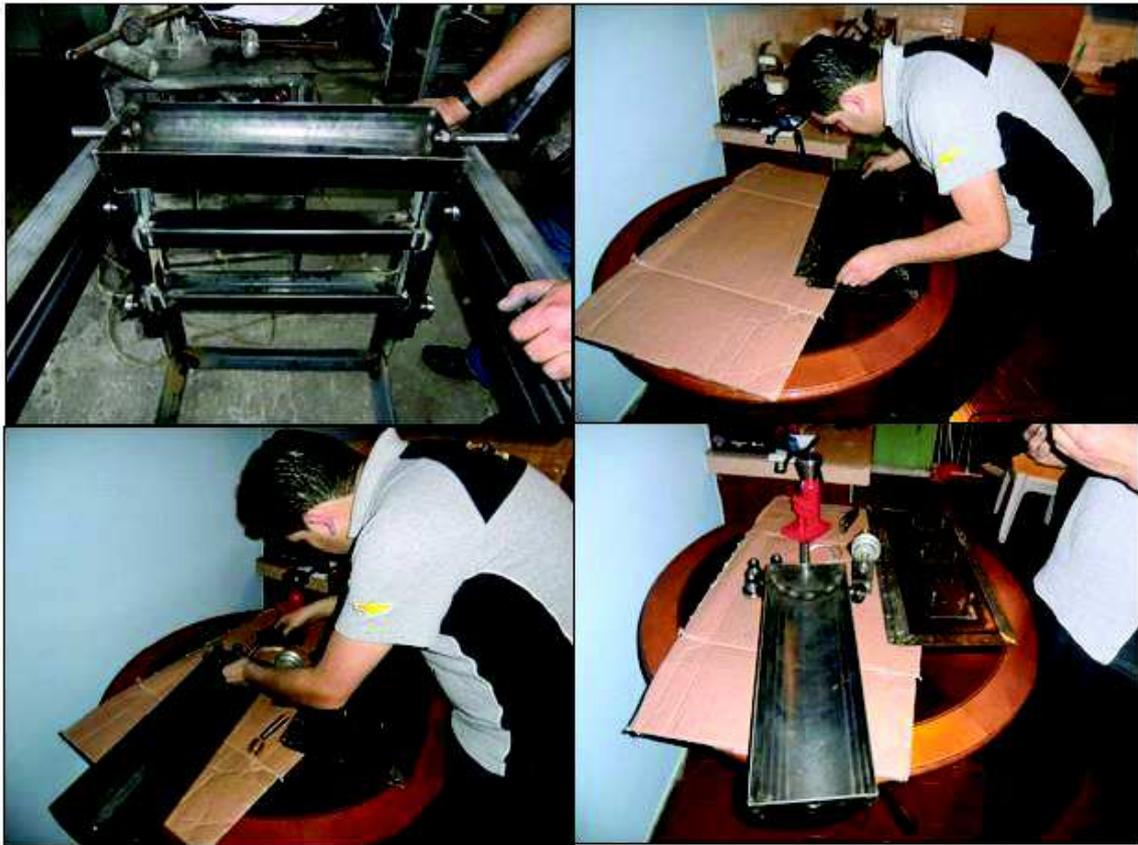
**Figura 6.4** Proceso de armado tapa y recipiente de botellas.
