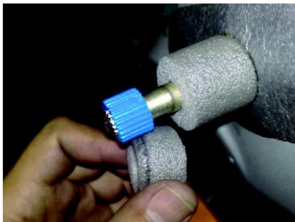
**Figura 6.12 Sistema de adaptación del motor de elevador de vidrios**
