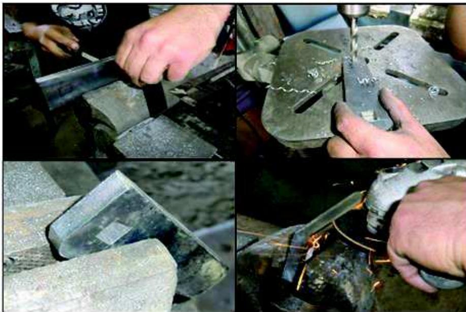
**Figura 6.7 Fabricación de la palanca lateral**
