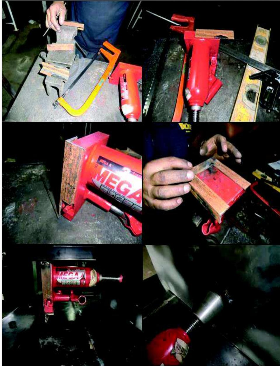
**Figura 6.15 Adaptación e instalación de una gata hidráulica**
