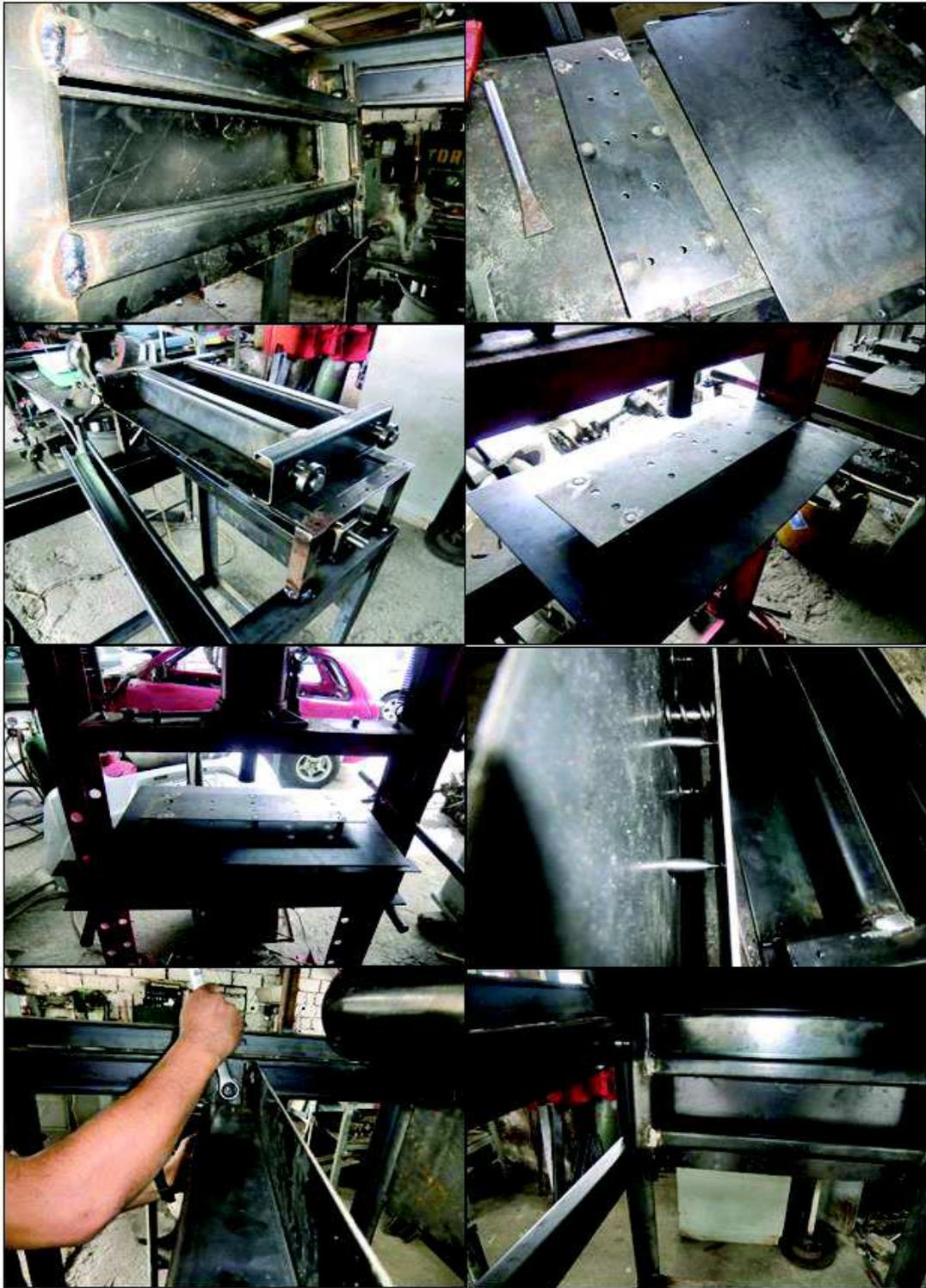
**Figura 6.13** Fabricación de la placa de compactación
