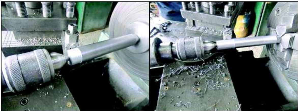
**Figura 6.6 Fabricación de los pernos laterales en el torno (3)**
