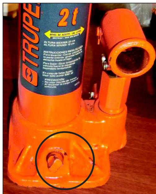
**Figura 6.10** Válvula de cerrado y apertura hidráulica de la gata
