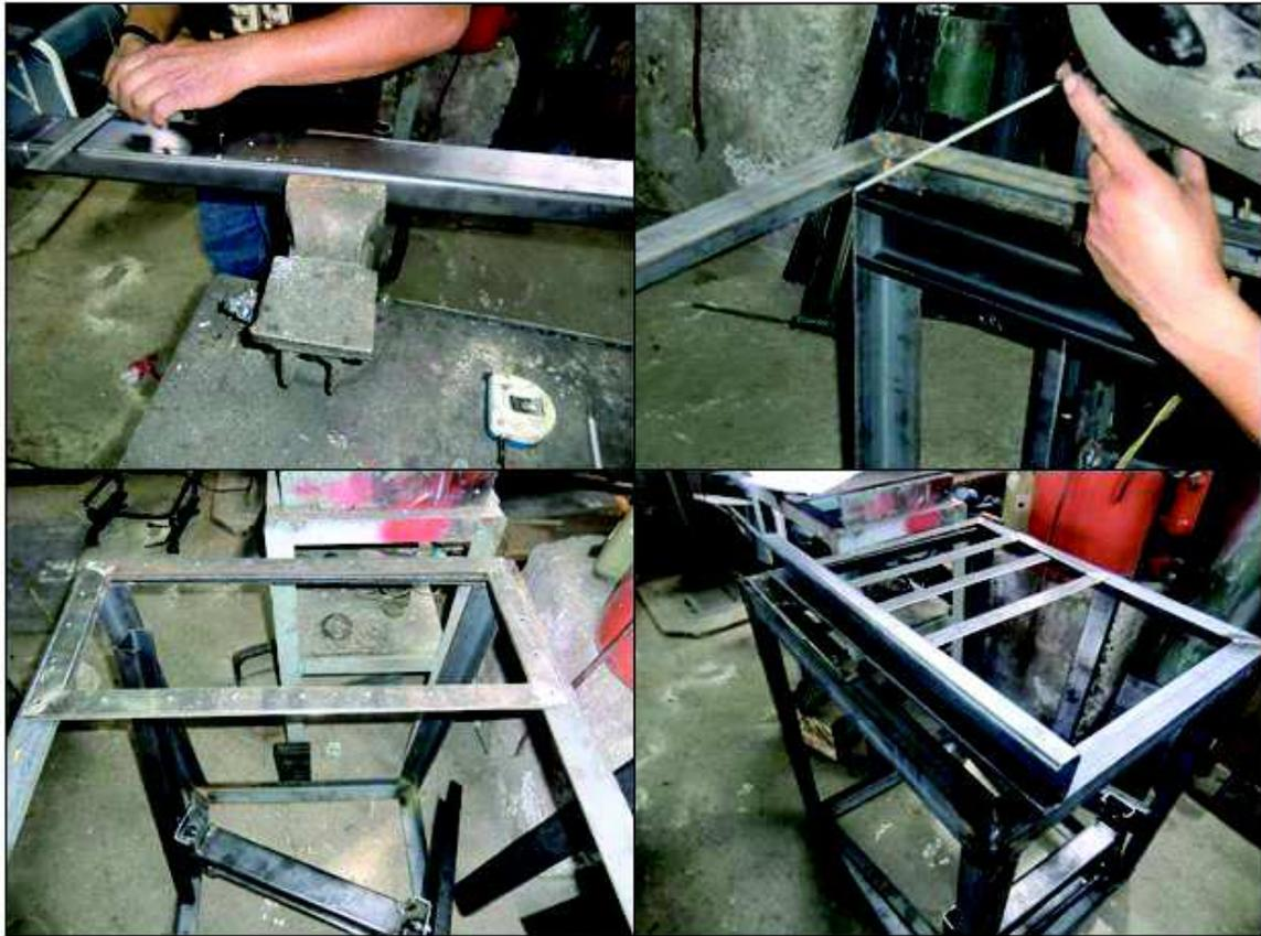
**Figura 6.3 Procesos de armado de las correas (4)**
