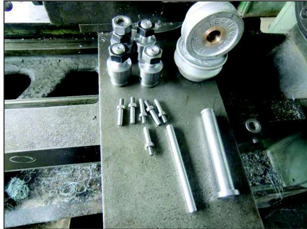
**Figura 6.5 Fabricación de los pernos laterales en el torno.**
