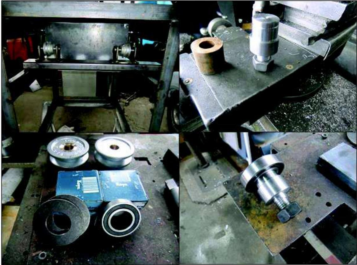
**Figura 6.14 Fabricación de los rieles y ejes de base**
